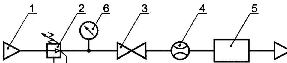
1 — система сжатого воздуха (точка отбора проб); 2 — регулятор давления; 3 — игольчатый клапан;
