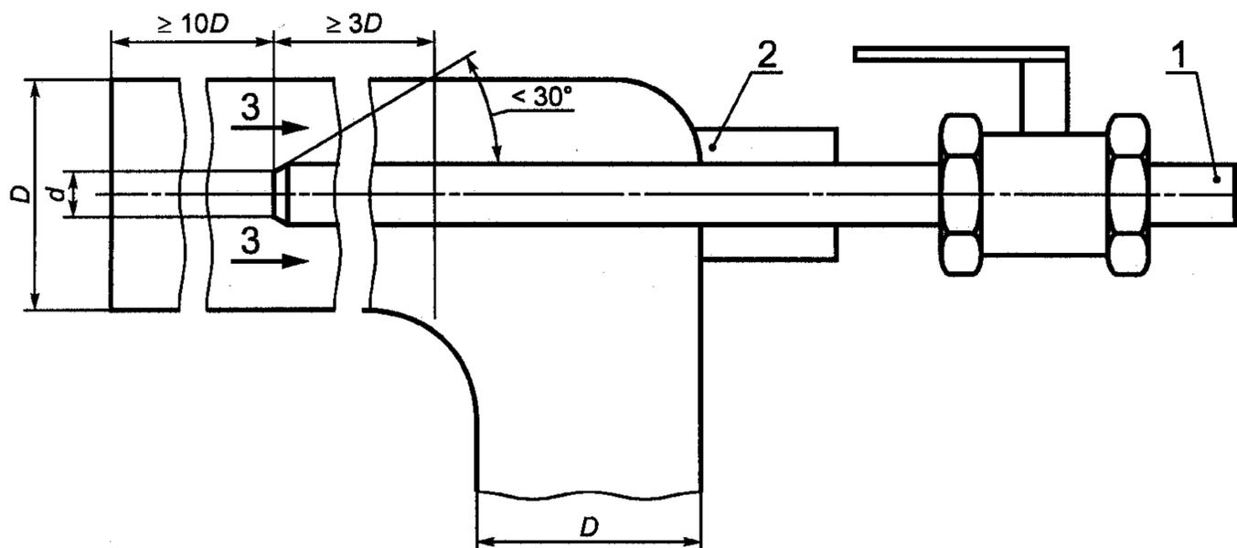
1 — пробоотборник в основном трубопроводе; 2 — муфта для регулирования пробоотборника при установке; 3 — направление потока воздуха;  $D$  — диаметр основного трубопровода;  $10D$  — минимальный прямой участок трубопровода до пробоотборника;  $3D$  — минимальный прямой участок трубопровода после пробоотборника;  $d$  — внутренний диаметр пробоотборника
