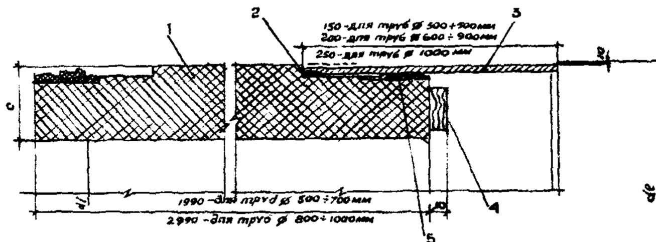
**Рис.3. Стыковое соединение полимербетонных труб:**
