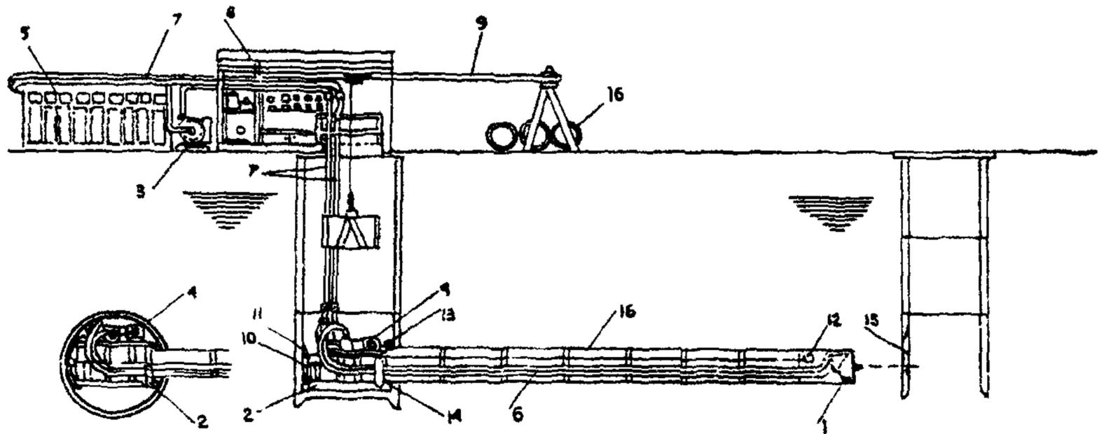
**Рис.10. Конструкторско-технологическая схема МТПК 2-го вида (фирма "Херренкнехт") с гидротранспортировкой разработанной породы:**
