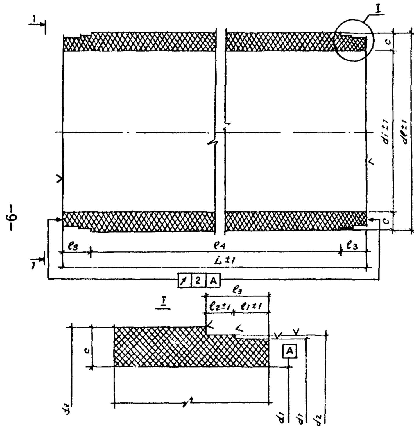
Шероховатость обрабатываемых поверхностей  $Ra < 0,06$  мм
