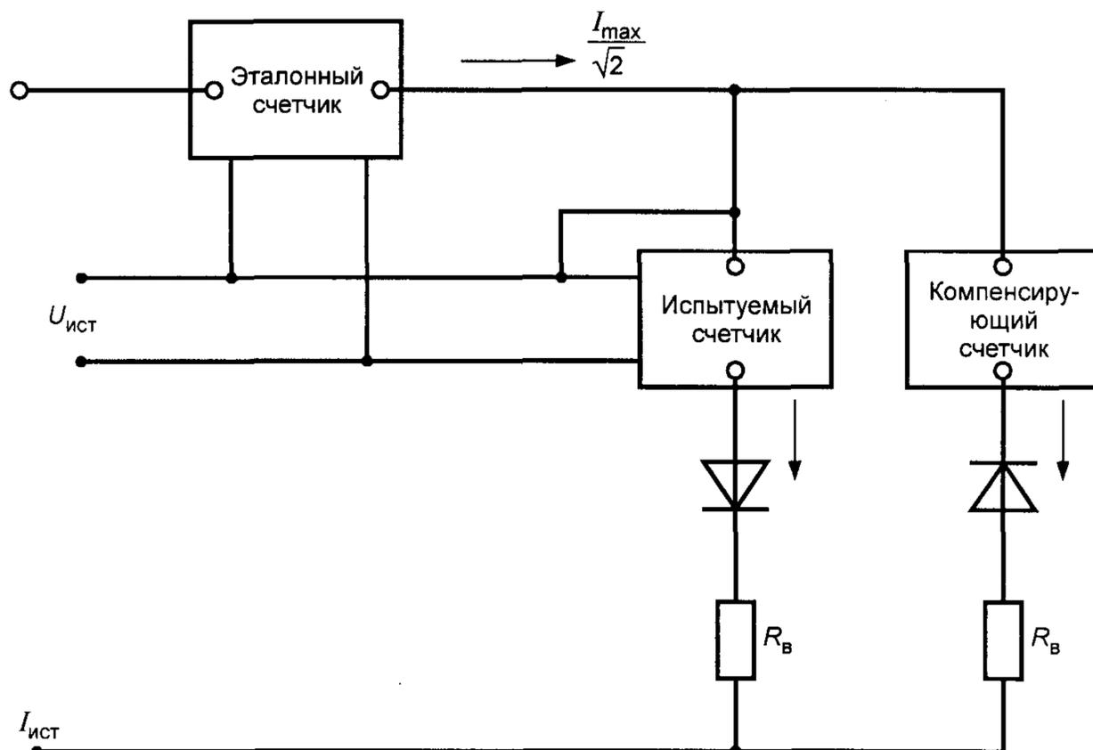
Рисунок А.1 — Схема испытательной цепи для однополупериодного выпрямления
