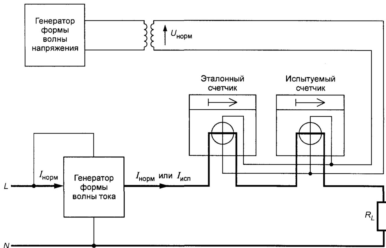
Рисунок А.4 — Схема испытательной цепи (справочная)
