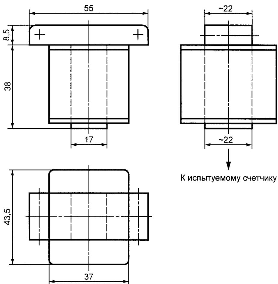
Примеры обмотки: 500 витков проволоки диаметром 0,6 мм, сечением 0,28 мм<sup>2</sup> или 1000 витков проволоки диаметром 0,4 мм, сечением 0,126 мм<sup>2</sup>. Удельные потери 1 Вт/кг.
