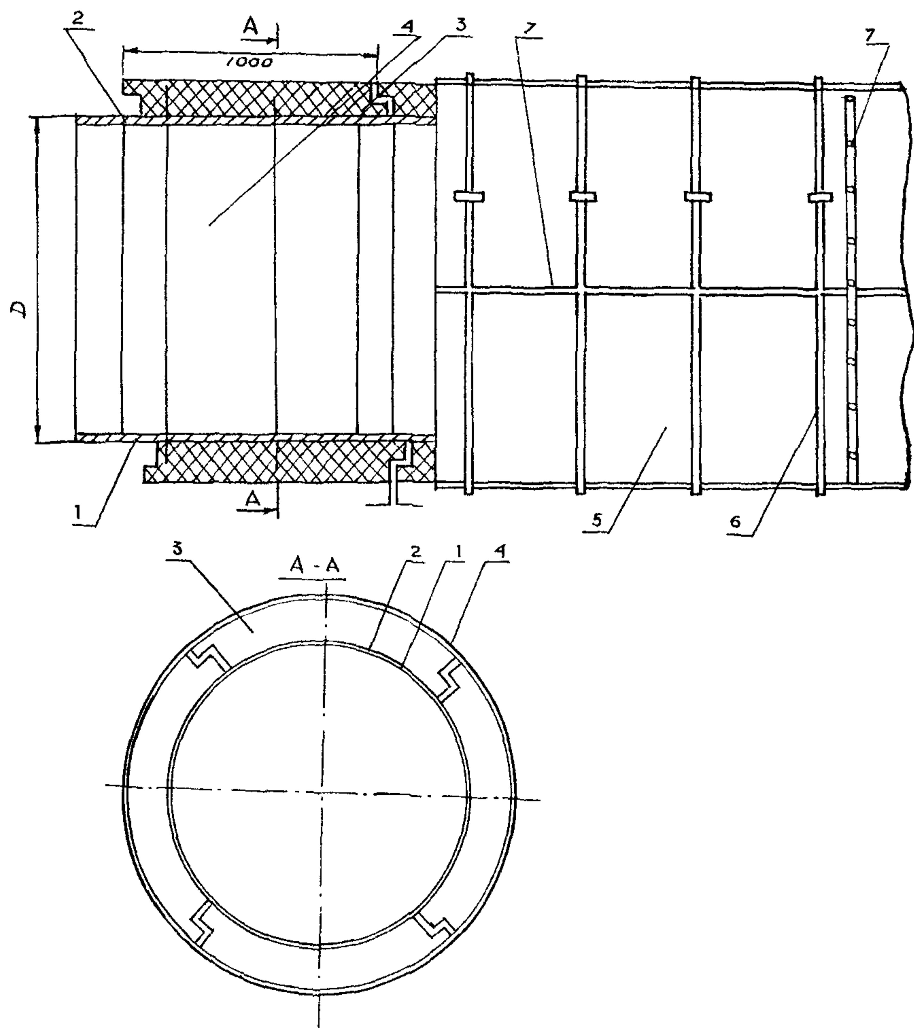
Рис. 1. Конструкция теплоизоляции труб диаметром 1020-1420 мм для непроходных каналов
