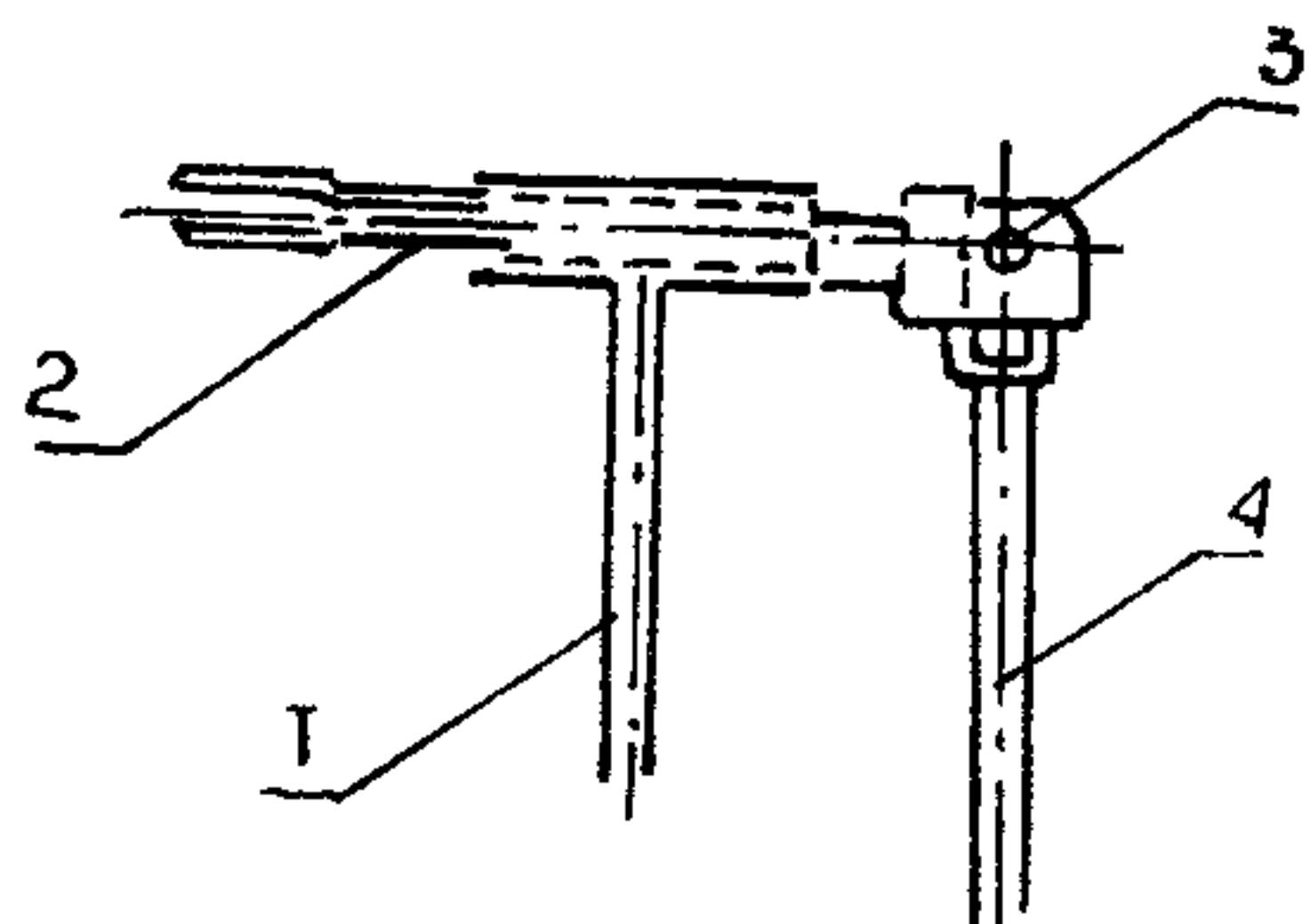
Рис. 2. Ключ для затяжки бандажа:
