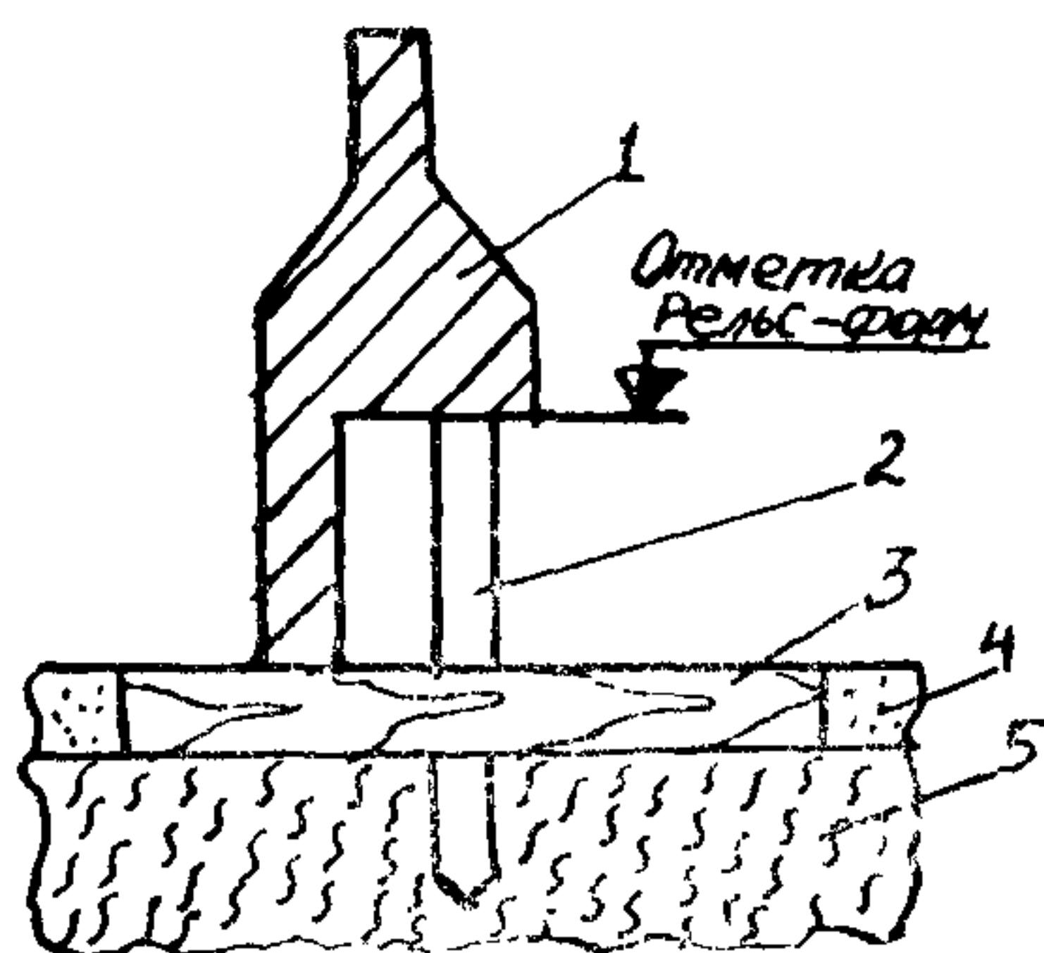
Рис. 2. Шаблон для установки подкладок под рельс-формы:
