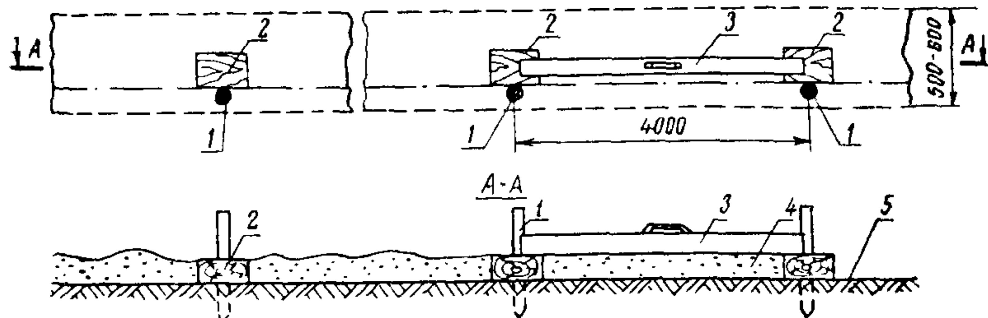
Рис. 3. Подготовка основания для установки рельс-форм:
