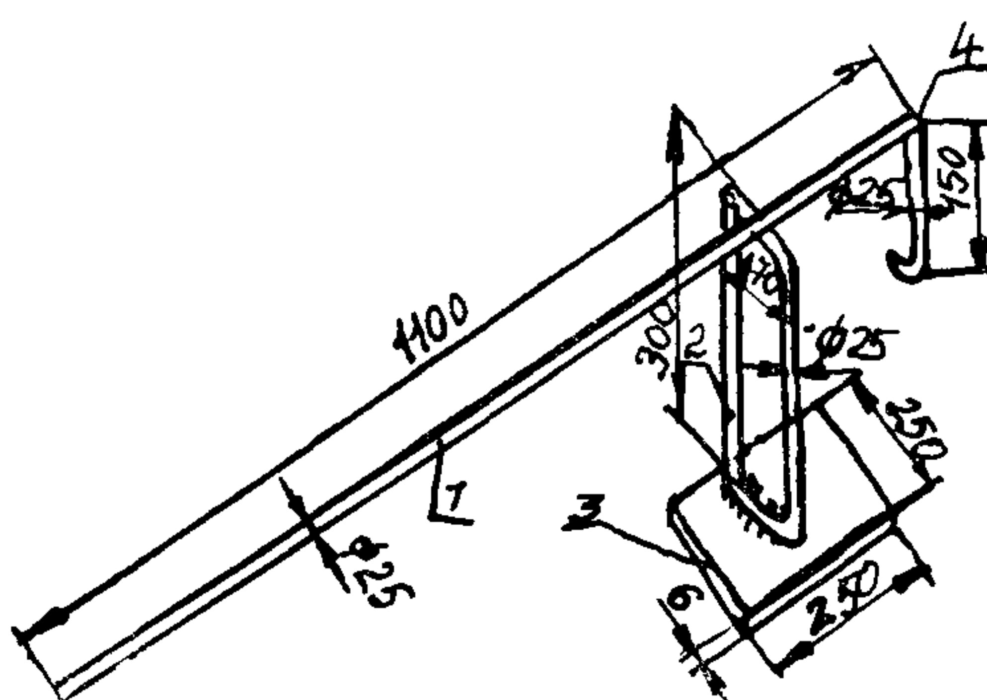
Рис. 4. Приспособление для подъема
