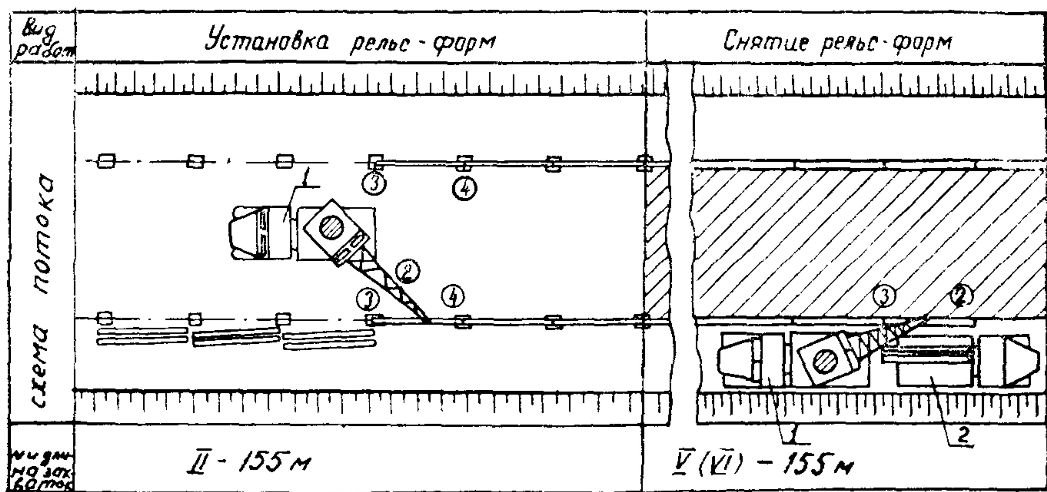
Рис. 1. Технологическая схема установки и снятия рельс-форм:
