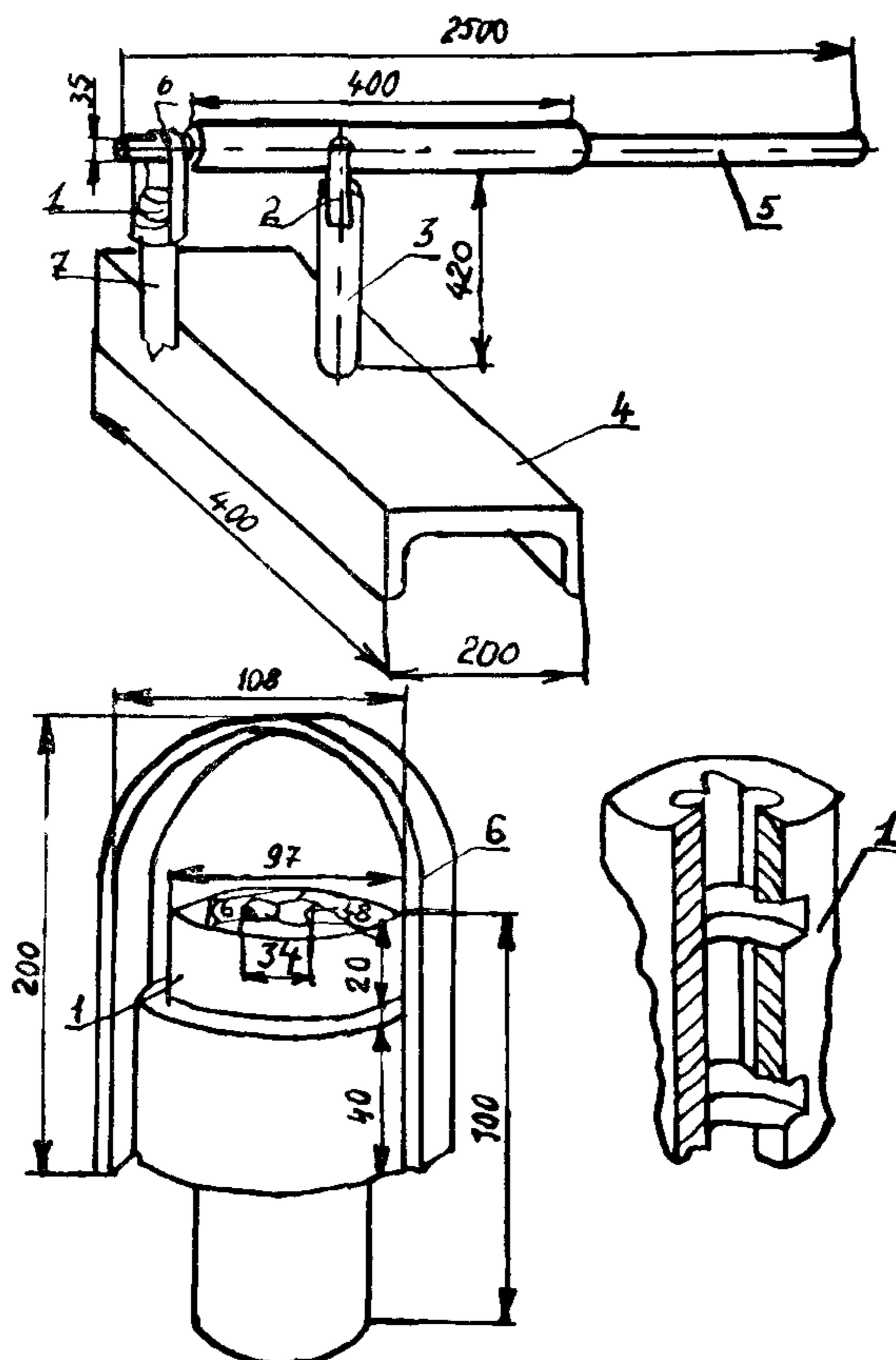
Рис. 5. Приспособление для выдергивания
