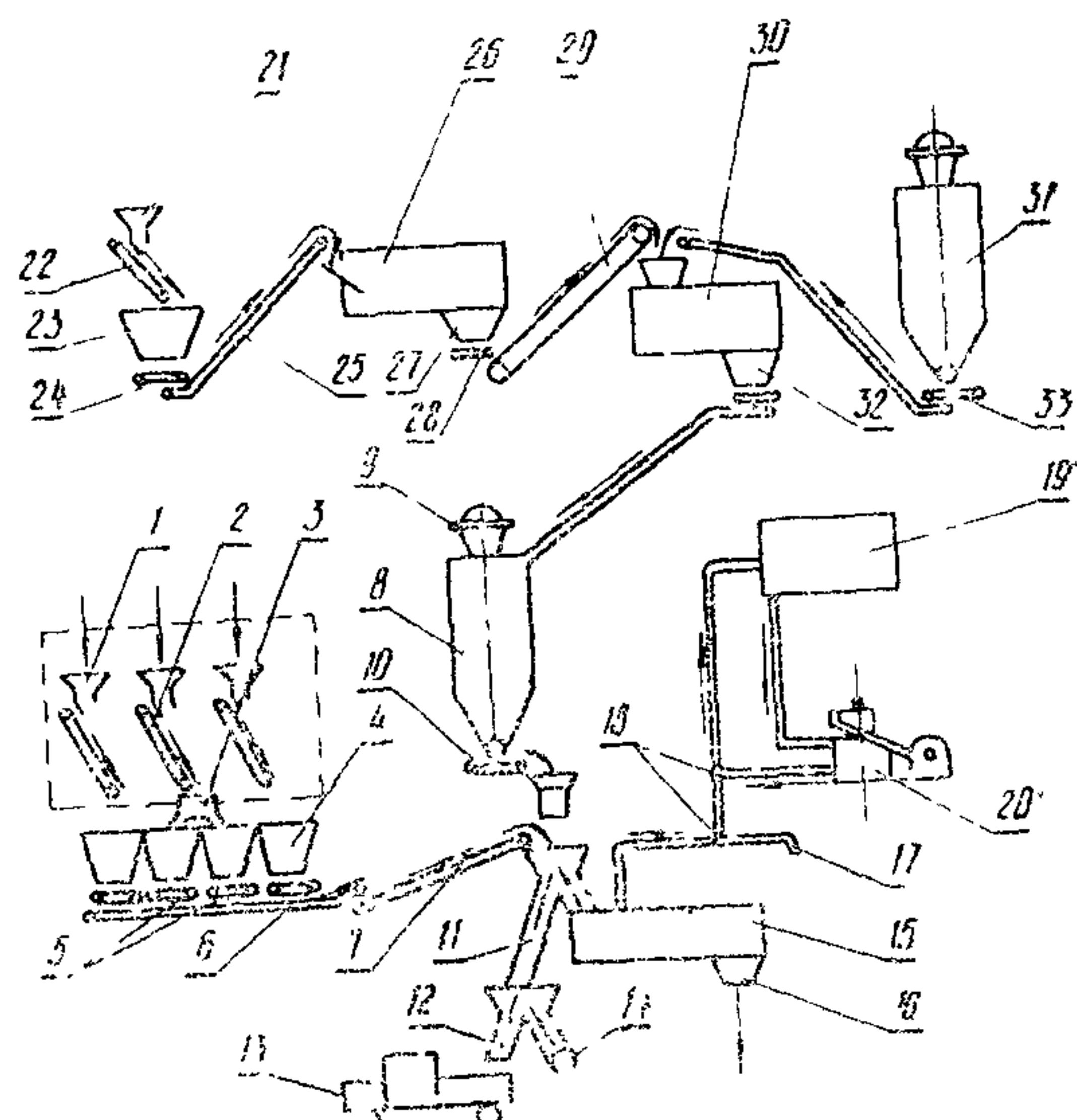
Схема автоматизированного цементобетонного завода со смесительной установкой СБ-78 и дополнительно установленными сушильным барабаном и шаровой мельницей:
