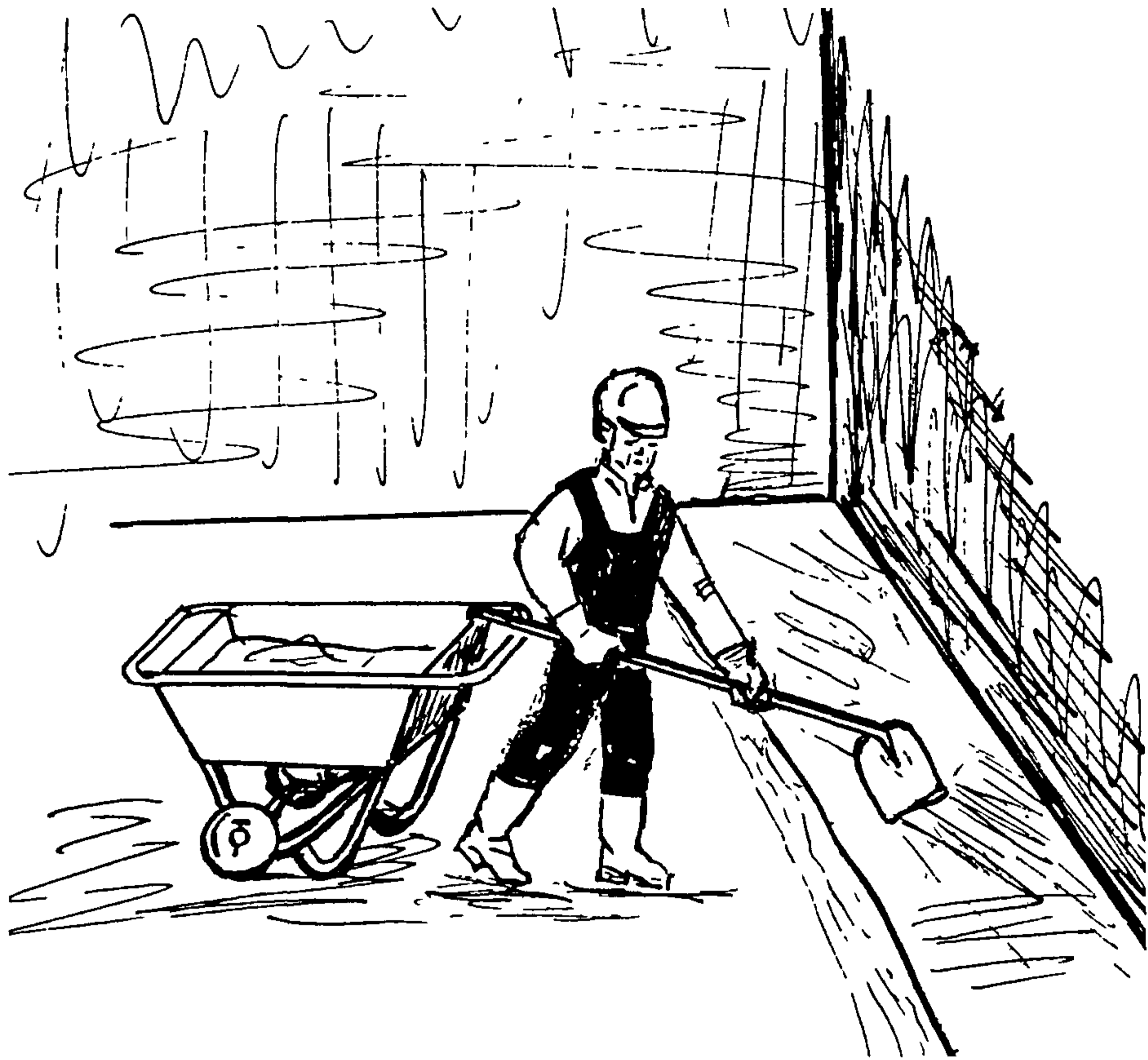
Рисунок 11 – Укладка раствора под мраморные плиты
