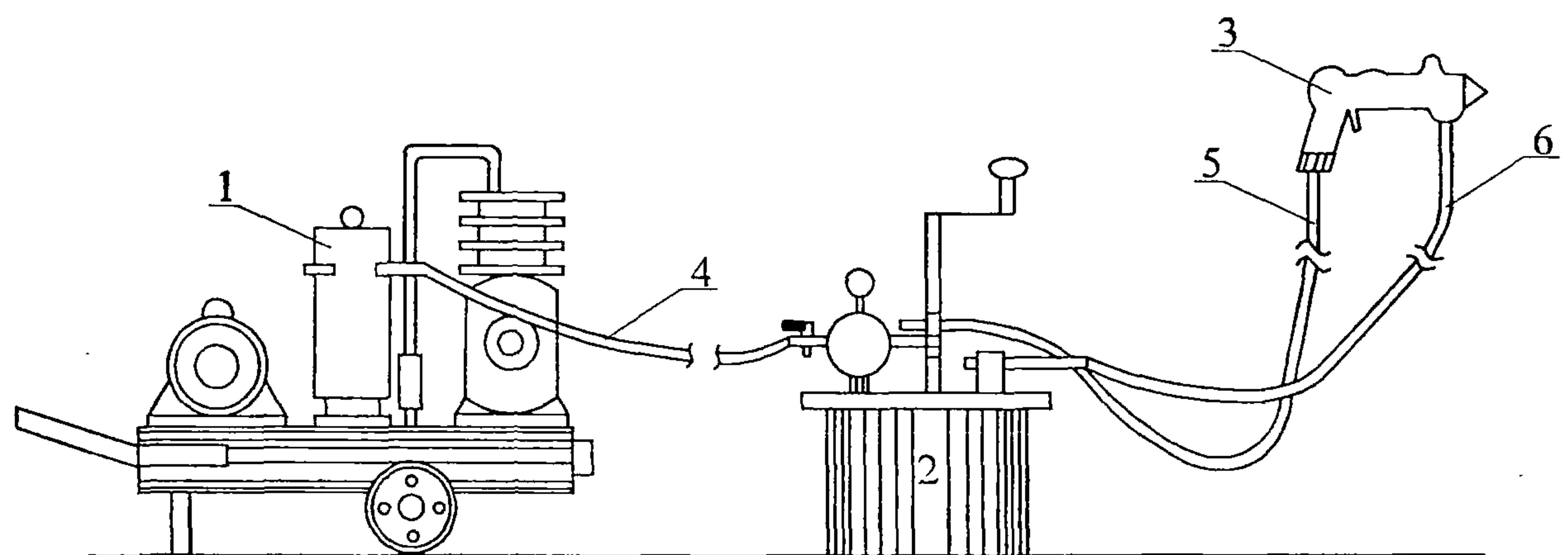
**Рисунок 1 - Схема расположения окрасочных механизмов**
