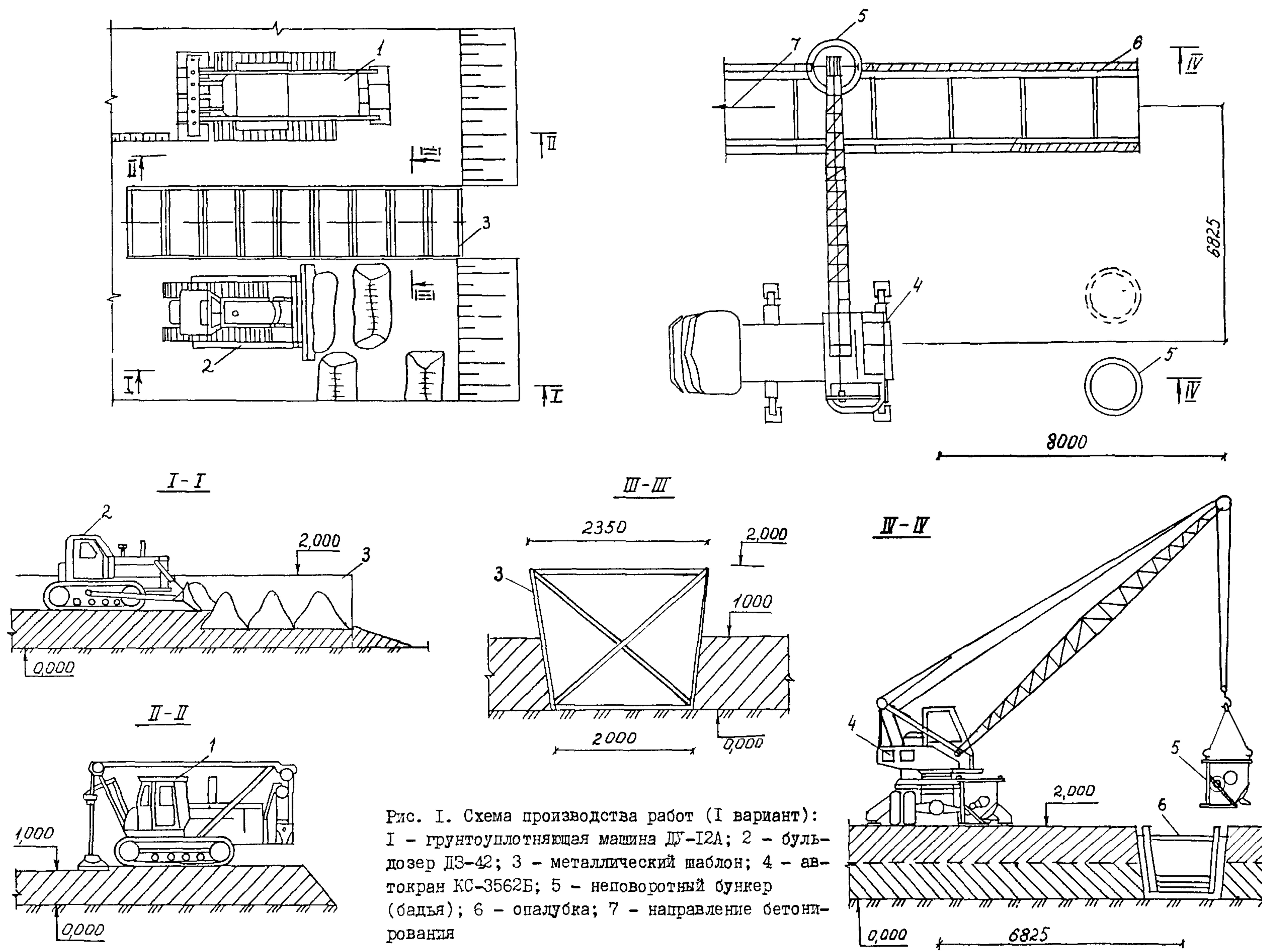
Рис. I. Схема производства работ (I вариант):
