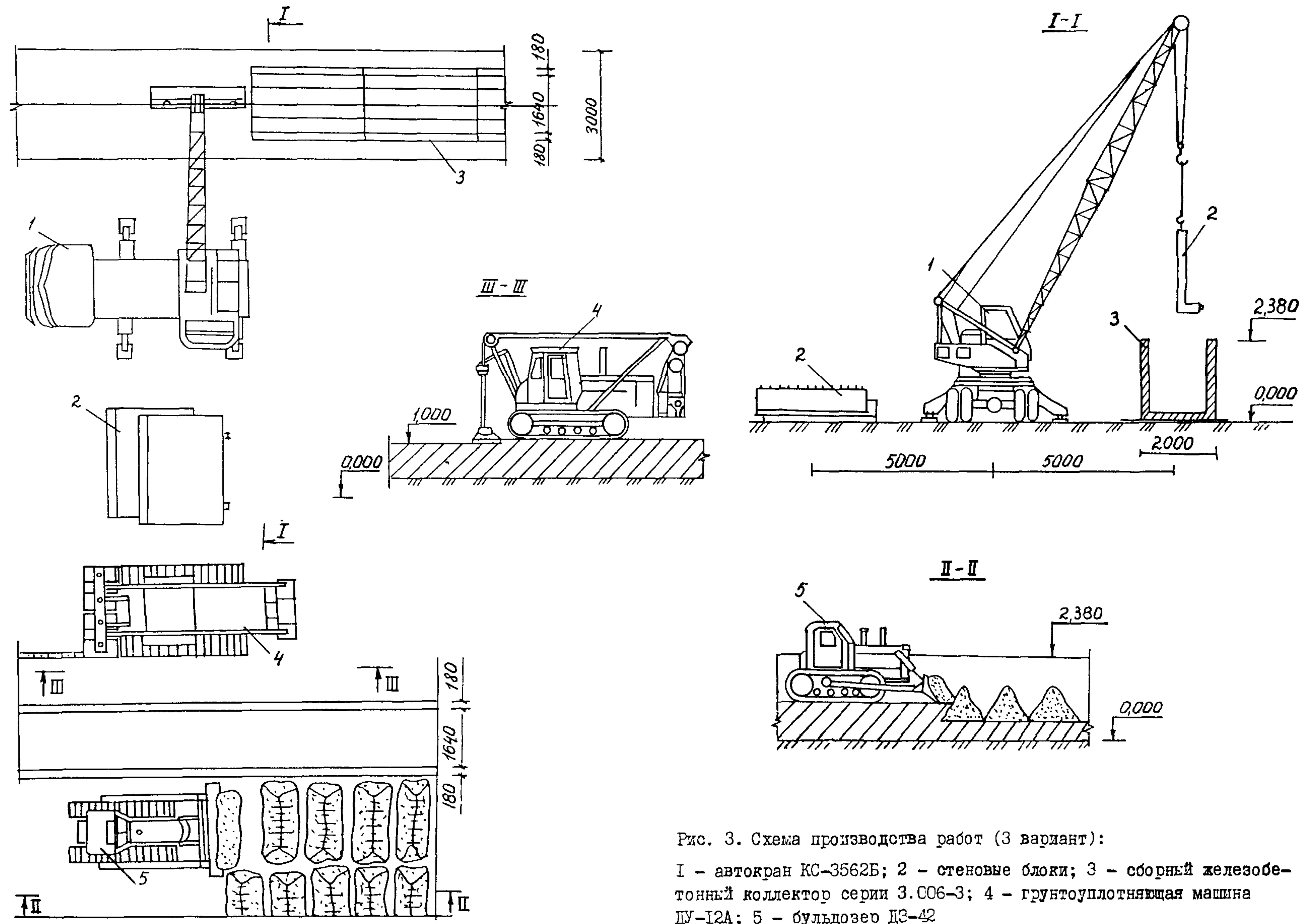
Рис. 3. Схема производства работ (3 вариант):
