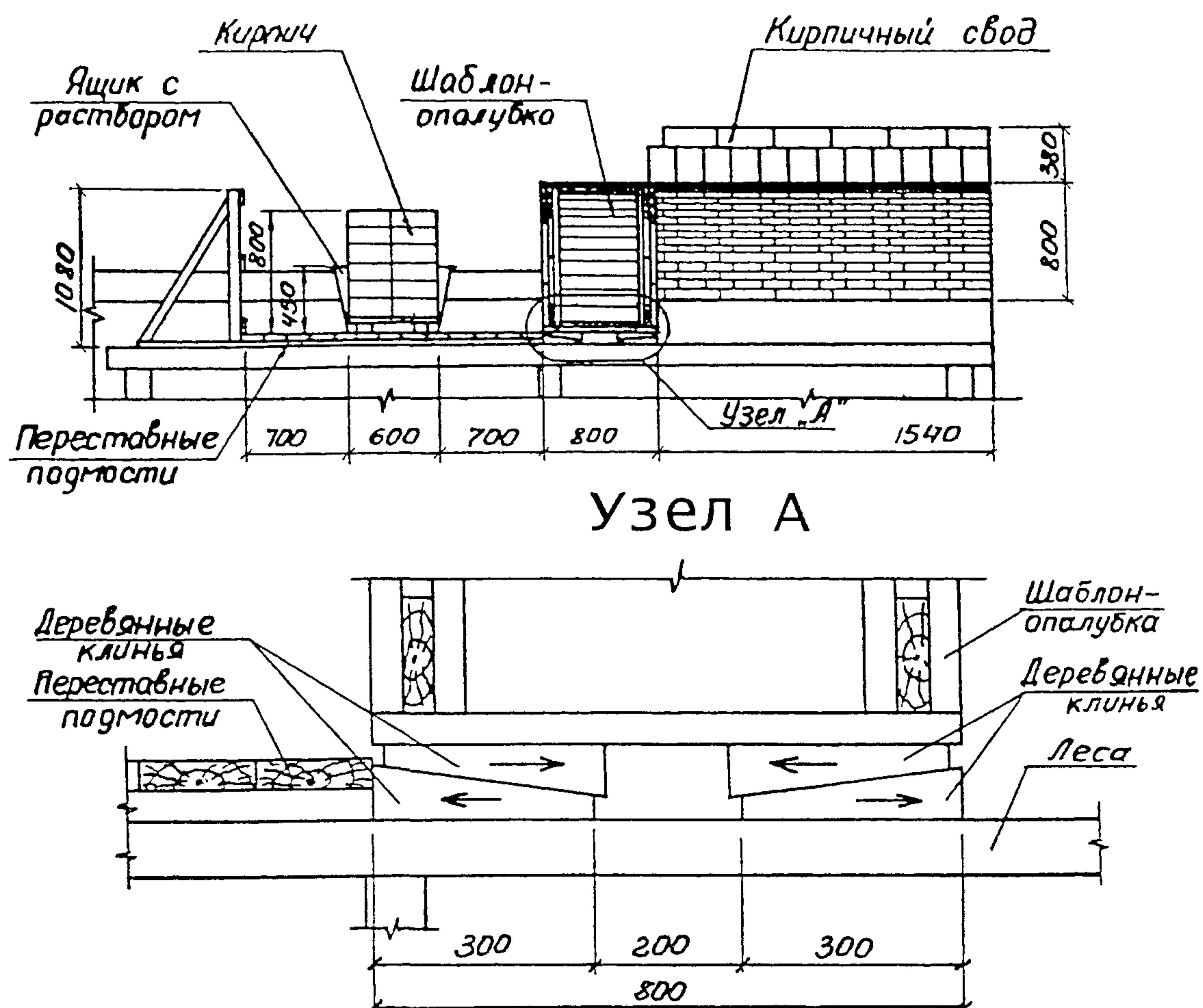
Рисунок 6 – Схема установки и демонтажа шаблона-опалубки
