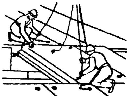
По команде монтажника М<sub>1</sub> машинист крана ослабляет натяжение стропа, а монтажники расстроповывают лестничную площадку
