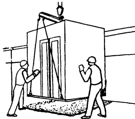
5 ВЪВЕРКА И РАССТРОПОВКА КАБИНЫ; 4,5 мин;  $M, M_1, M_2$ ; пом, отвес-рейка, лопата
