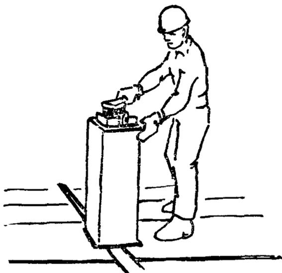
Монтажник  $M_3$  при помощи молотка-кирочки и стальной щетки очищает оголовок смонтированной (нижестоящей) колонны от грязи, наледи и ржавчины. Монтажник  $M_1$  при необходимости подносит стальные подкладки и укладывает их на оголовок колонны до проектной отметки
