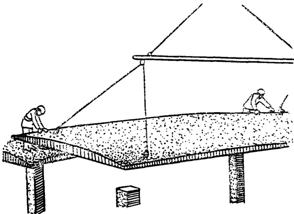
Монтажники  $M_1$  и  $M_2$ , находясь на перекрытии (или на уложенной ранее оболочке), принимают оболочку на высоте 20–30 см от опорной поверхности и направляют ее на место укладки. Затем по команде монтажника  $M_1$  машинист крана плавно опускает оболочку на ригель рамы и две колонны (при установке маячной оболочки) или на четыре колонны (при установке рядовой оболочки) вплотную к фиксаторам колонн, а монтажники следят за совмещением оболочки с рисками
