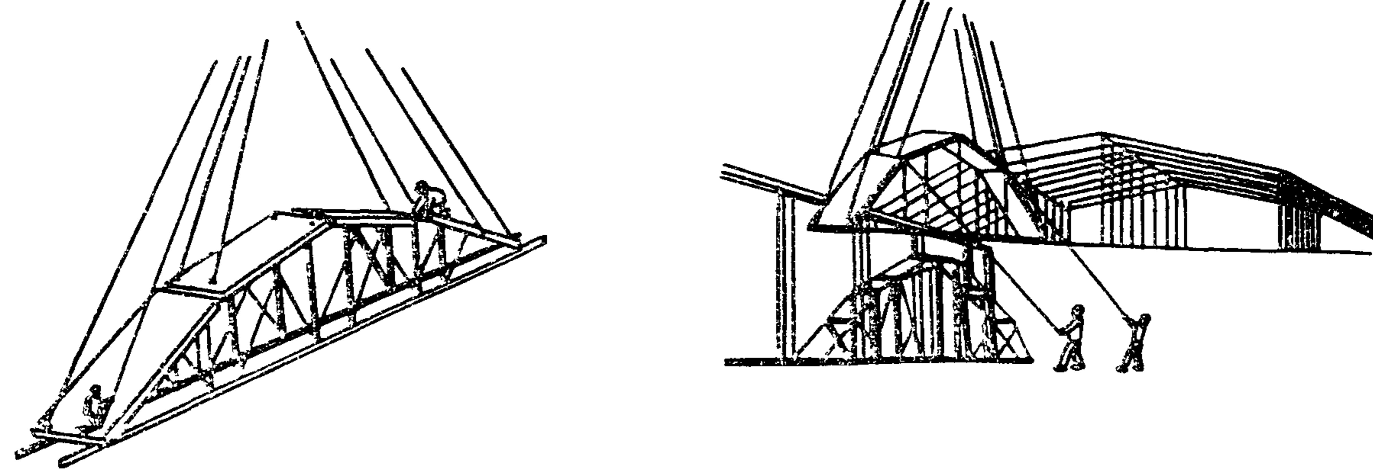
Монтажники  $M_3$  и  $M_4$  строят двумя четырехветвевыми стропами собранную секцию свода, затем к монтажным петлям привязывают две оттяжки. После этого монтажник  $M_3$  подает машинисту крана сигнал поднять секцию свода. При подъеме секции свода монтажники  $M_3$  и  $M_4$  удерживают ее от раскачивания пеньковыми оттяжками
