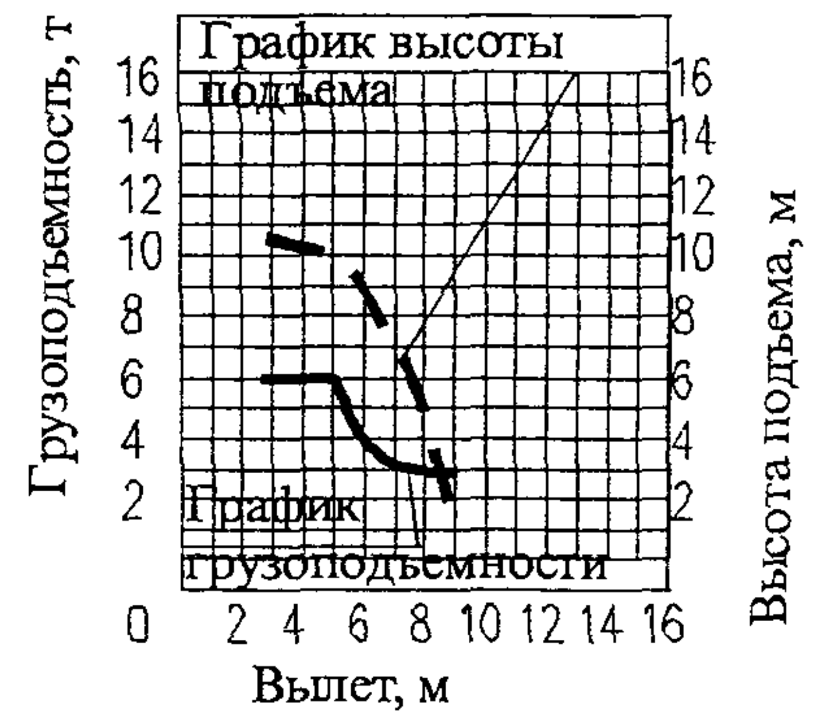
График грузоподъемности и высоты подъема для крана KC-3571, Lстр.= 10м
