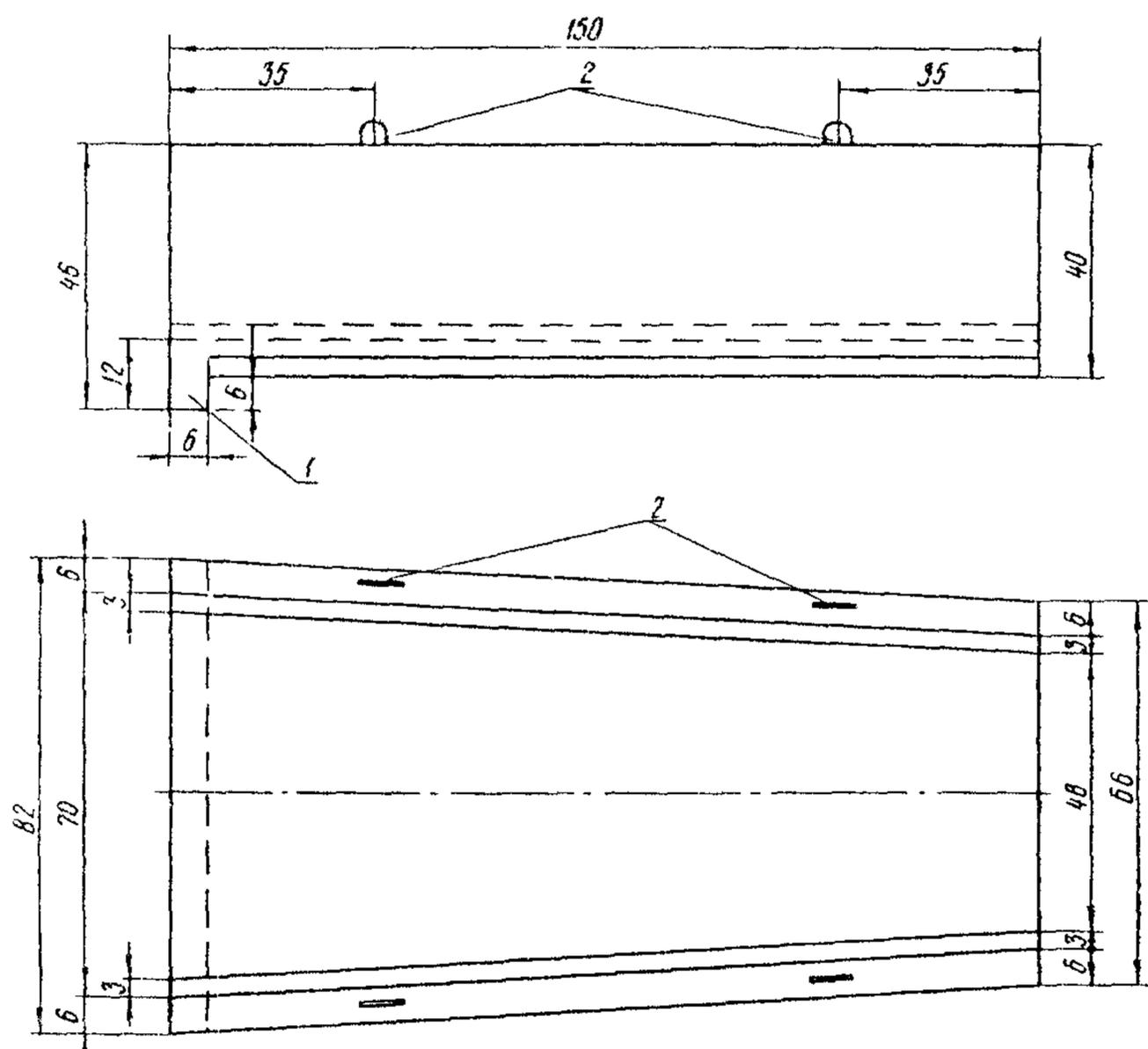
Рис. 1. Телескопический лоток:
