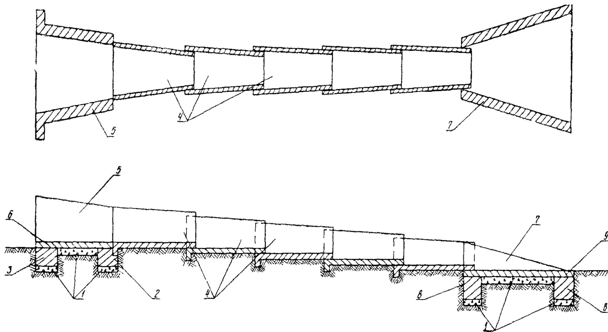
Рис 2. Общий вид лотка из телескопических блоков:
