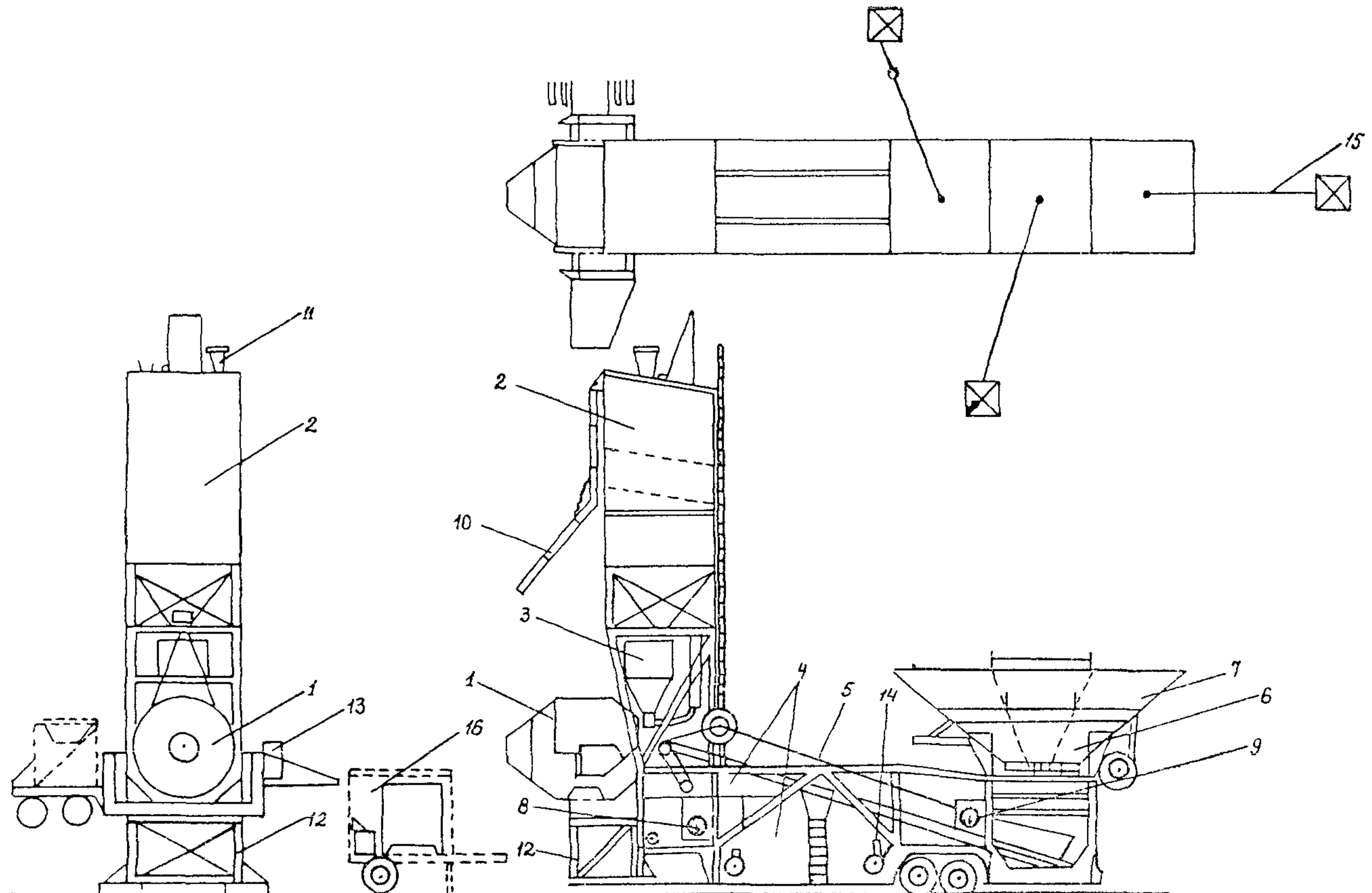
Рис. 2. Схема установки «Рекс»:
