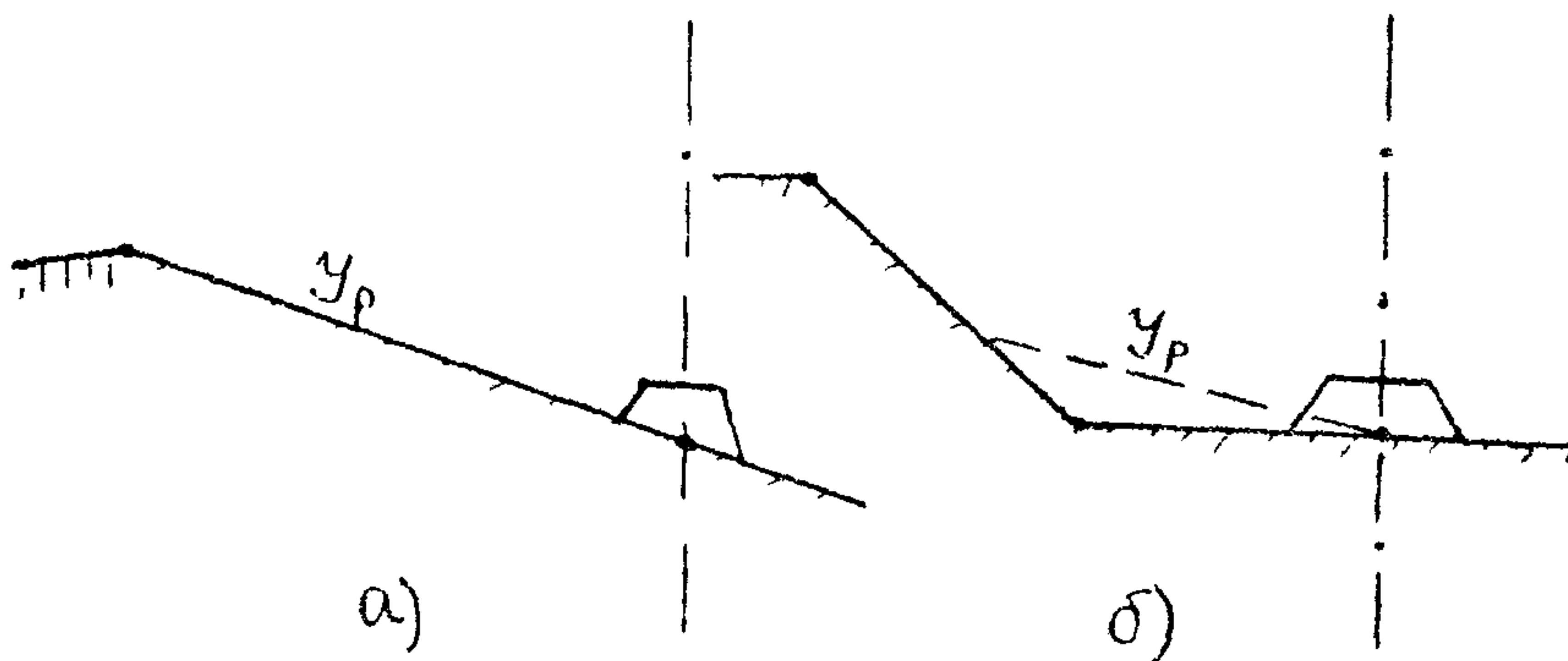
Рис.5. Схема и определению расчетного уклона главного русла.
