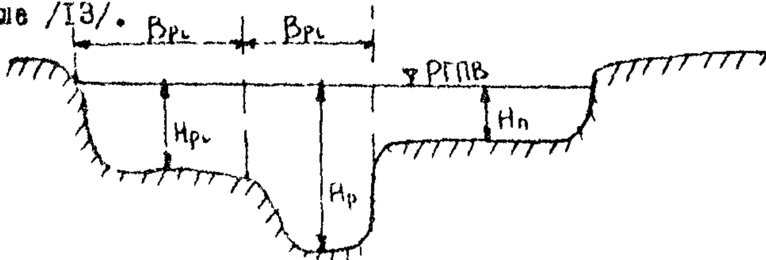
Рис.6. Схема к определению объема пруда на малых водостоках с разными различающимися в ров, лаграциих отдельных участках в различном живом сечении.
