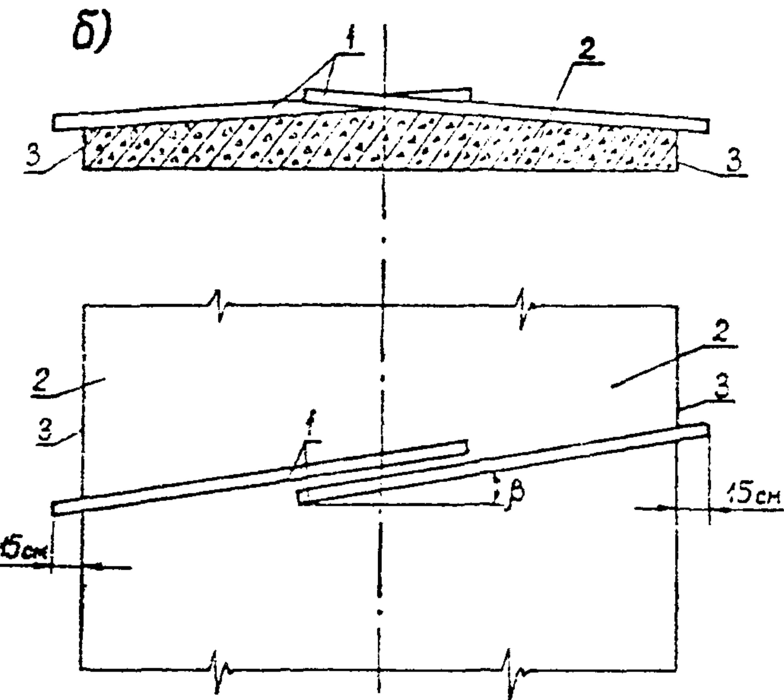
Положение брусьев при работе бетоновыглаживающей машины ТФВ-280
