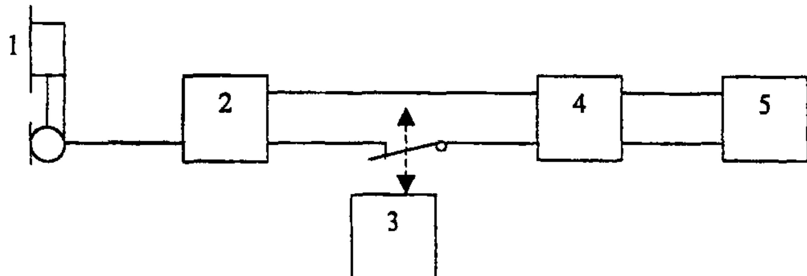
1 – микротелефонная трубка; 2 - испытуемый ТА; 3 – прерыватель;
