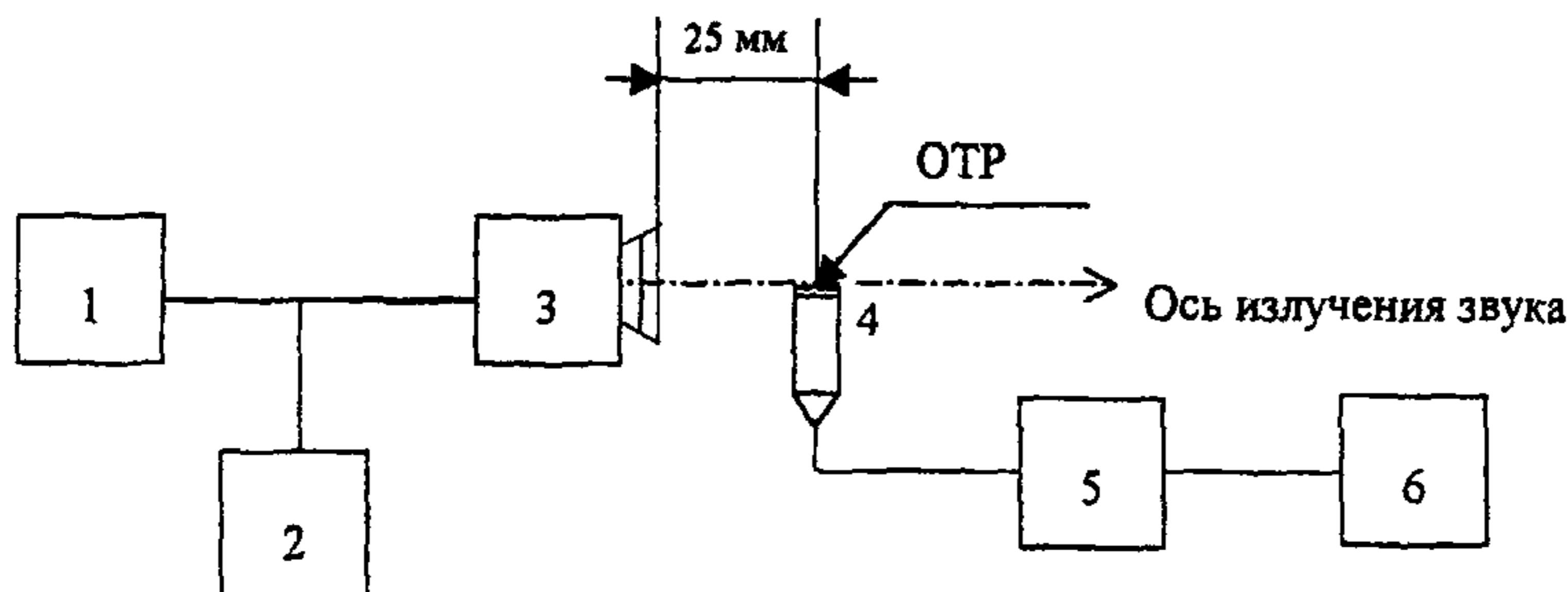
1 - генератор сигналов низкочастотный, 2 - частотометр, 3 - искусственный рот;
