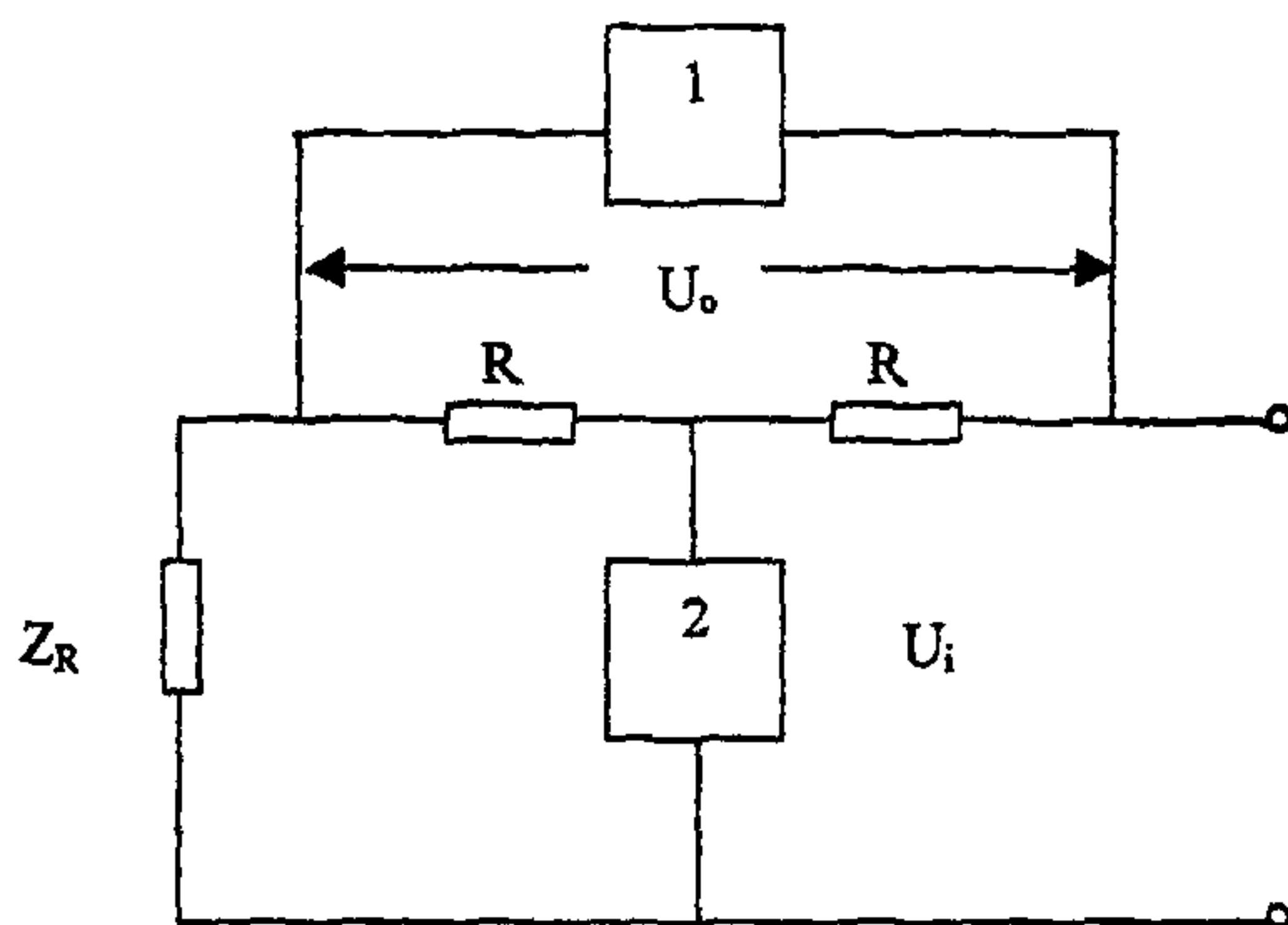
1 - генератор сигналов низкочастотный; 2 - электронный вольтметр;
