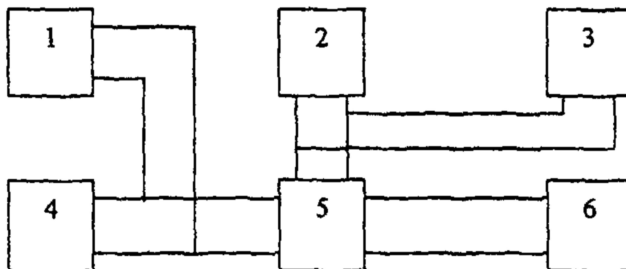
1 - вольтметр переменного напряжения, 2 - источник постоянного напряжения, 3 - вольтметр постоянного напряжения, 4 - генератор сигналов низкочастотный, 5 - мост питания, 6 - испытуемый ТА
