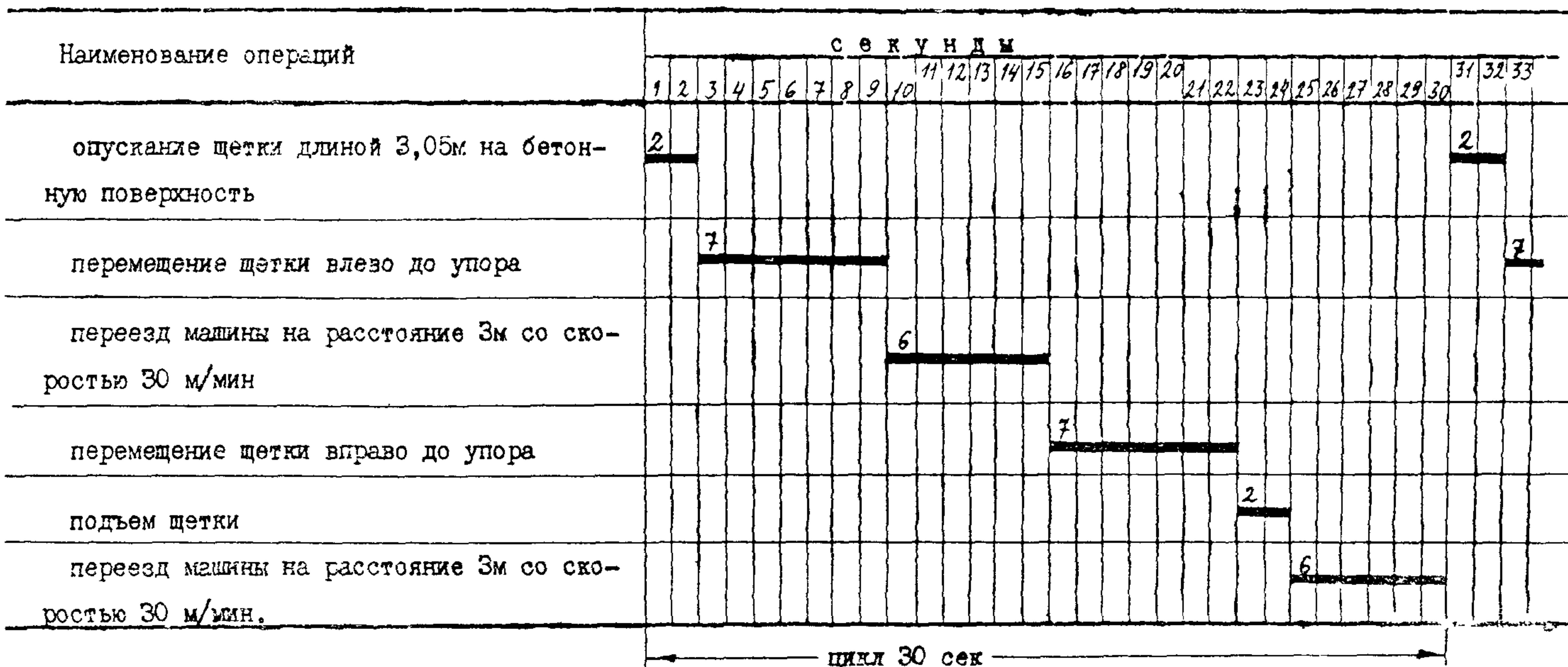
Производительность машины при текстурировании за час работы  $\frac{60 \times 6}{0,5} = 720$  м.
