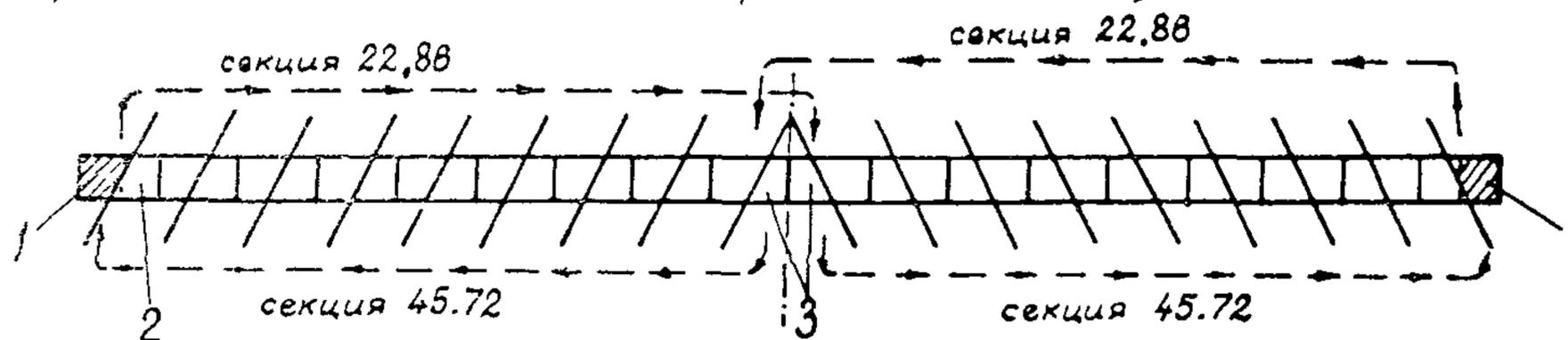
б) Положение лопастей после перестановки секций
