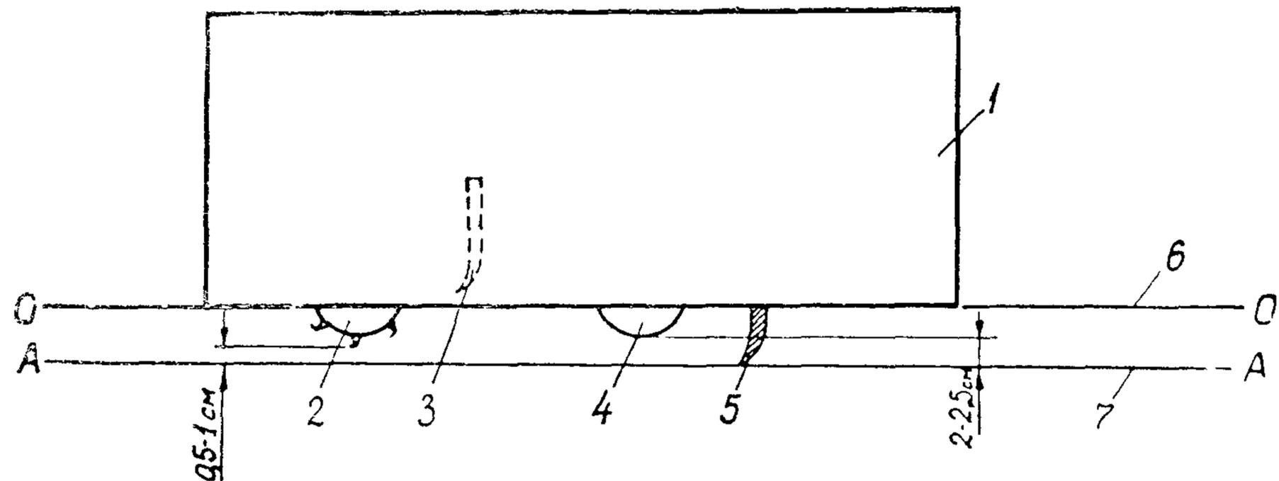
Рис 4 Схема установки рабочих органов при планировке земполотна без фрезерования
