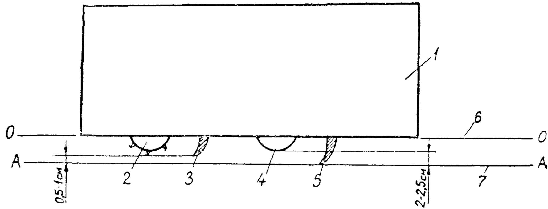
Рис 6 Схема установки рабочих органов при чистовой планировке земполотна
