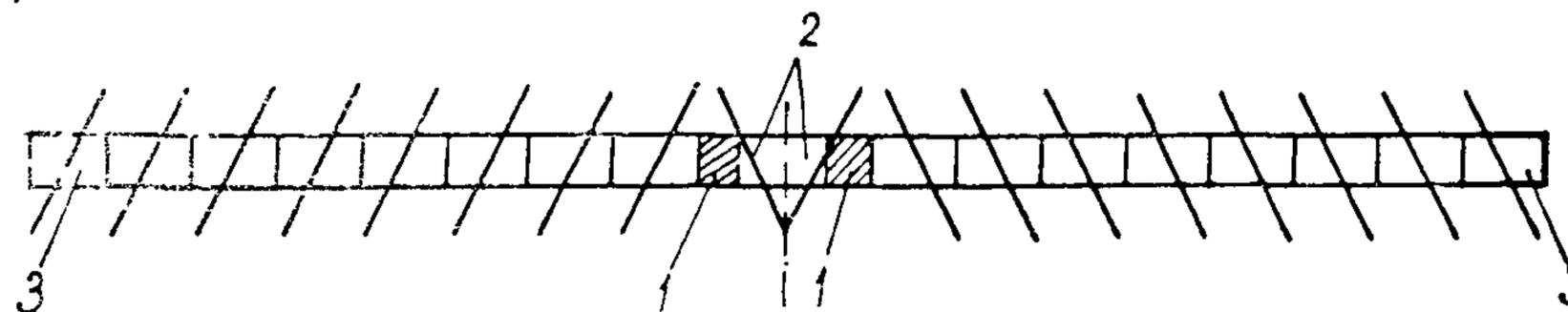
Рис. 5. Схема перестановки секций лопастей для центральной выгрузки грунта:
