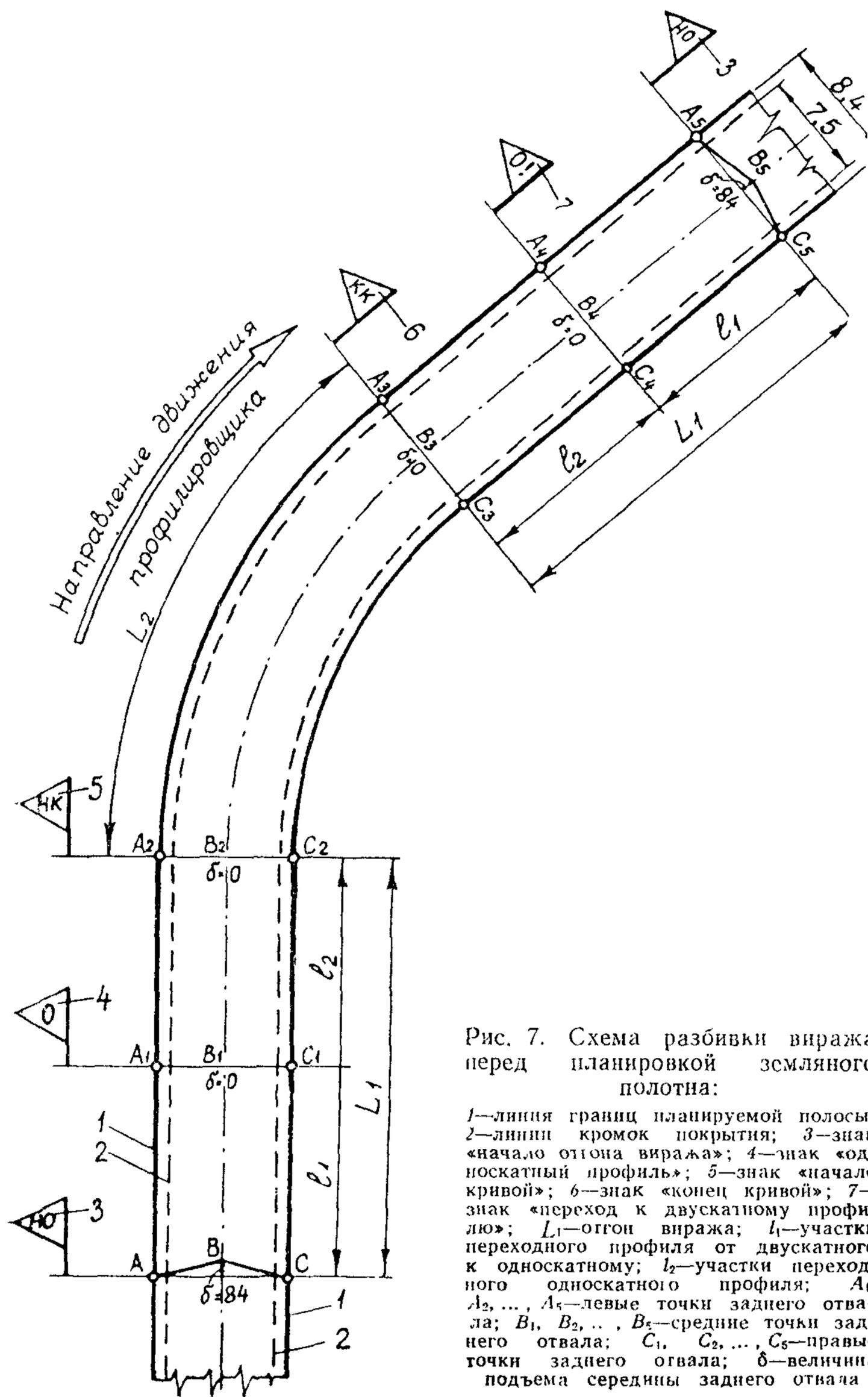
Рис. 7. Схема разбивки виража перед планировкой земляного полотна:
