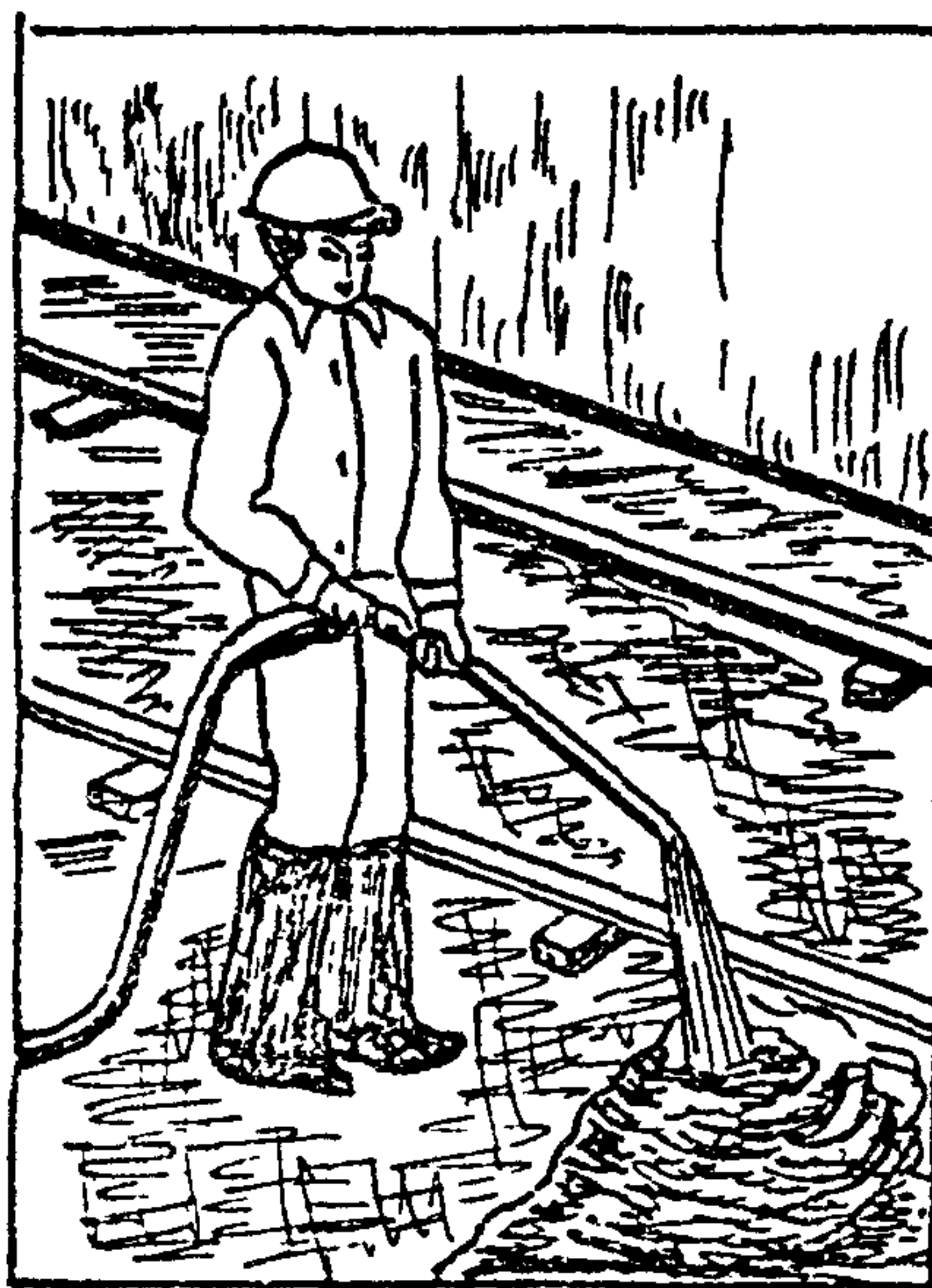
Рис. 5. Нанесение раствора соплом при устройстве полимерцементных стяжек
