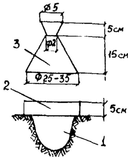
Определение плотности свежесушеного бетона методом засыпки лунки песком:
