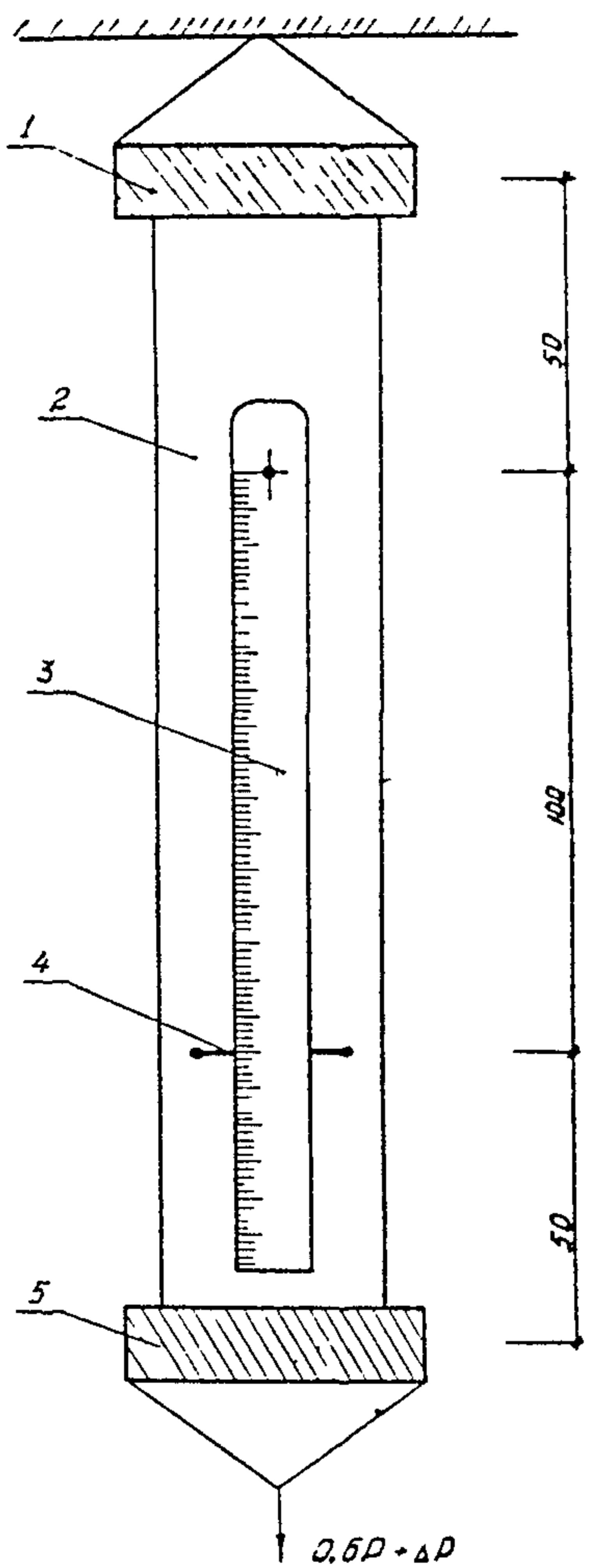
Рис. 27 Схема испытания СНМ на растяжение и разрывную нагрузку 1 — верхний зажим, 2 — синтетический нетканый материал, 3 — линейка, 4 — металлическая шпилька, 5 — нижний зажим
