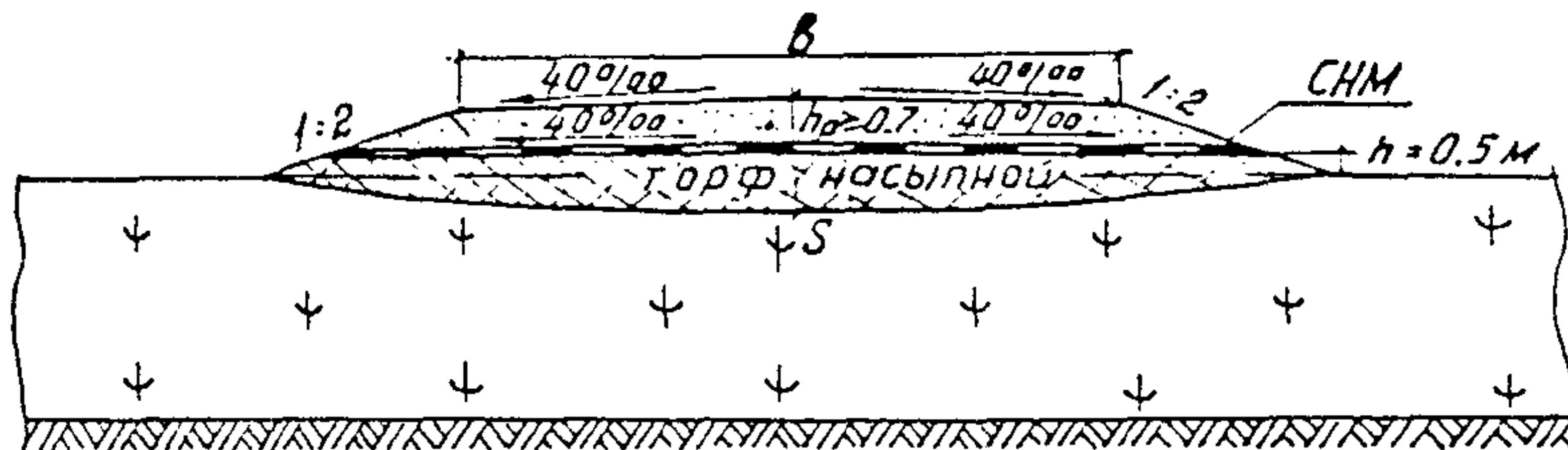
Рис. 8. Конструкция автомобильной дороги на вечномерзлых грунтах с просадочностью в пределах 0,03—0,15 и на болотах II, III типов при отсыпке торфяной части насыпи из сосредоточенных карьеров
