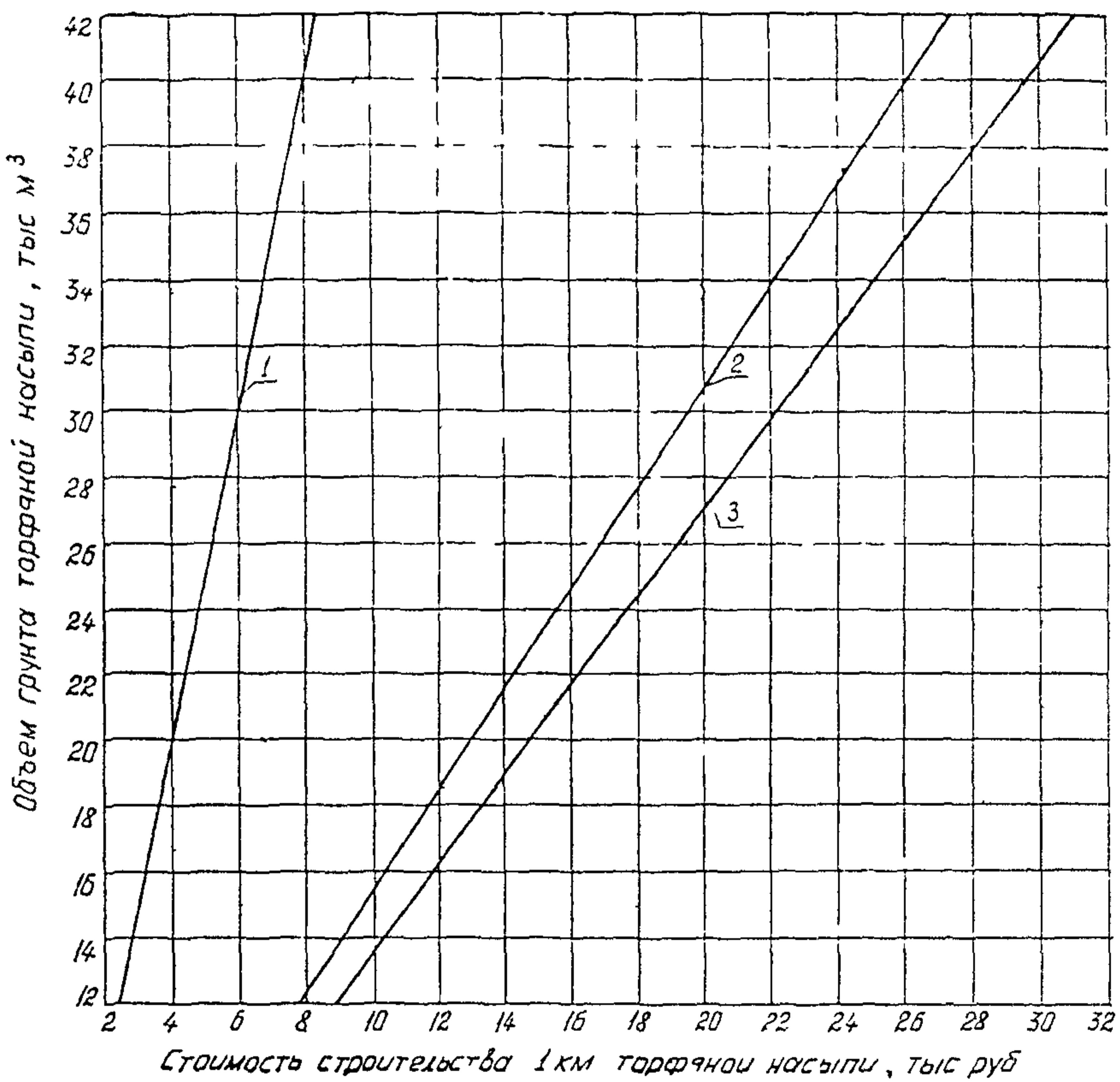
Рис. 29. График определения стоимости строительства 1 км торфяной насыпи в зависимости от способа разработки и дальности транспортирования торфа: 1 — торф из боковых резервов, 2 — торф из сосредоточенного резерва при дальности транспортирования 1 км, 3 — то же, при дальности транспортирования 2 км
