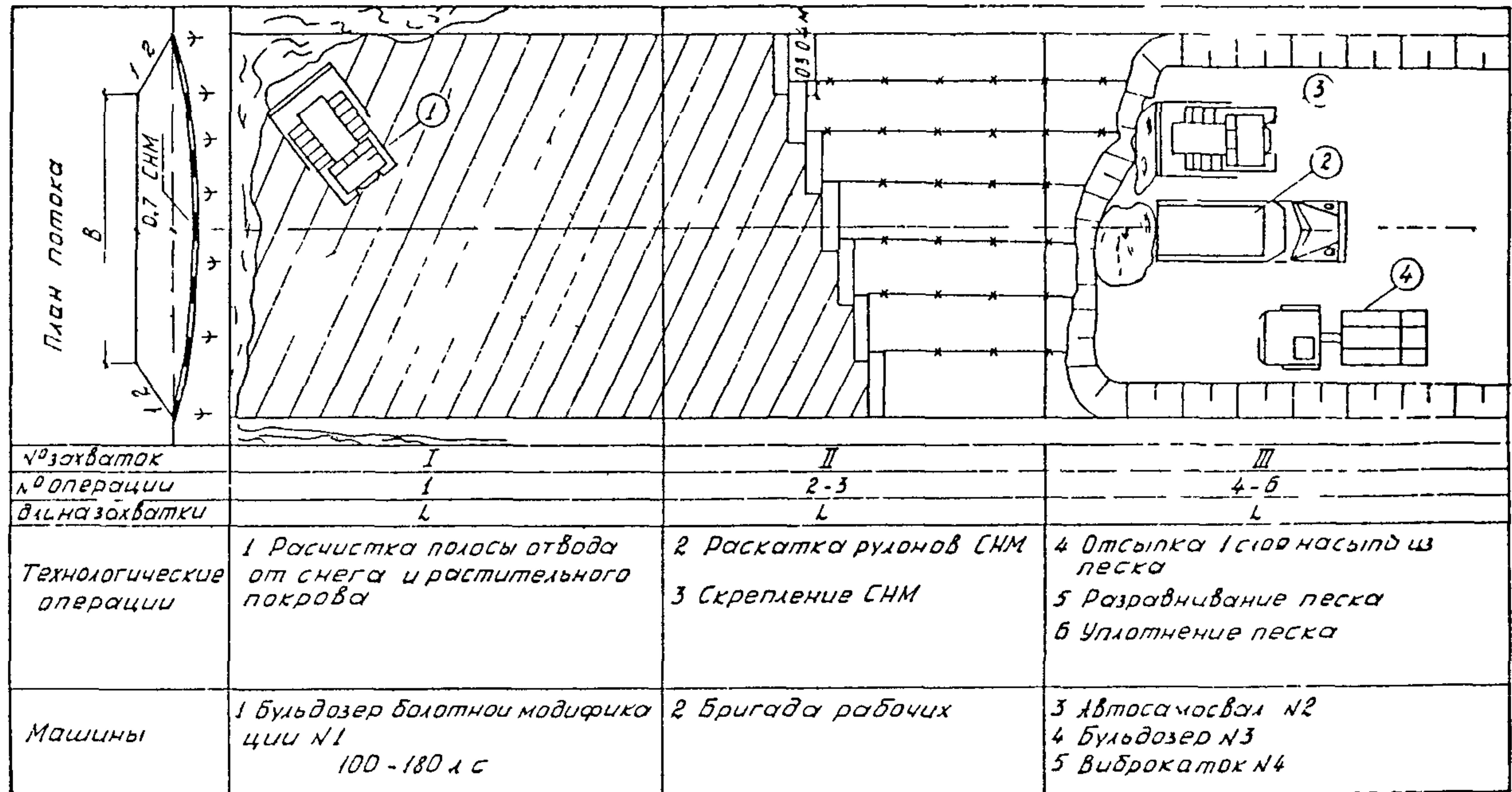
Рис. 22. Технологическая схема строительства автомобильной дороги и кустового основания с использованием СММ в летний период (подготовительные работы рекомендуется выполнять зимой) Условия применения болота I и II типов, заторфованные грунты, вечномерзлые торфяные грунты и минеральные грунты с льдистостью меньше 0,25
