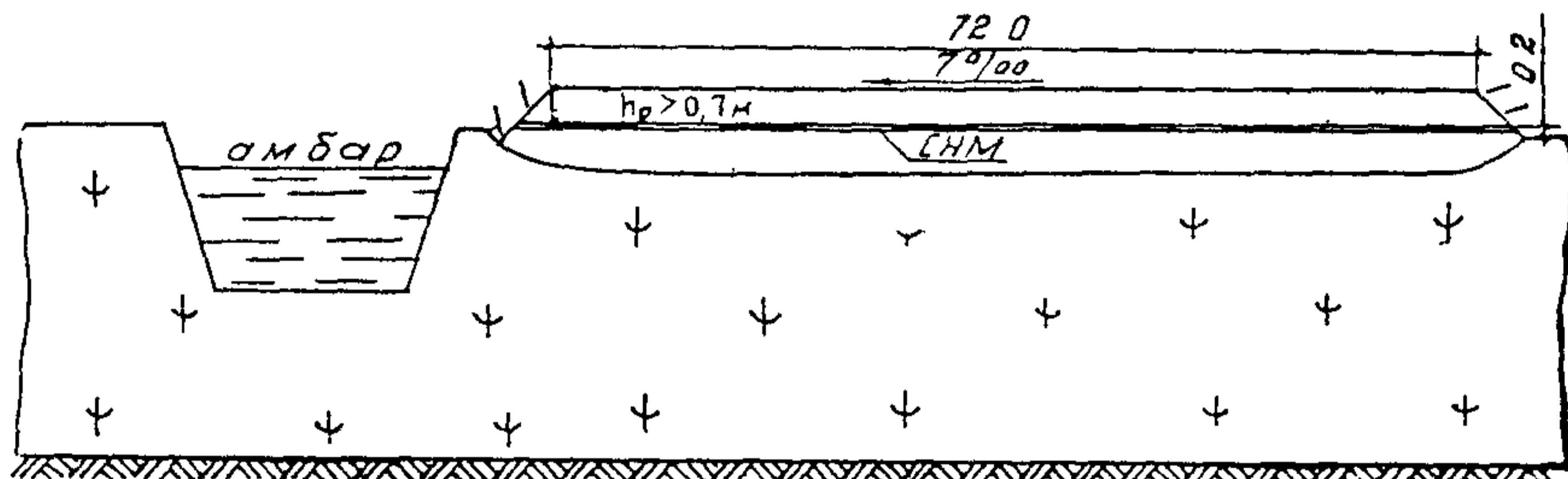
Рис. 14. Конструкция кустового основания на болотах III типа при использовании древесины (слани) и СНМ в основании насыпи
