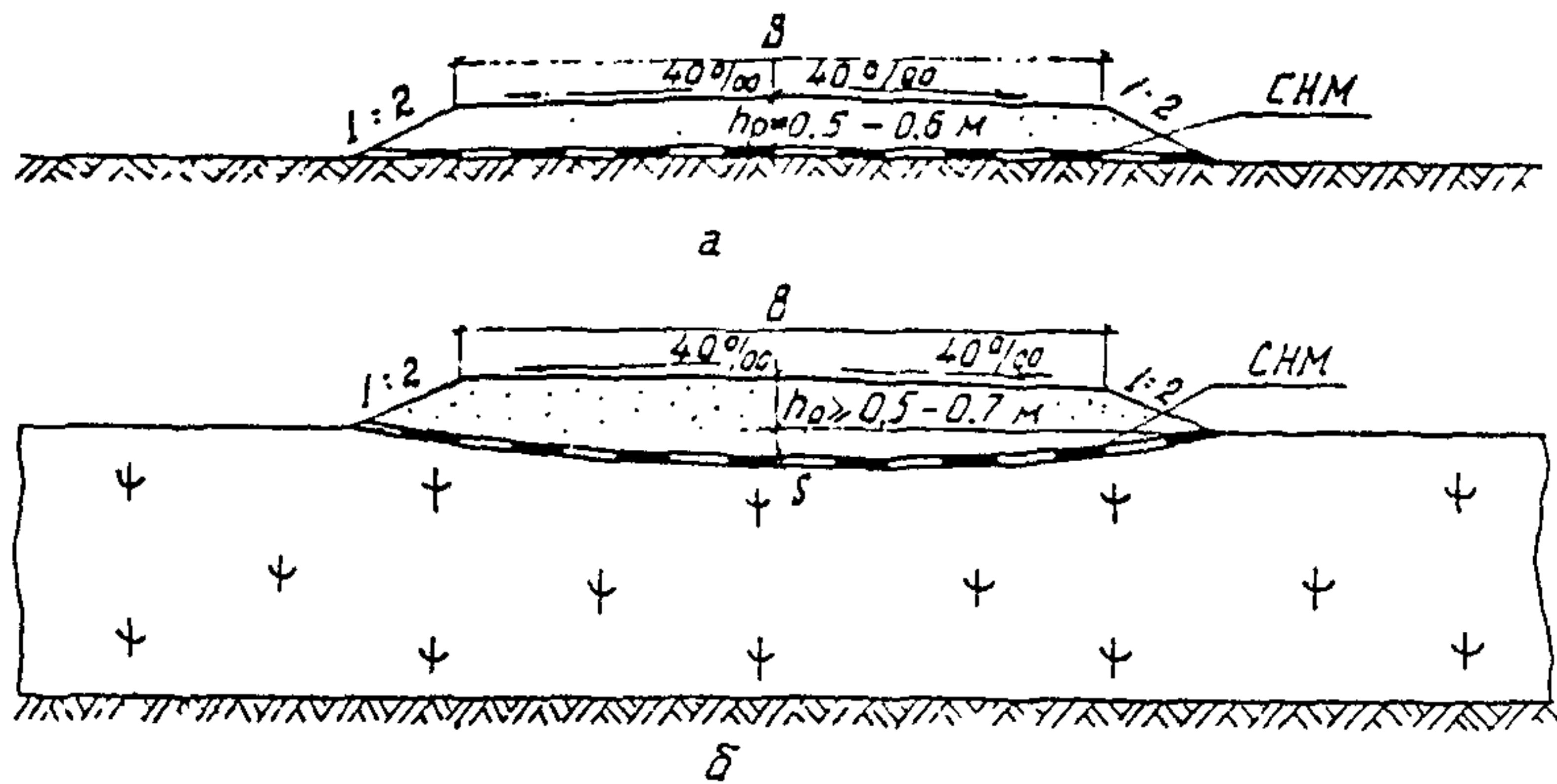
Рис. 6. Конструкция автомобильной дороги: а — на минеральных и вечно-мерзлых грунтах с просадочностью  $h_p$  менее 0,03; б — на болотах I, II типов и заторфованных грунтах
