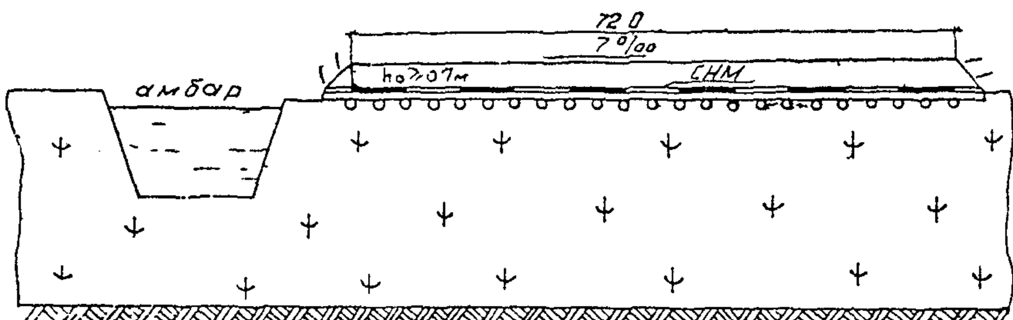
Рис. 12. Конструкция кустового основания на болотах I—III типов при расчетной толщине насыпного слоя более 1,5 м и отсыпке насыпи из одноразмерных песков
