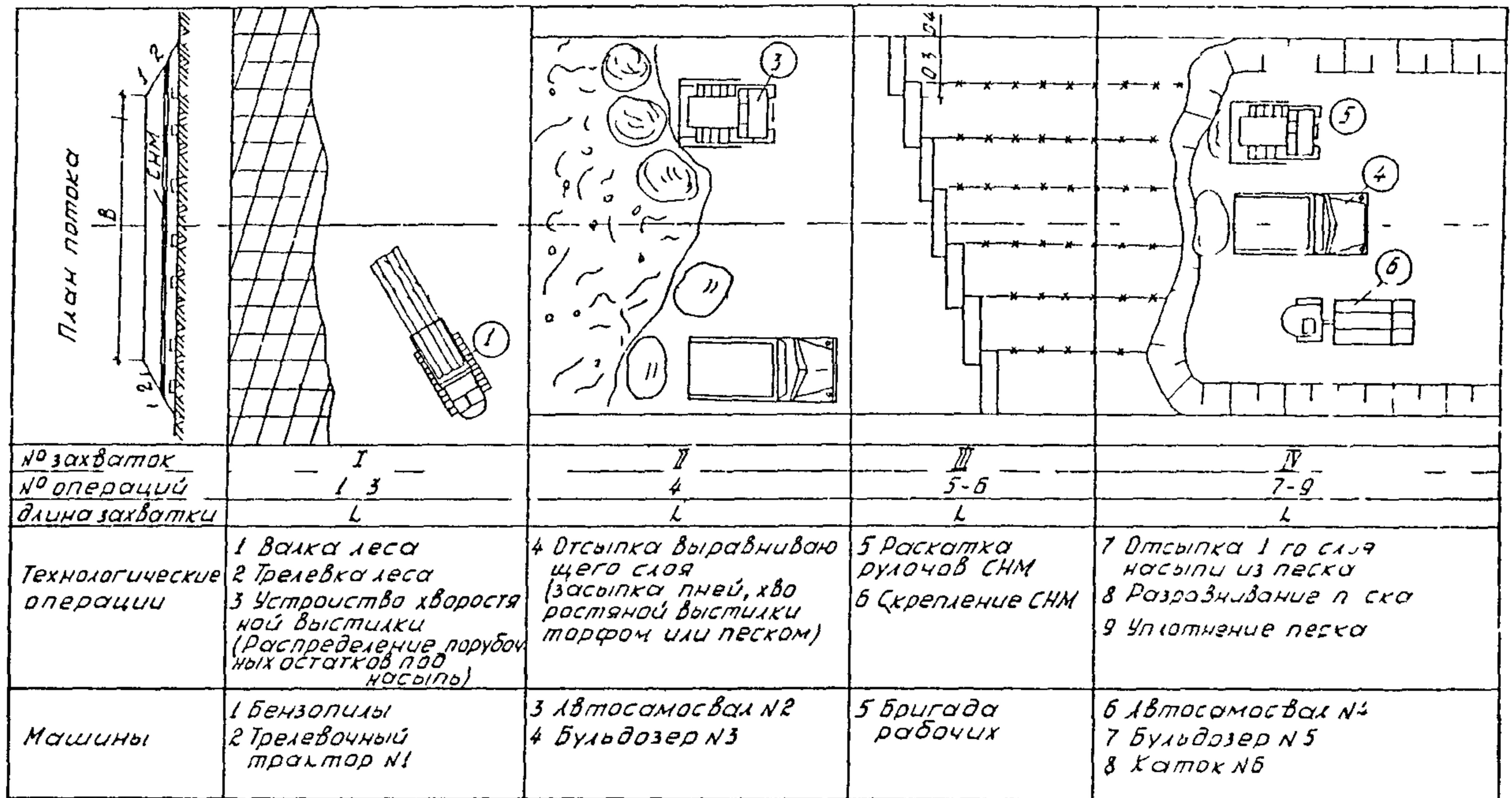
Рис. 23. Технологическая схема строительства автомобильной дороги с использованием СНМ на перевлажненных минеральных грунтах
