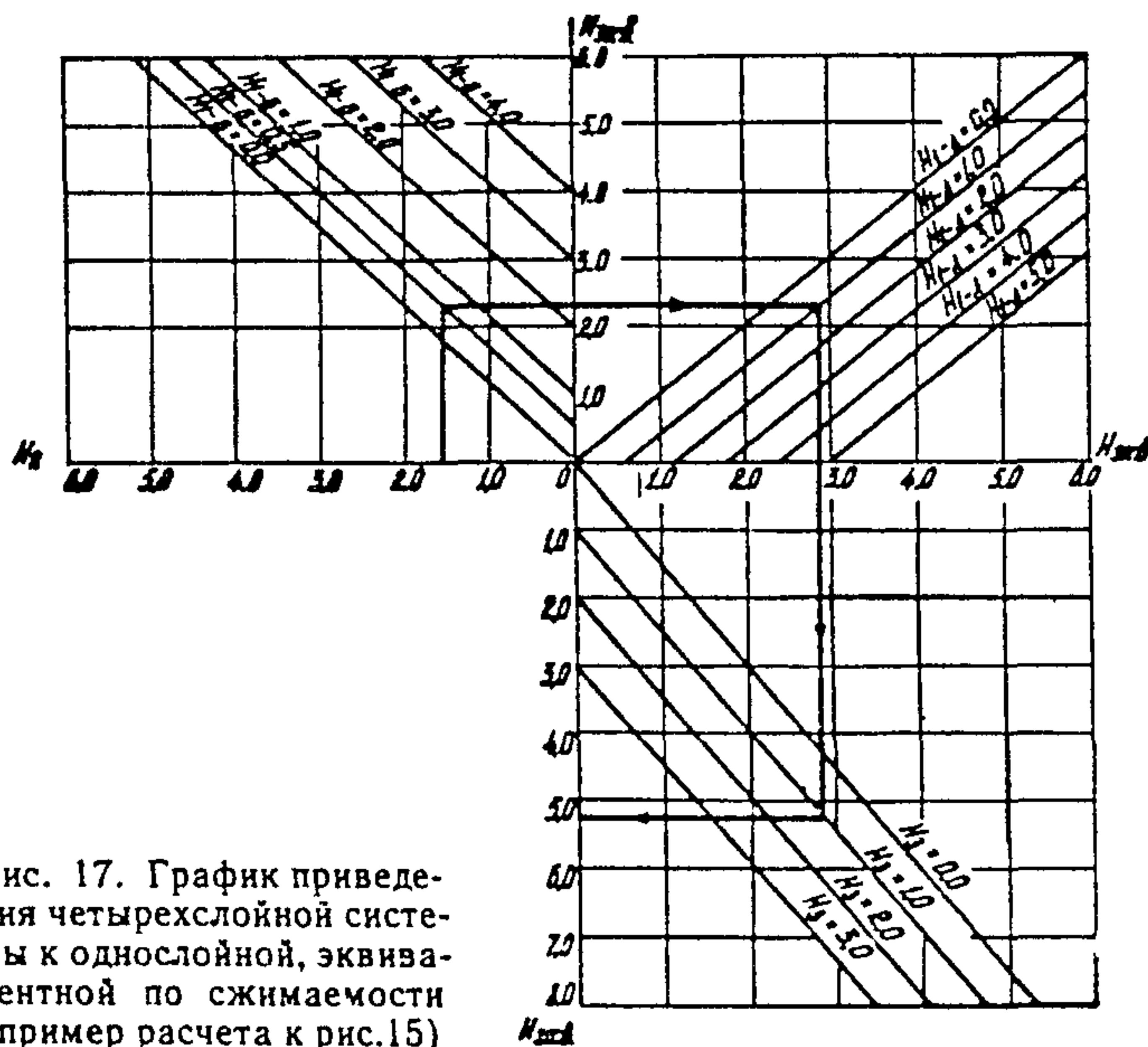
Рис. 17. График приведения четырехслойной системы к однослоиной, эквивалентной по сжимаемости (пример расчета к рис. 15)
