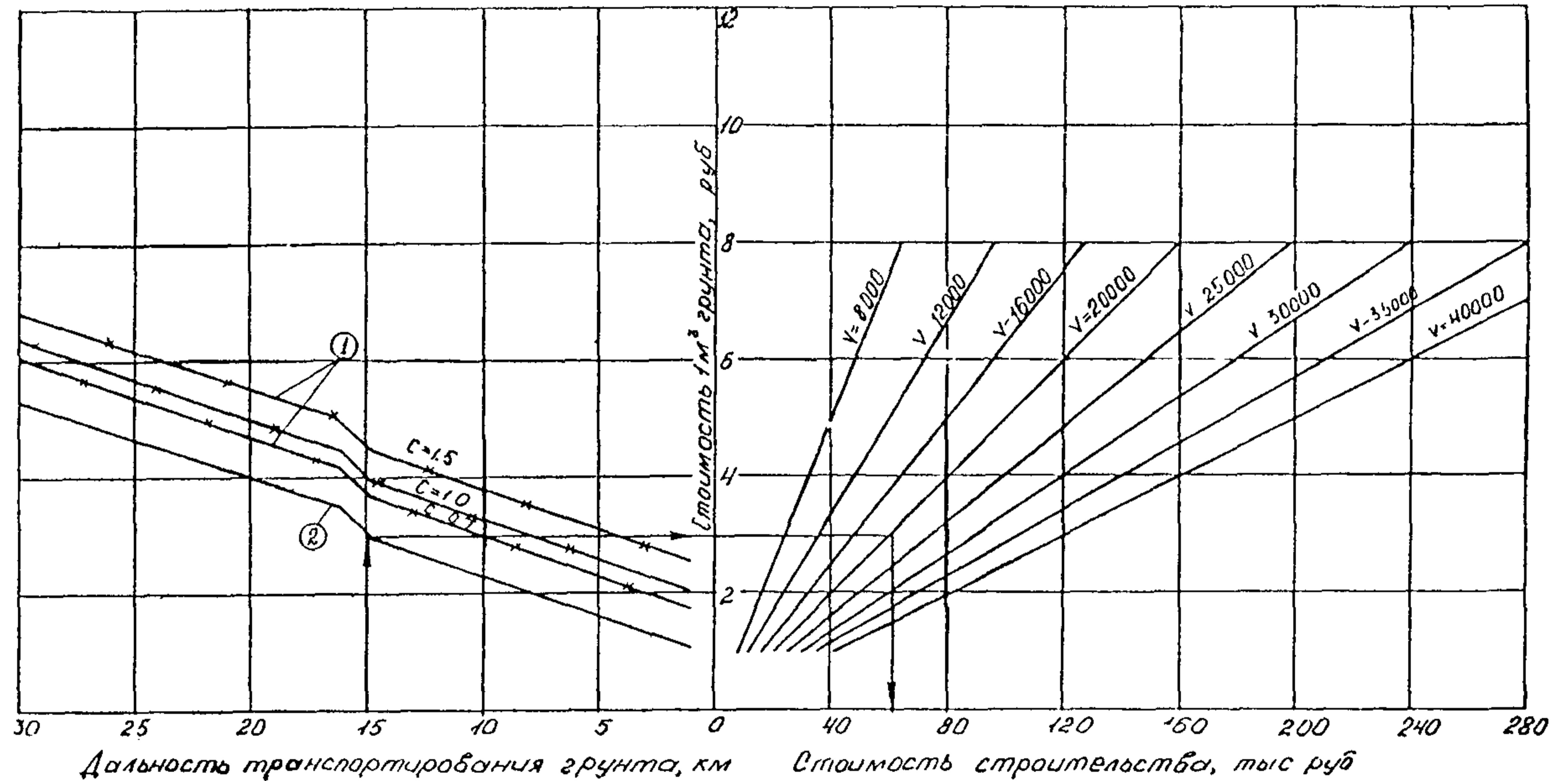
Рис. 28. График определения стоимости строительства земляного полотна в зависимости от дальности транспортирования, способа разработки и объема грунта, укладываемого в насыпь: 1 — грунт из сопредельного карьера; 2 — грунт гидронамывной
