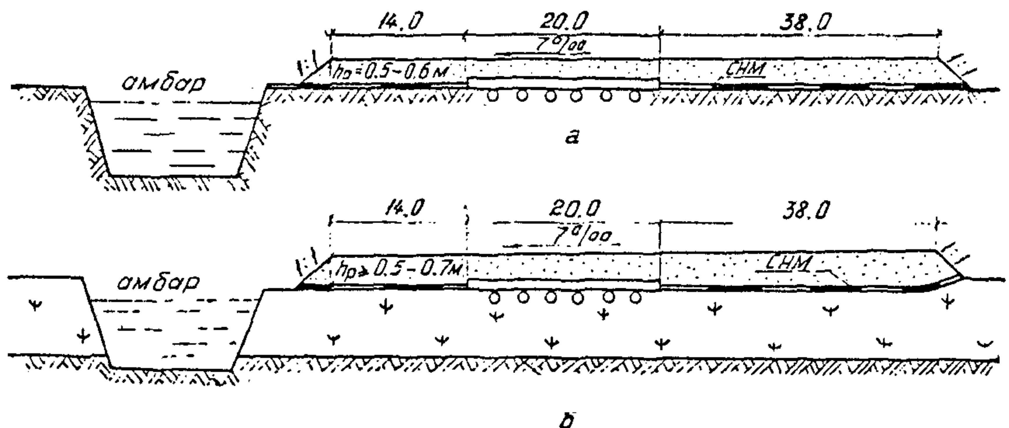
Рис. 7. Конструкция основания под куст скважин: а — на минеральных и вечно-мерзлых грунтах с просадочностью  $h_p$  менее 0,03; б — на болотах I, II типов и заторфованных грунтах
