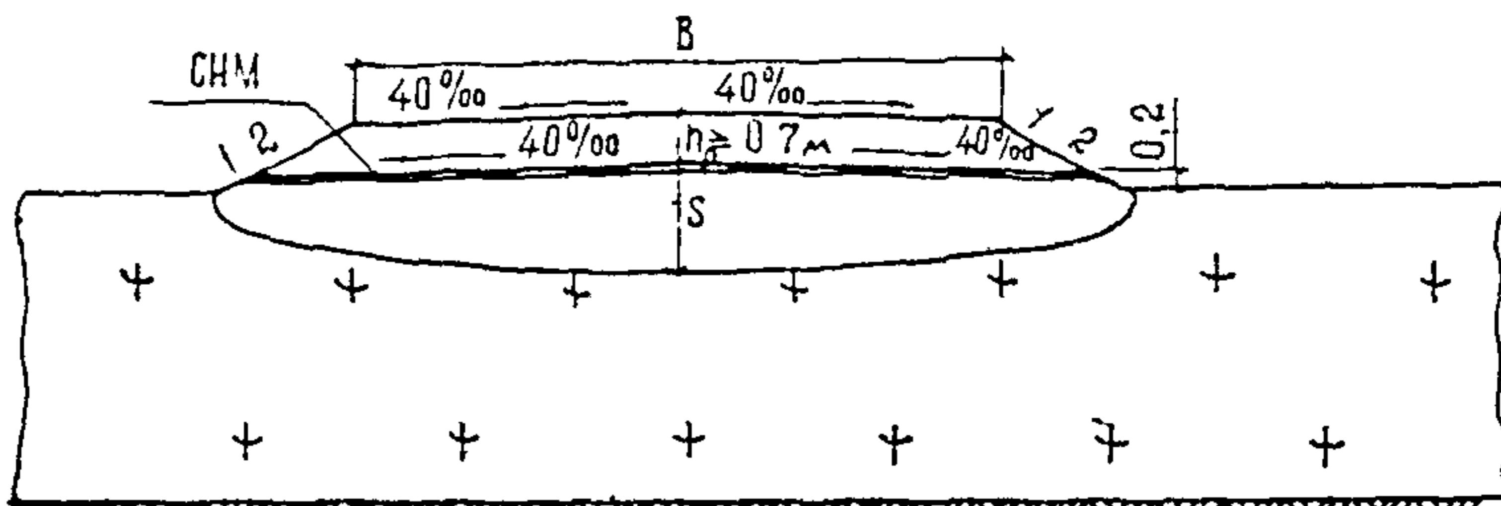
Рис. 11. Конструкция автомобильной дороги на болотах I—III типов при расчетной толщине насыпного слоя более 1,5 м и отсыпке насыпи из одноразмерных песков
