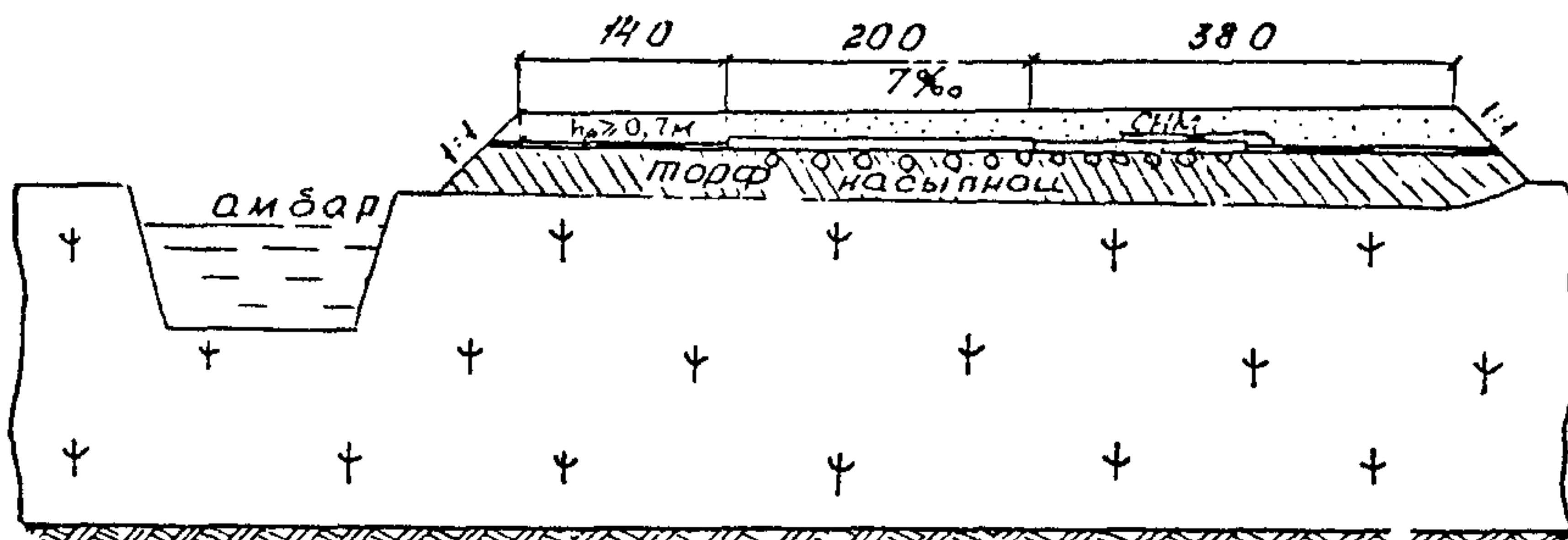
Рис. 10 Конструкция оснований под куст скважин на вечномерзлых грунтах с просадочностью в пределах 0,03—0,15 и болотах II, III типов
