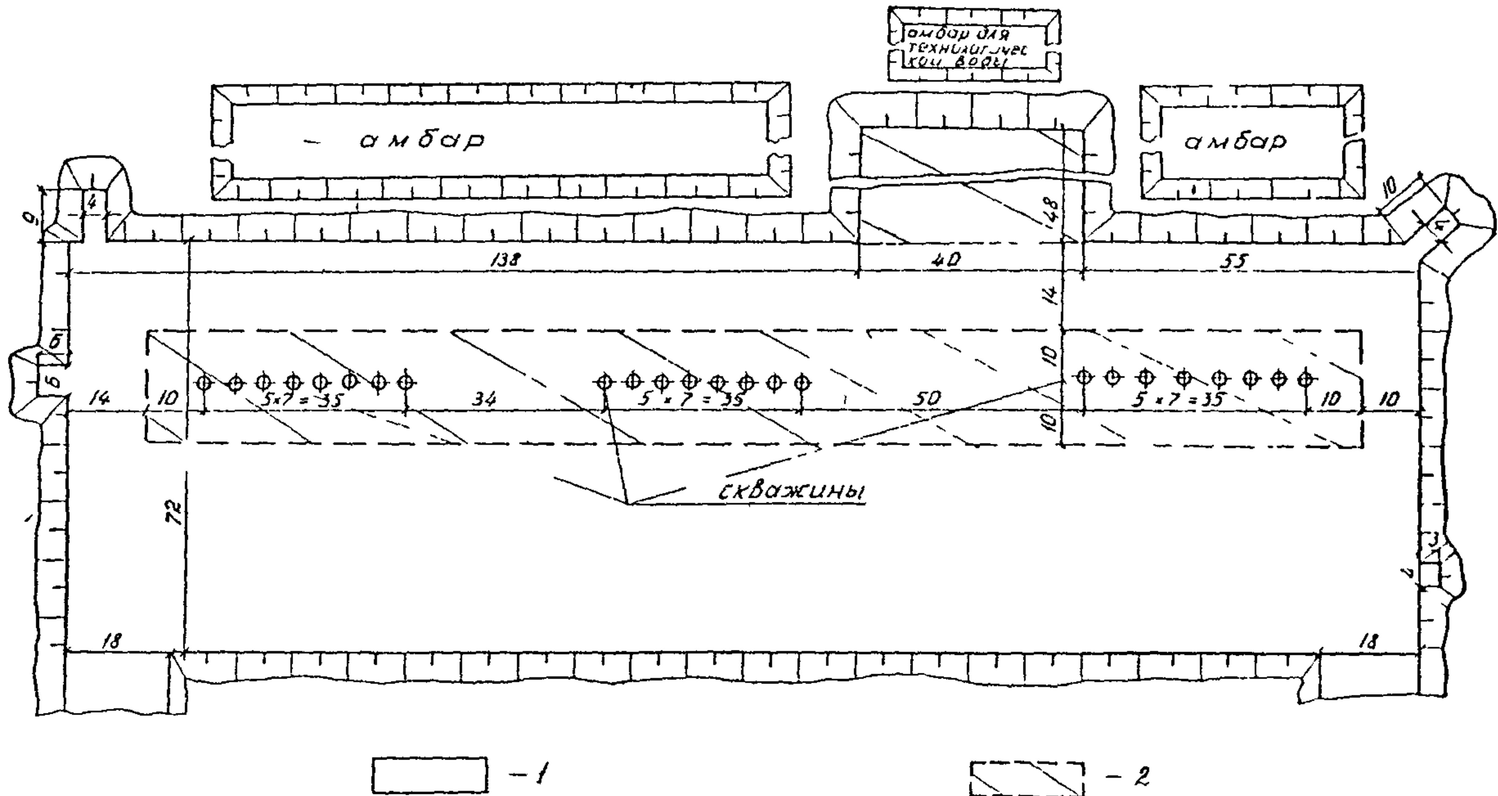
Рис. 3. План основания под трехпозиционный куст скважин, размеры даны в метрах (трубопроводы на слабых грунтах укладываются на сплошной деревянный настил): 1 — возможная площадь укладки СНМ; 2 — обязательная площадь укладки древесины
