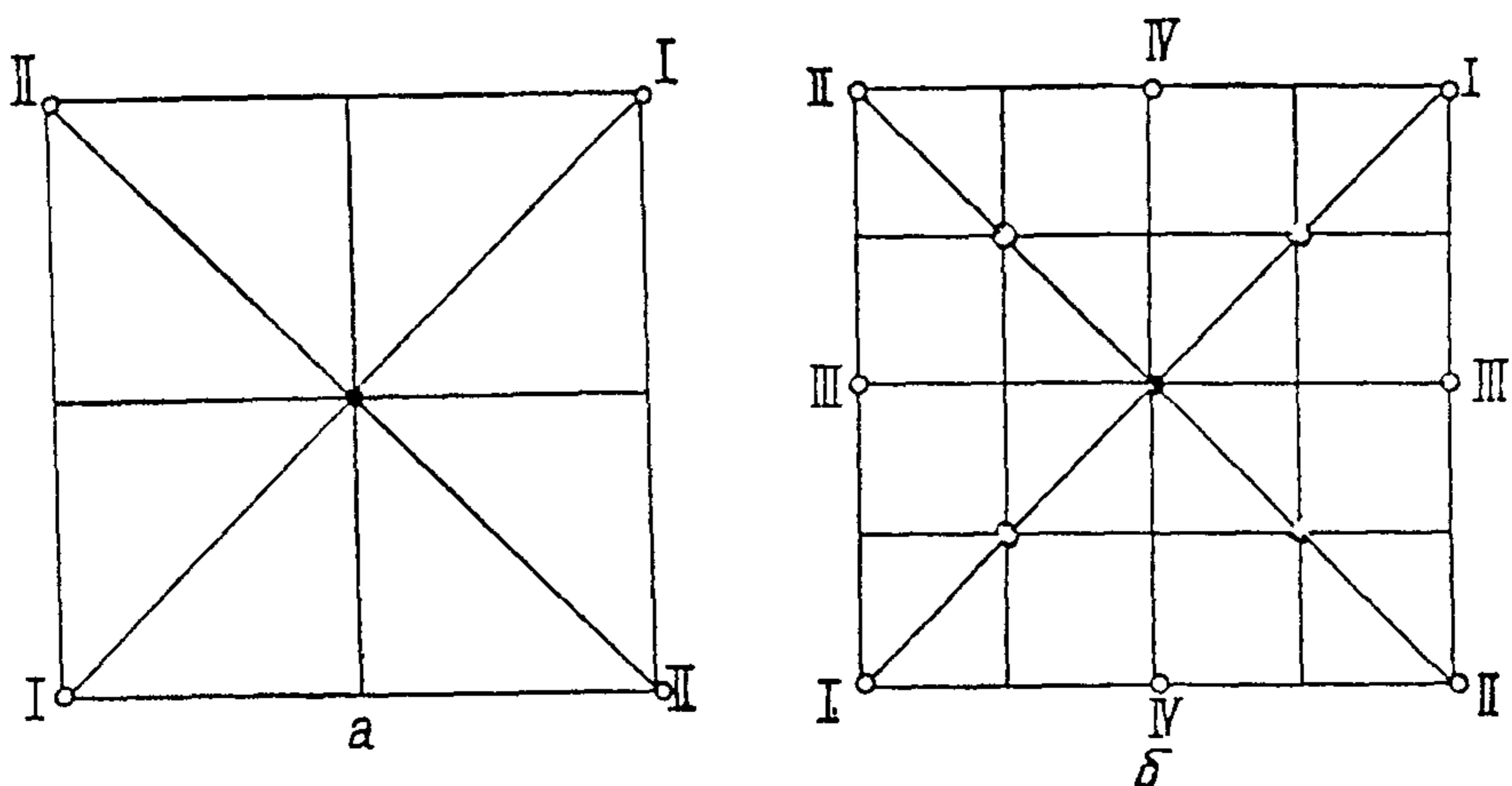
Рис. 4. Схема расположения скважин на площадке под кустовое основание:
