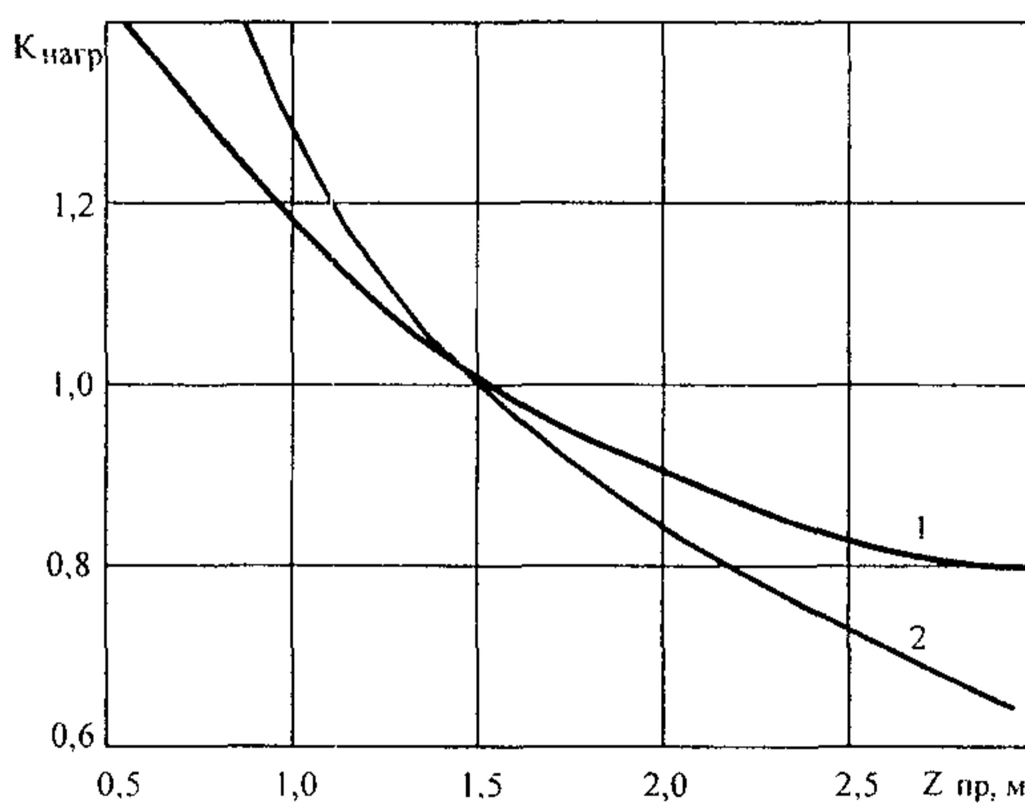
Рис.П.1.3. Зависимость коэффициента  $K_{nagp}$  от глубины промерзания  $Z_{np}$  от поверхности покрытия:
