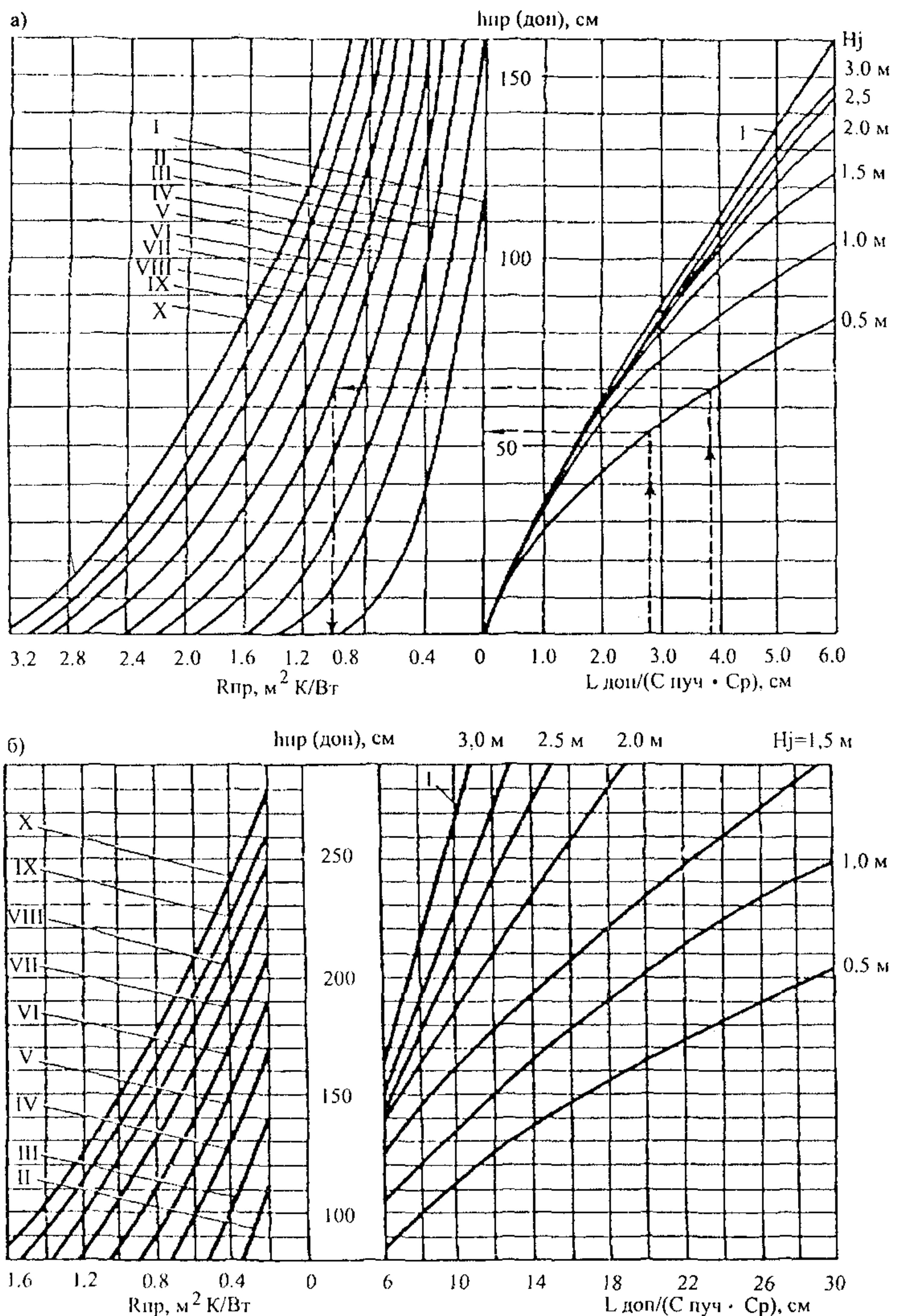
Рис.2.3. Номограмма для определения приведенного термического сопротивления дорожной одежды  $R_{\text{пр}}$ .
