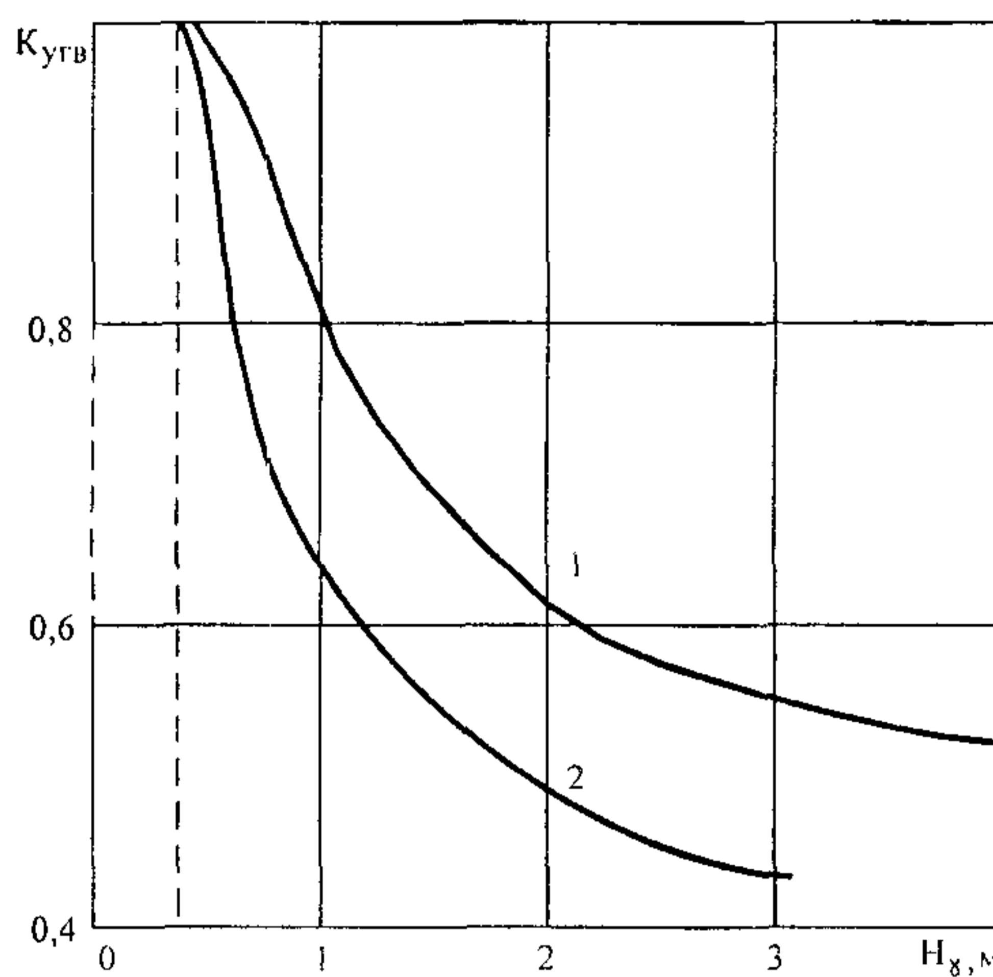
Рис.П.1.2. Зависимость коэффициента  $K_{ytb}$  от расстояния от низа дорожной одежды до расчетного УГВ или УПВ.
