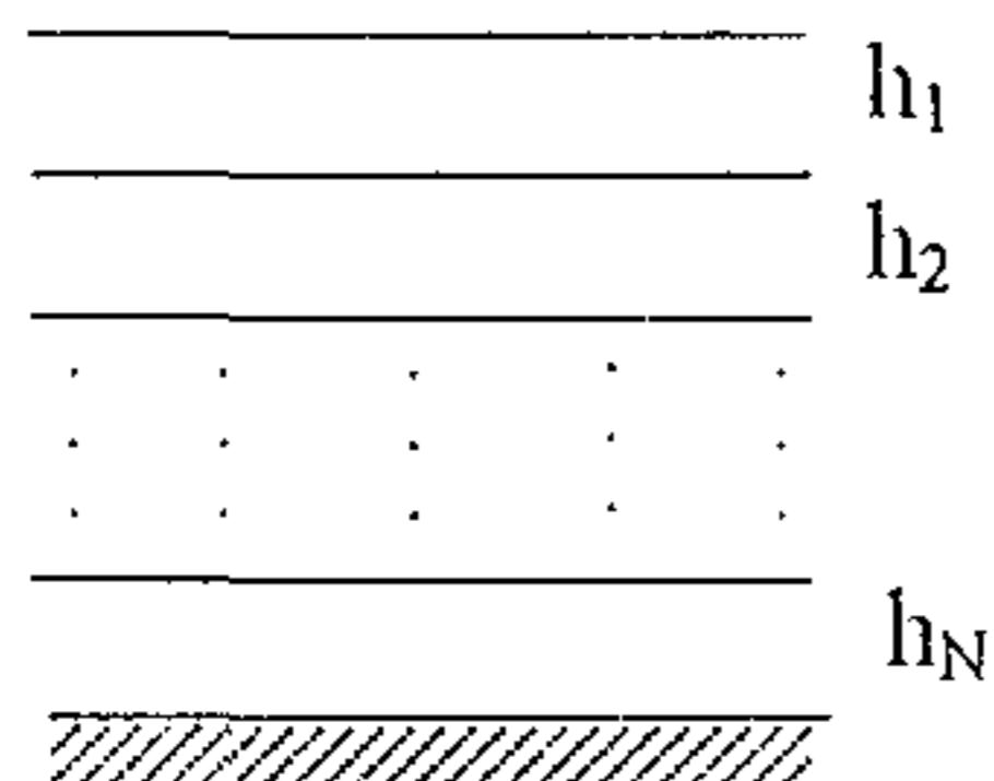
Рис.3.1. Расчетная схема для центральной части дорожной конструкции
