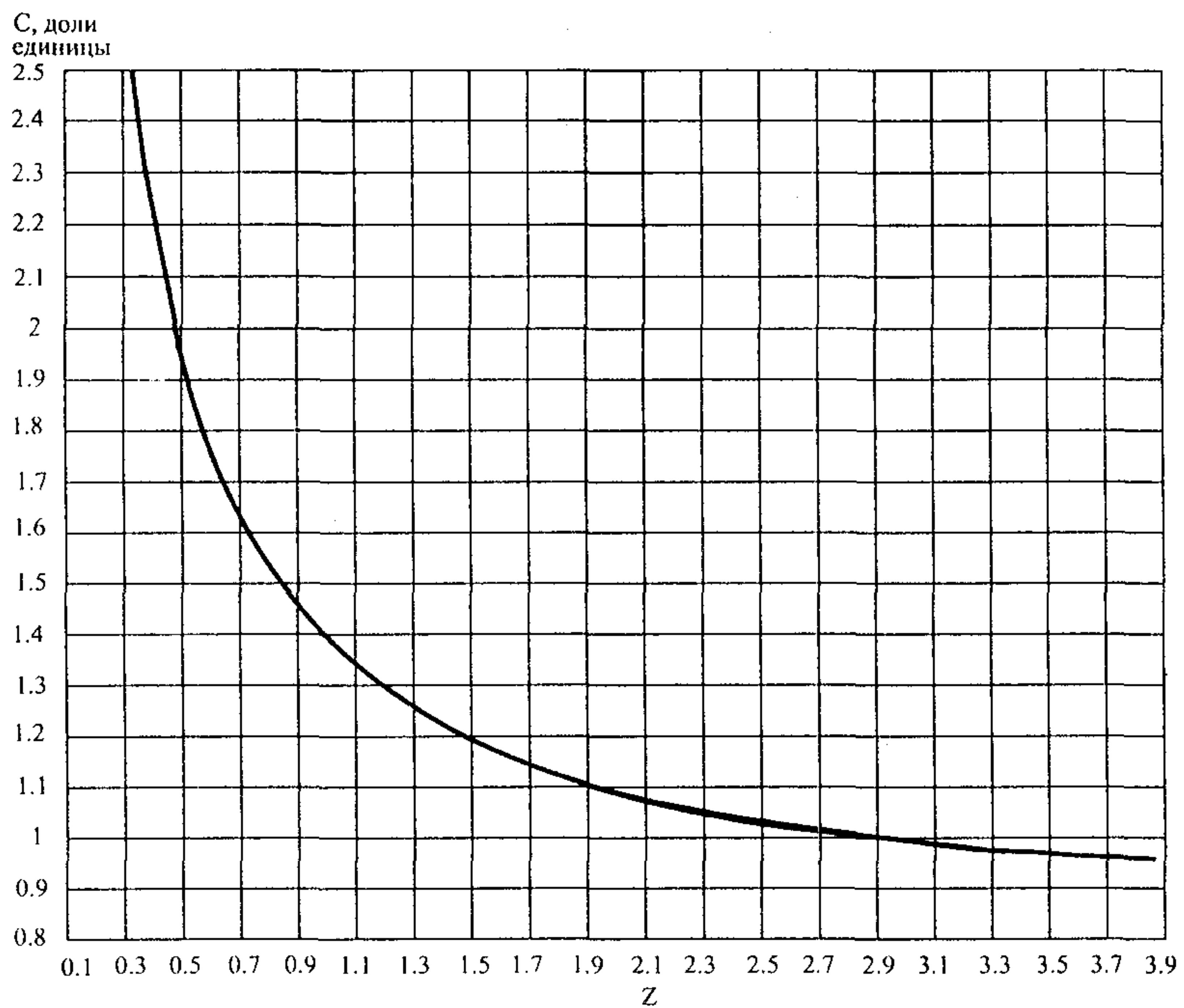
Рис.2.5. График для определения коэффициента С, используемого для вычисления весенней влажности.
