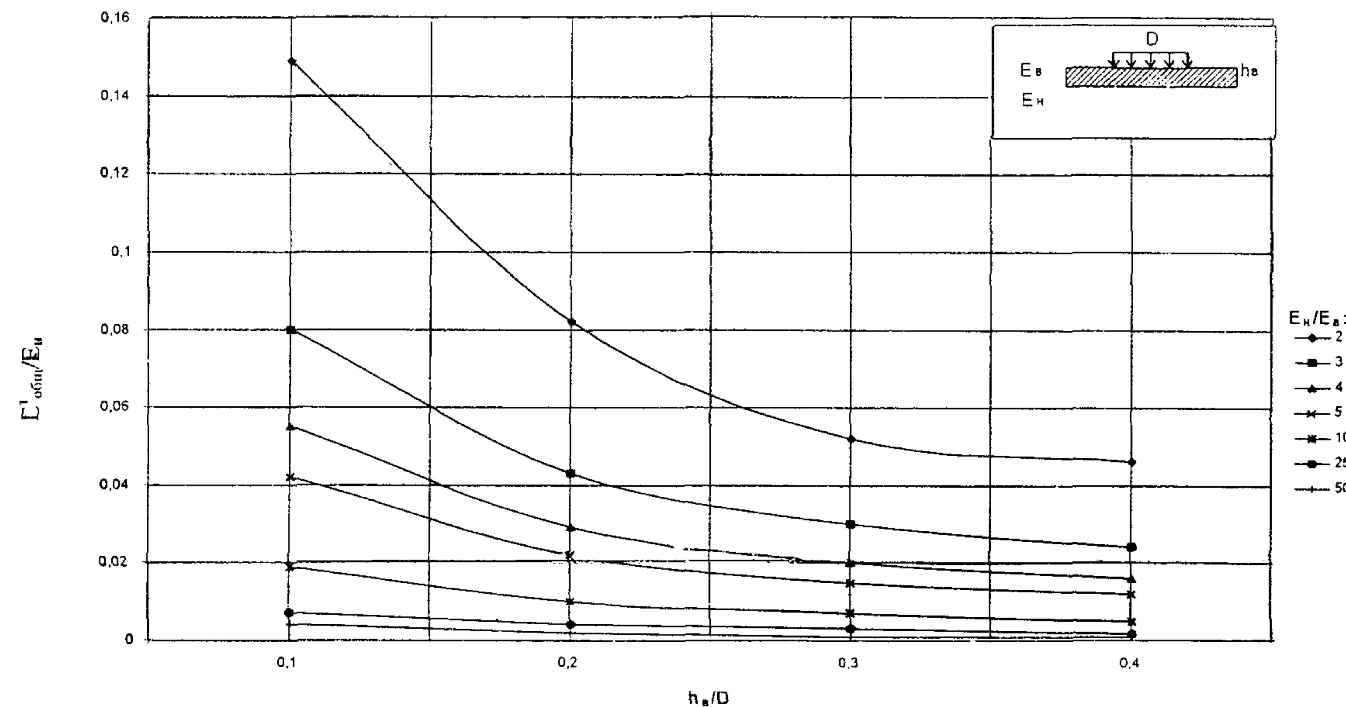
Рис. 2.7. Номограмма для расчета общего модуля двухслойной системы "теплоизолятор - подстилающий грунт":
