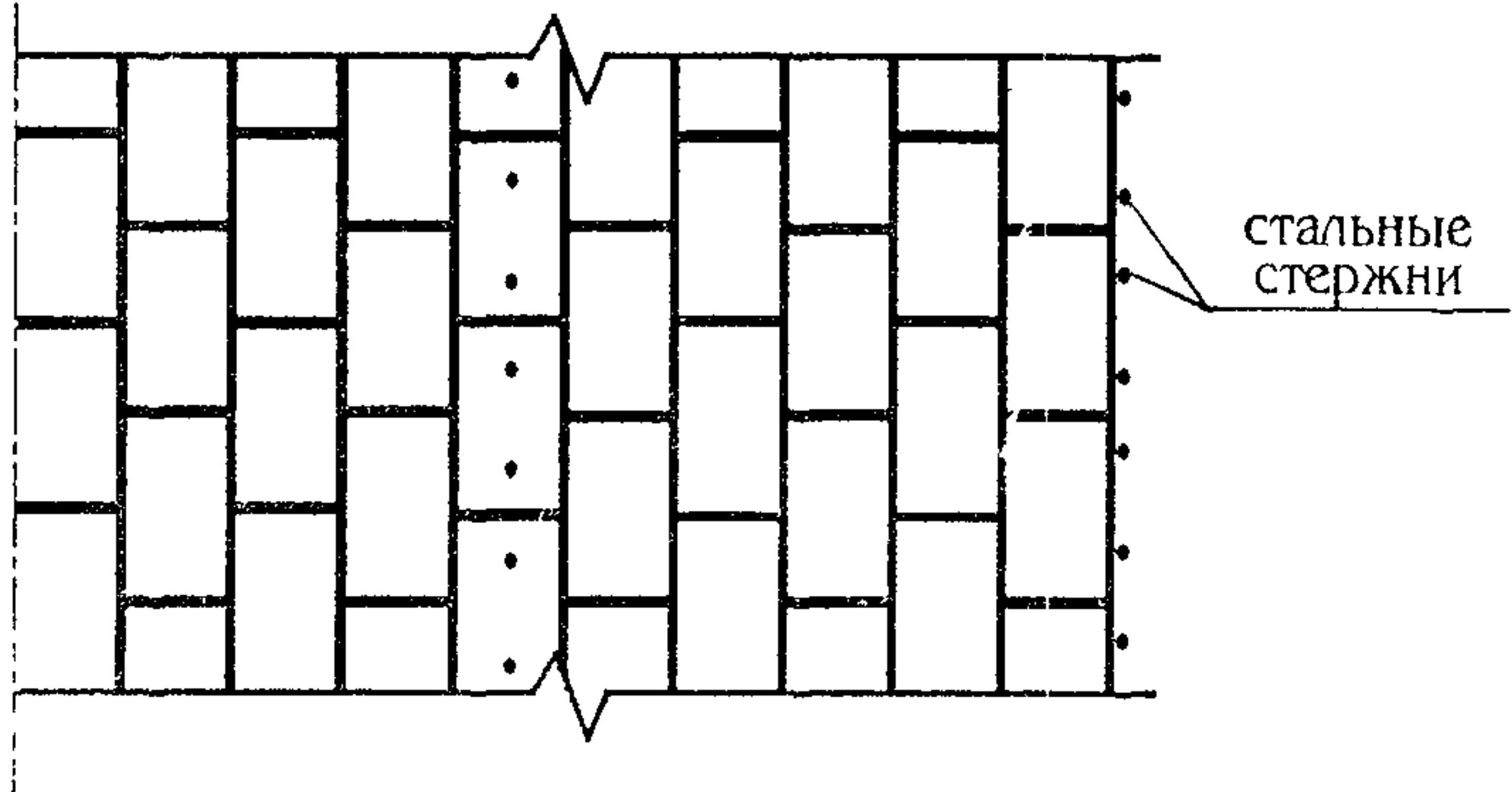
Рис. 5.1. Схема укладки плит «Пеноплэкса» в один ярус
