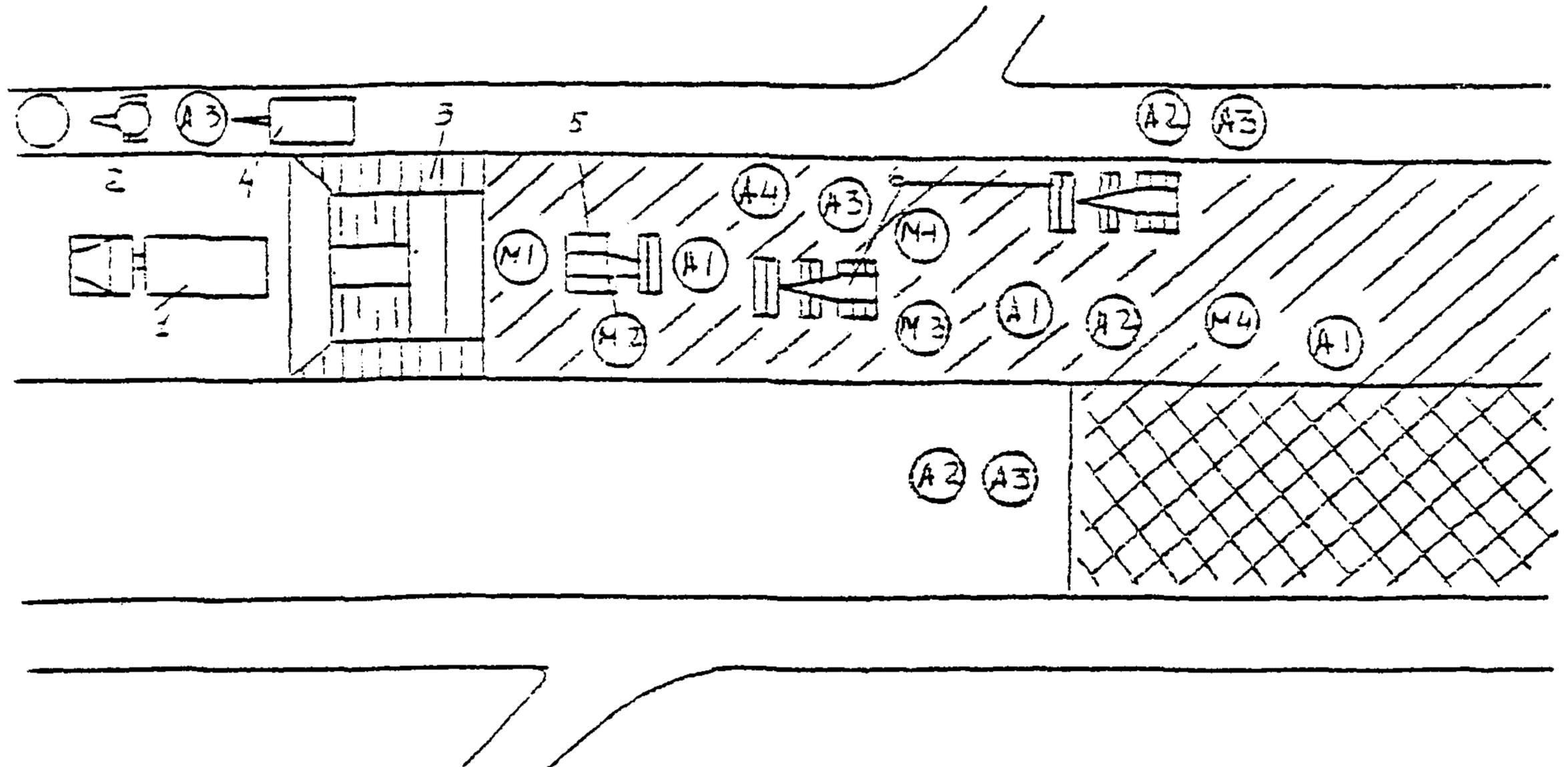
1 – автомобиль-самосвал; 2 – передвижной битумный котел; 3 – самоходный асфальтоукладчик;
