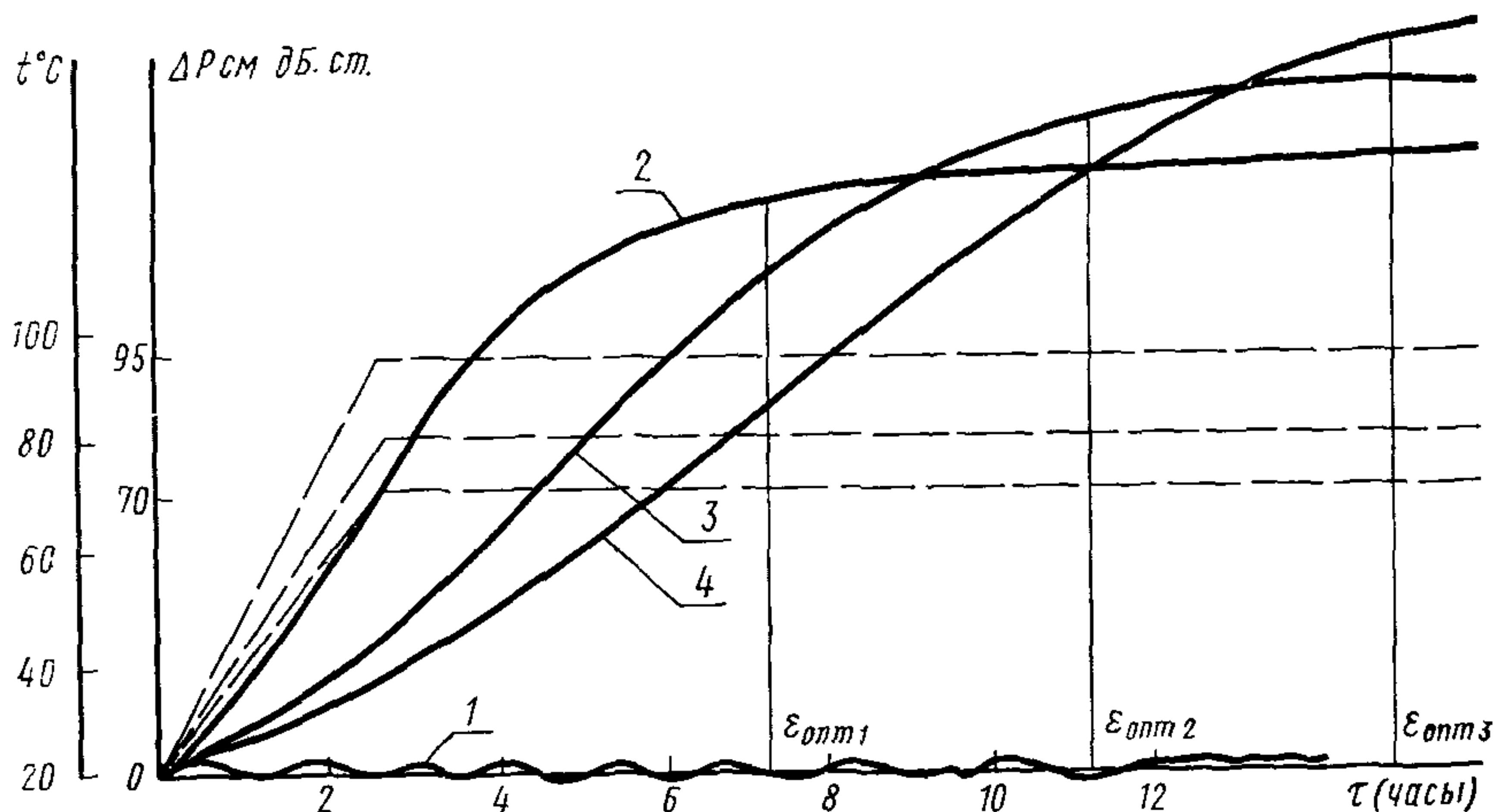
1—кривая «собственного хода» контрактометра; 2, 3, 4—кривые кинетики контракции при температуре изотермии соответственно: 95; 80; 70°C.
