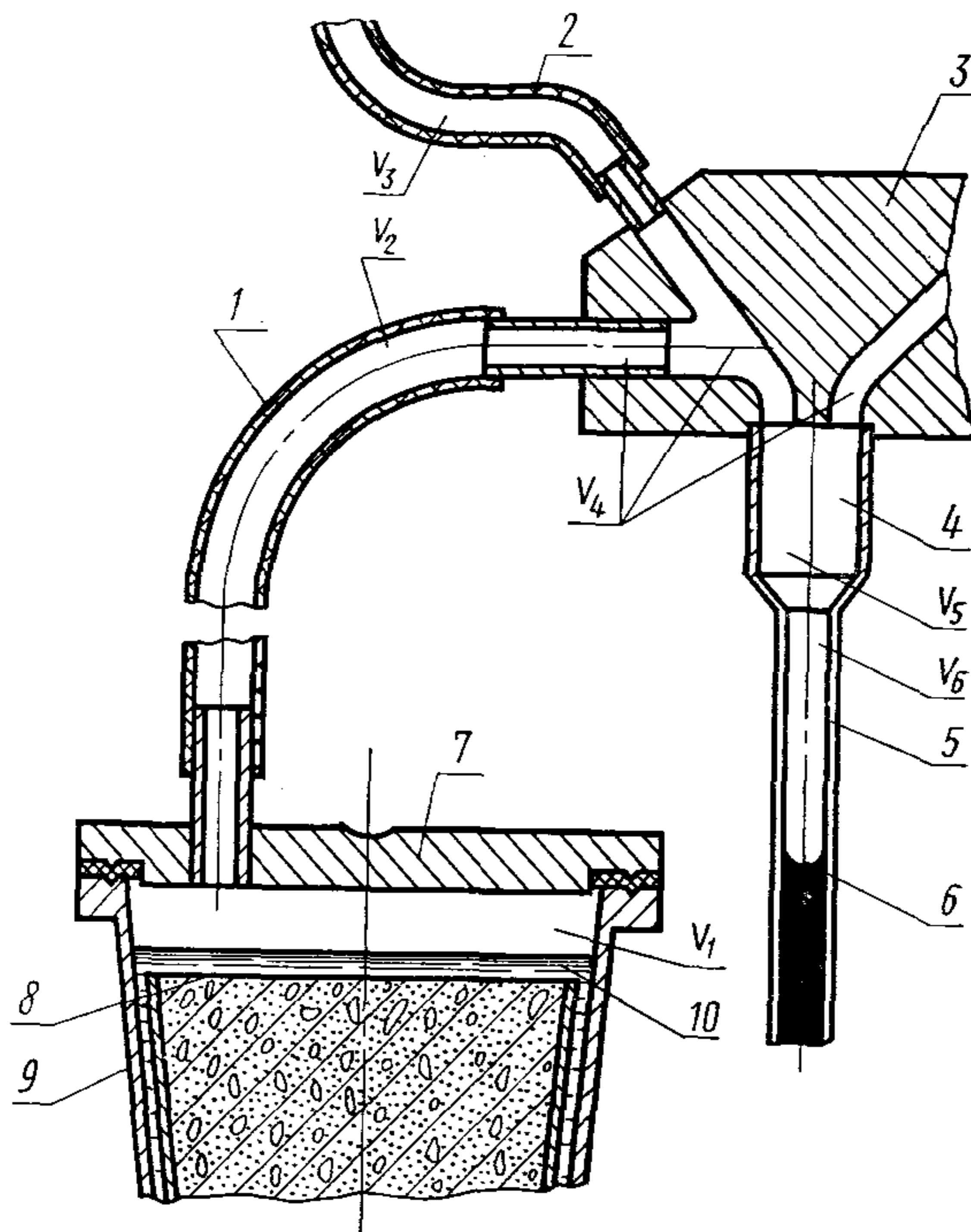
1—соединительный вакуумный шланг; 2—трубка манометра; 3—головка дифманометра; 4—резервная камера; 5—капилляр дифманометра; 6—уровень жидкости в дифманометре; 7—крышка сосуда; 8—уровень смеси; 9—сосуд; 10—вода
