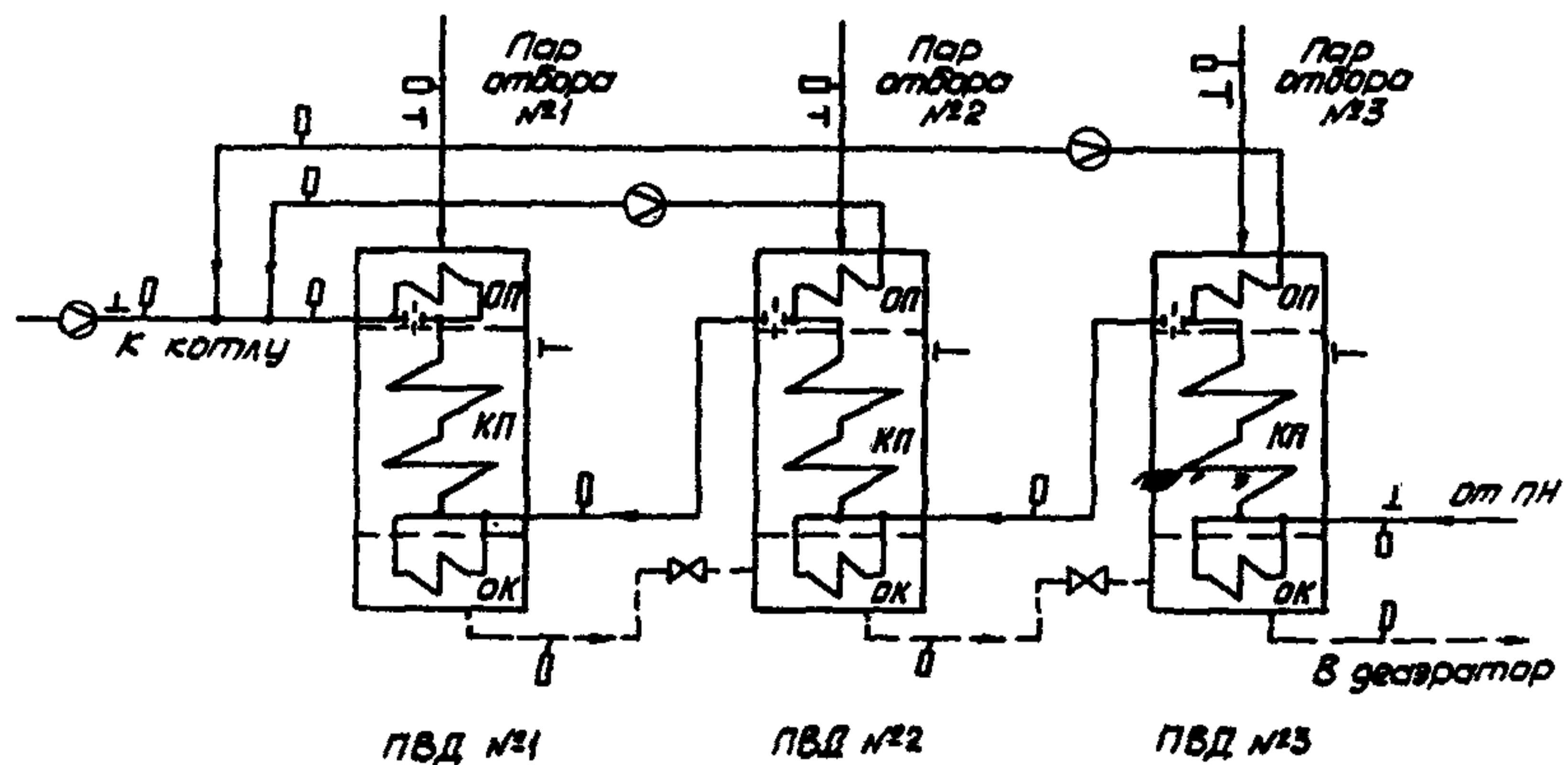
Рис.5. Схема группы ПВД с пароохладителями,ключенными по схеме Рикара-Некольского, с указанием точек измерений при испытании
