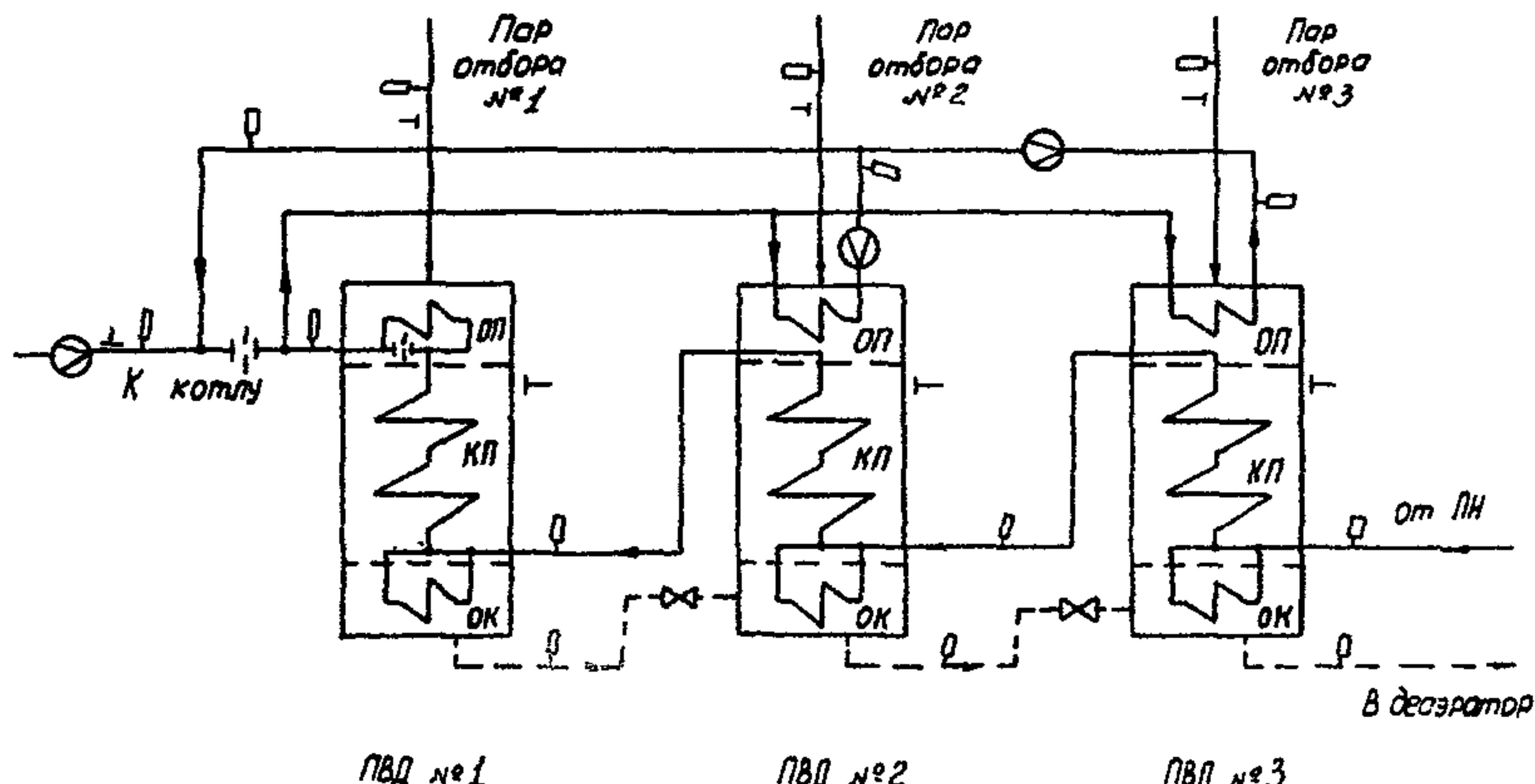
Рис.6. Схема группы ПВД с пароохладителями, включенными по схеме Виолена-Хюльза, с указанием точек измерения при испытании
