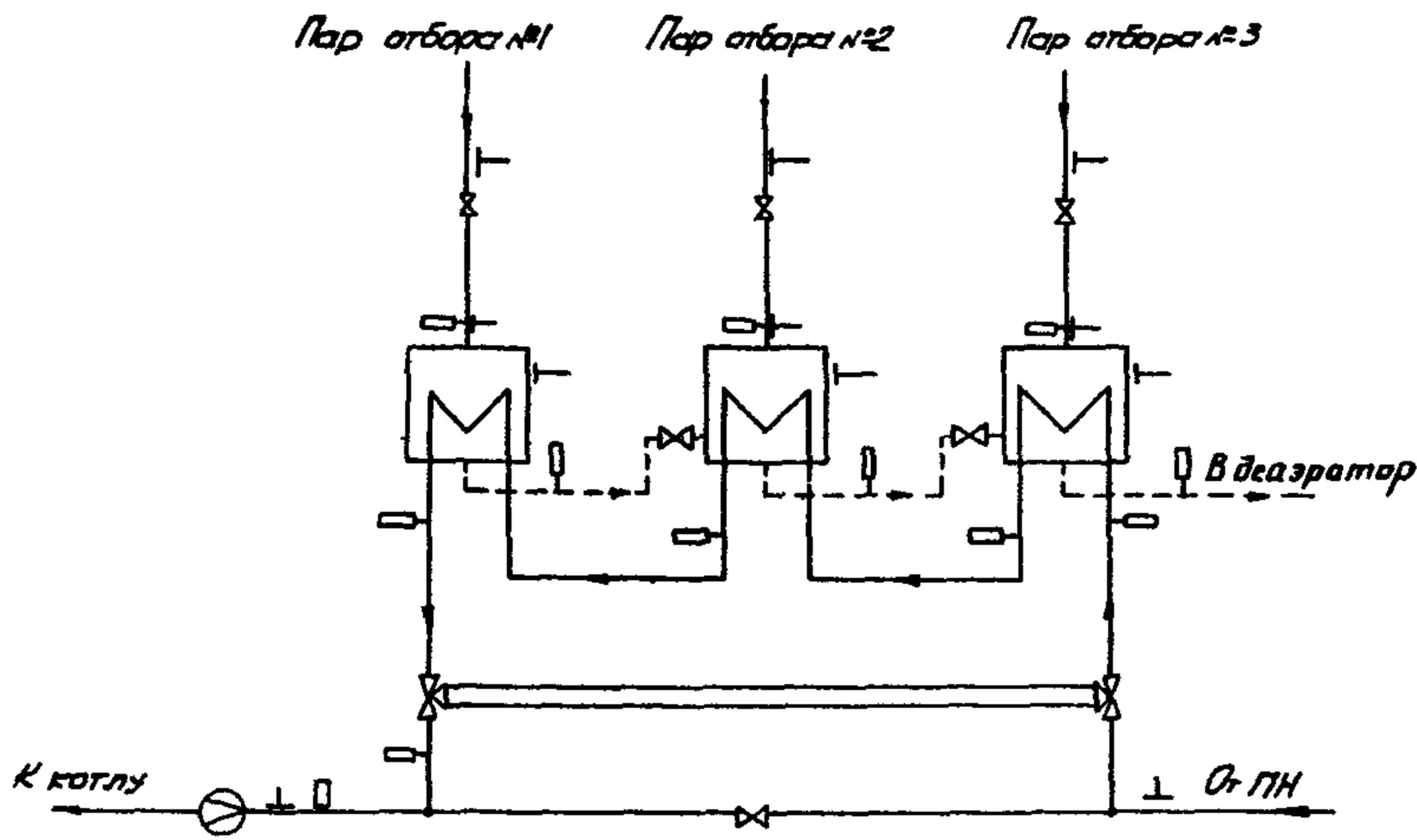
Рис.3. Схема регенерации высокого давления турбоагрегата К-200-І30 с указанием точек измерения при испытании:
