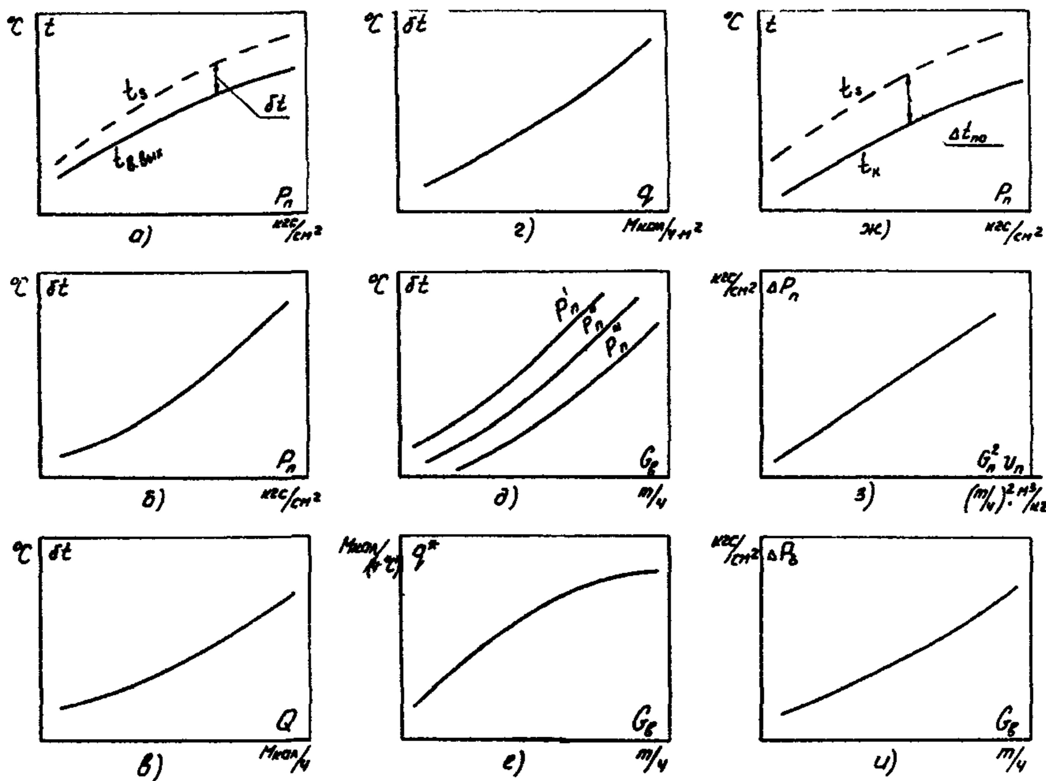
Рис.2. Термовые и гидравлические характеристики подогревателей:
