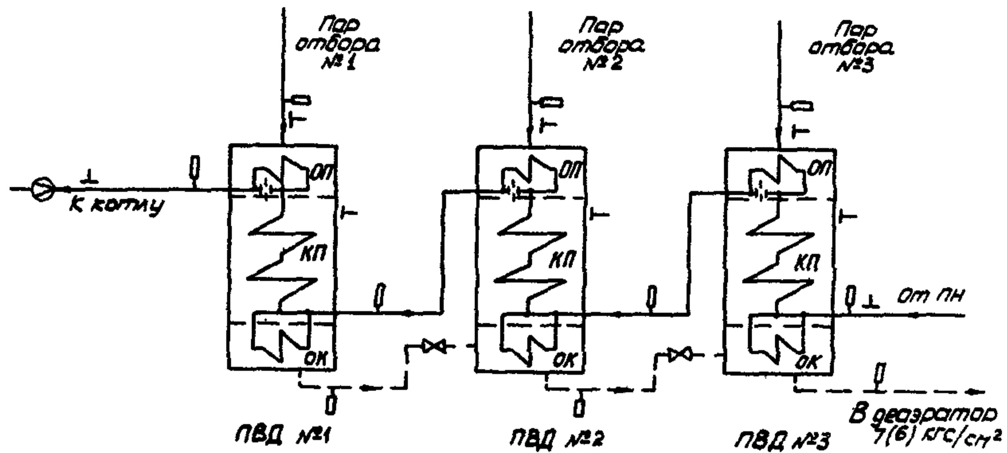
Рис.4. Схема группы ПВД с встроенным пароохладителями с указанием точек измерения при испытании:
