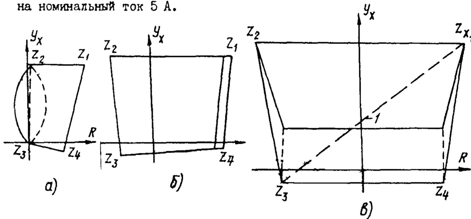
Рис.3. Характеристики реле сопротивления:
