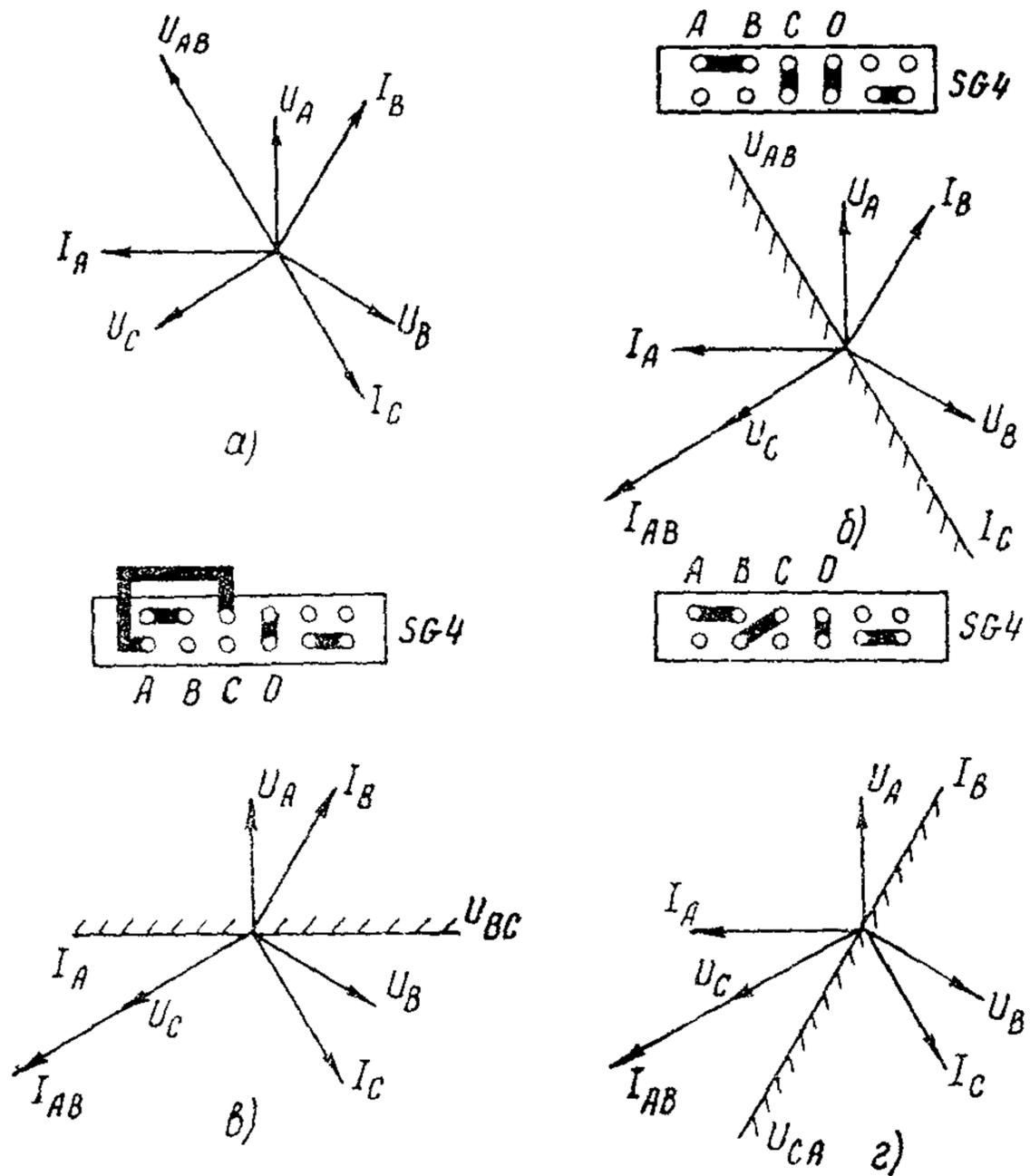
Рис.4. Проверка направленности реле сопротивления  $IPC_{AB}$
