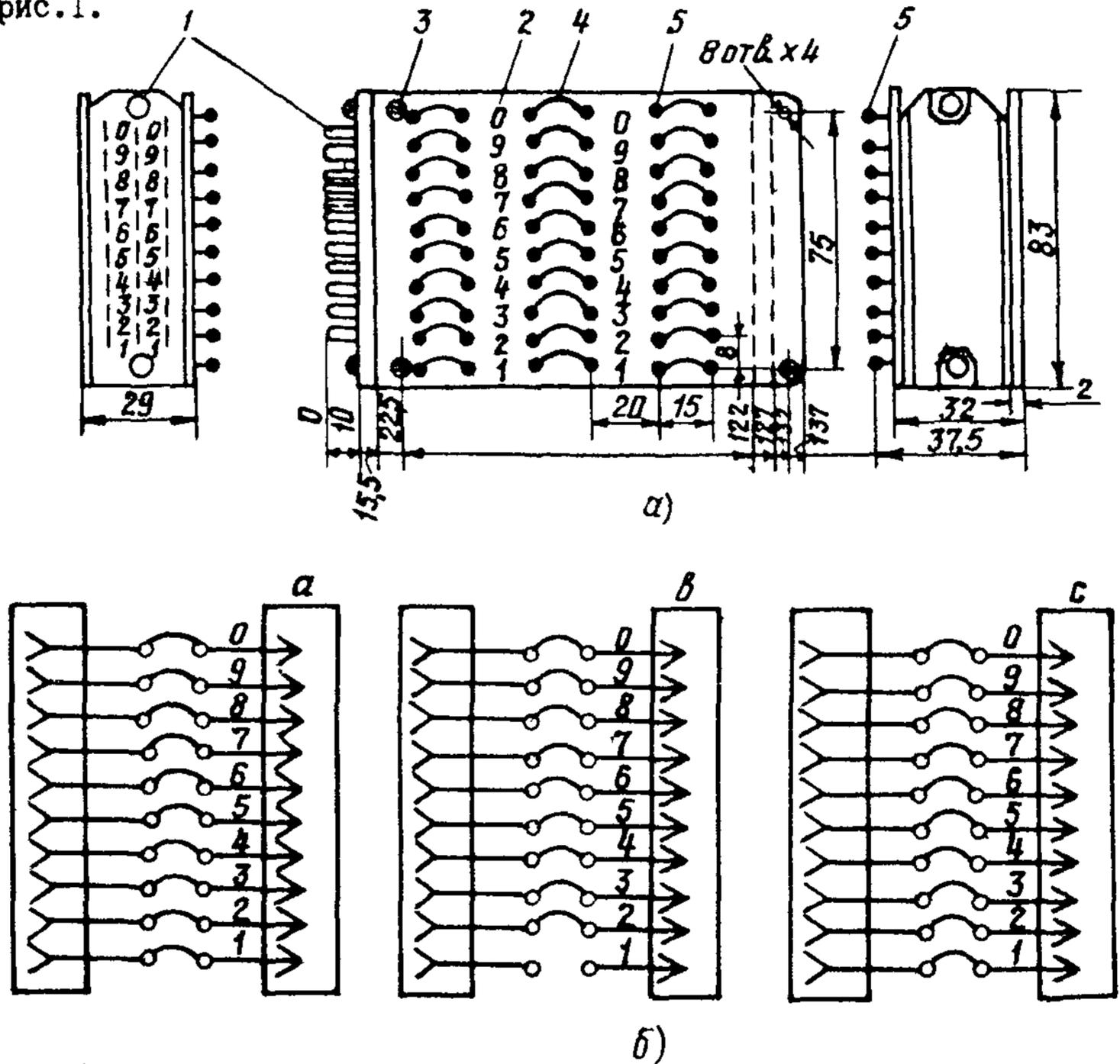
Рис. I. Разделительная колодка для подключения модулей:
