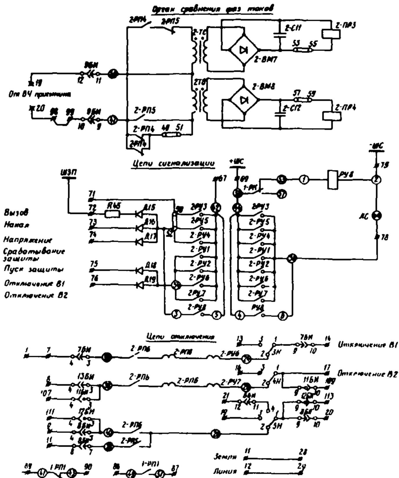
Рис. 2. Цепи постоянного тока защиты ДФЗ-504:
