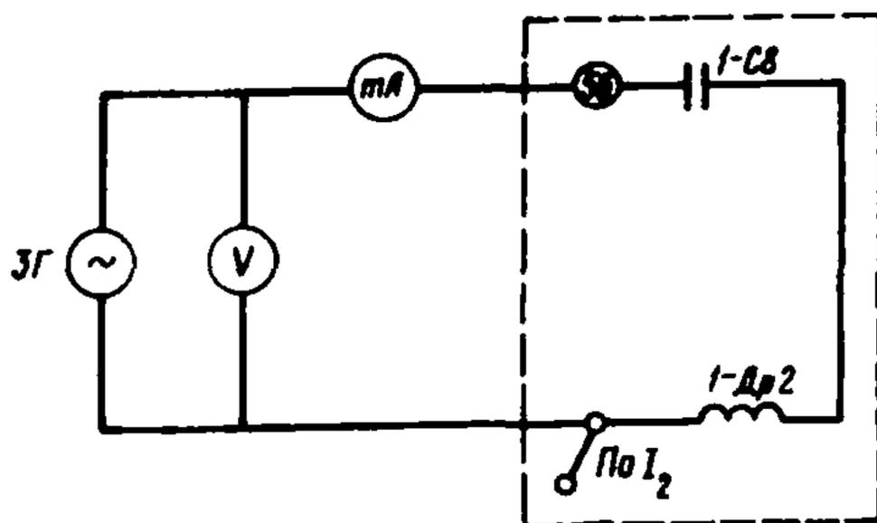
Рис. 5. Схема проверки фильтра первой гармонической составляющей
