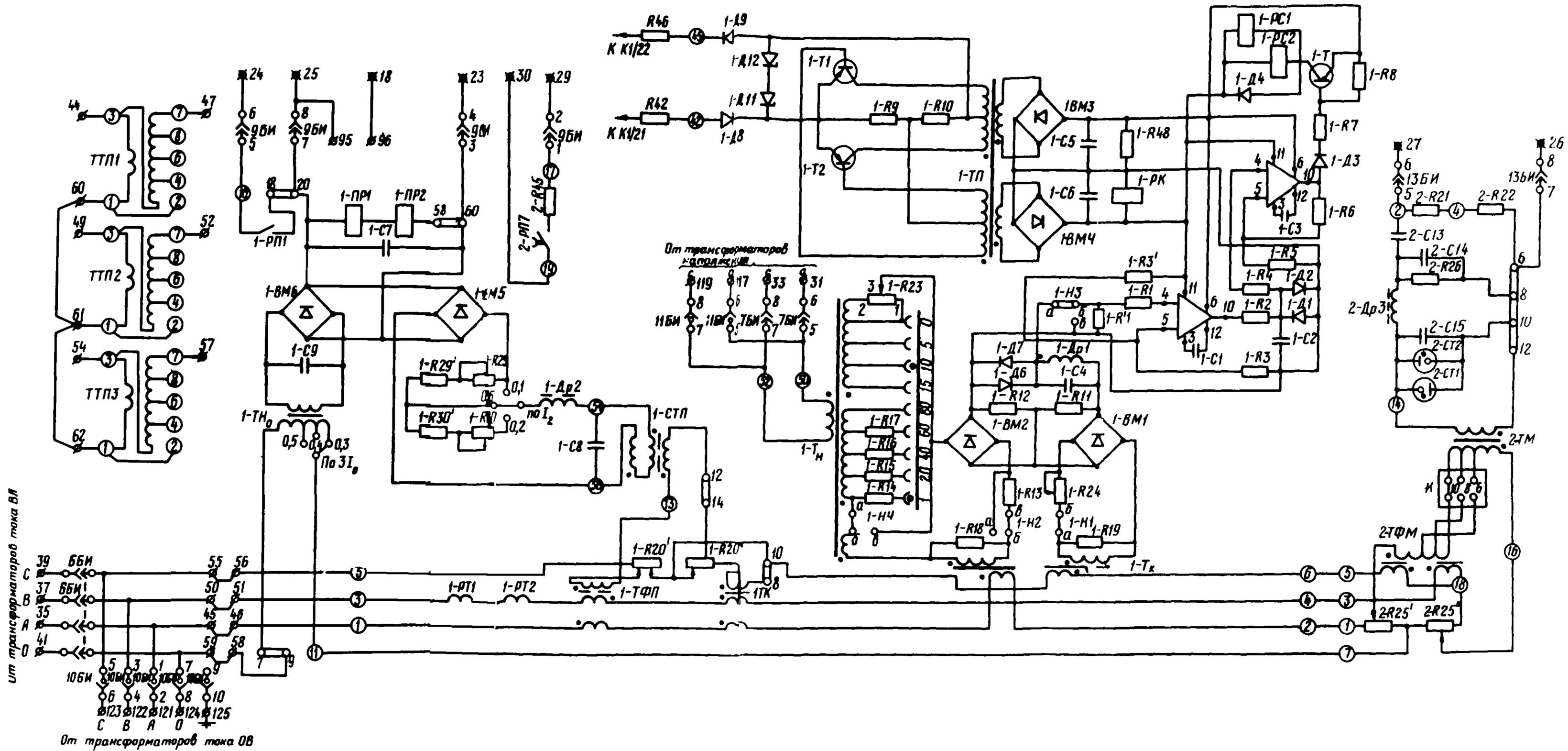
Рис. I. Цели переменного тока и напряжения защиты ДФЗ-504
