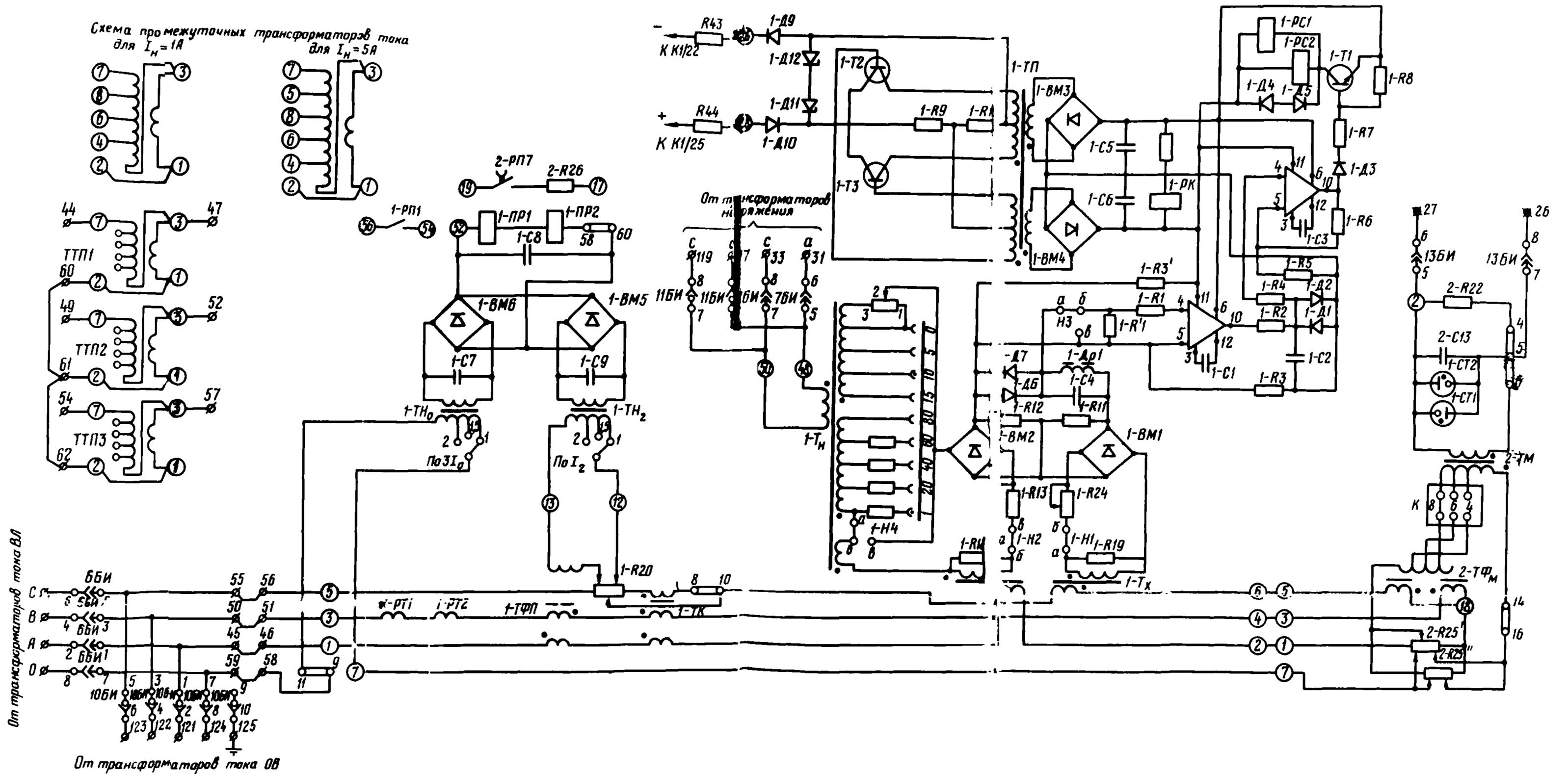
Рис. 3. Цепи переменного тока и напряжения защиты ДСЗ-201
