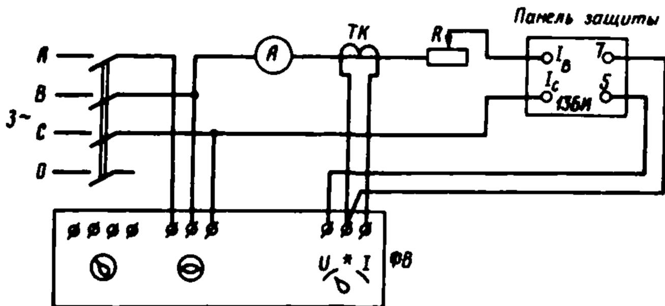
Рис.7. Схема измерения угла между векторами тока  $I_{BC}$  на входе панели и напряжения  $U_U$  на выходе органа управления:
