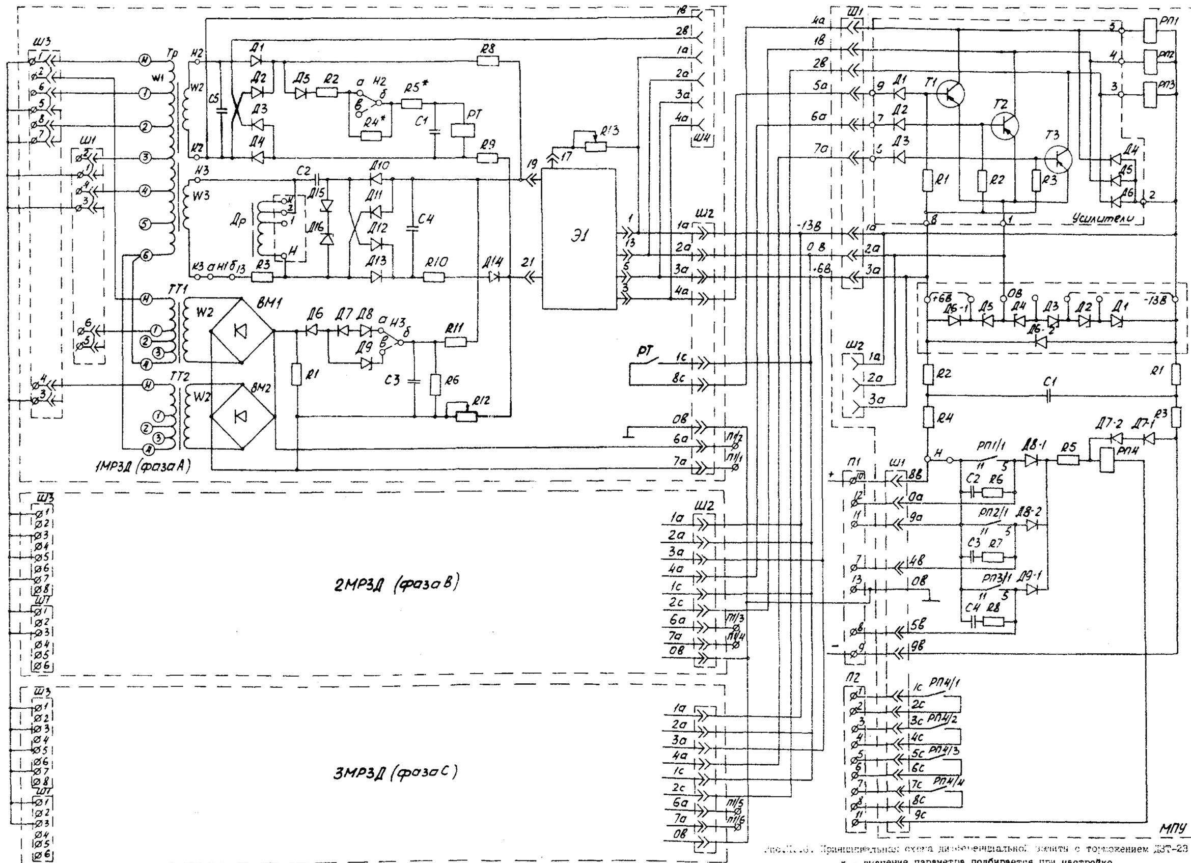
Рис. 1.6. Принципиальная схема дифференциальной ячейки с торможением ДЭТ-23
