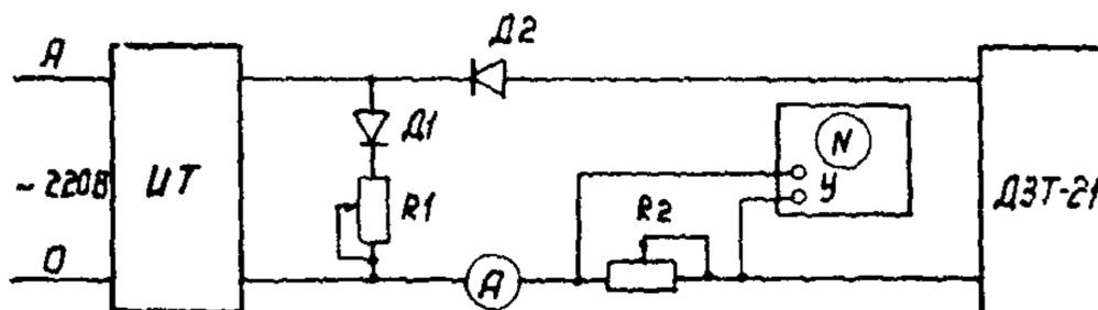
Рис. Пб.1. Схема проверки отстройки защиты от бросков намагничивающего тока с апериодической составляющей:
