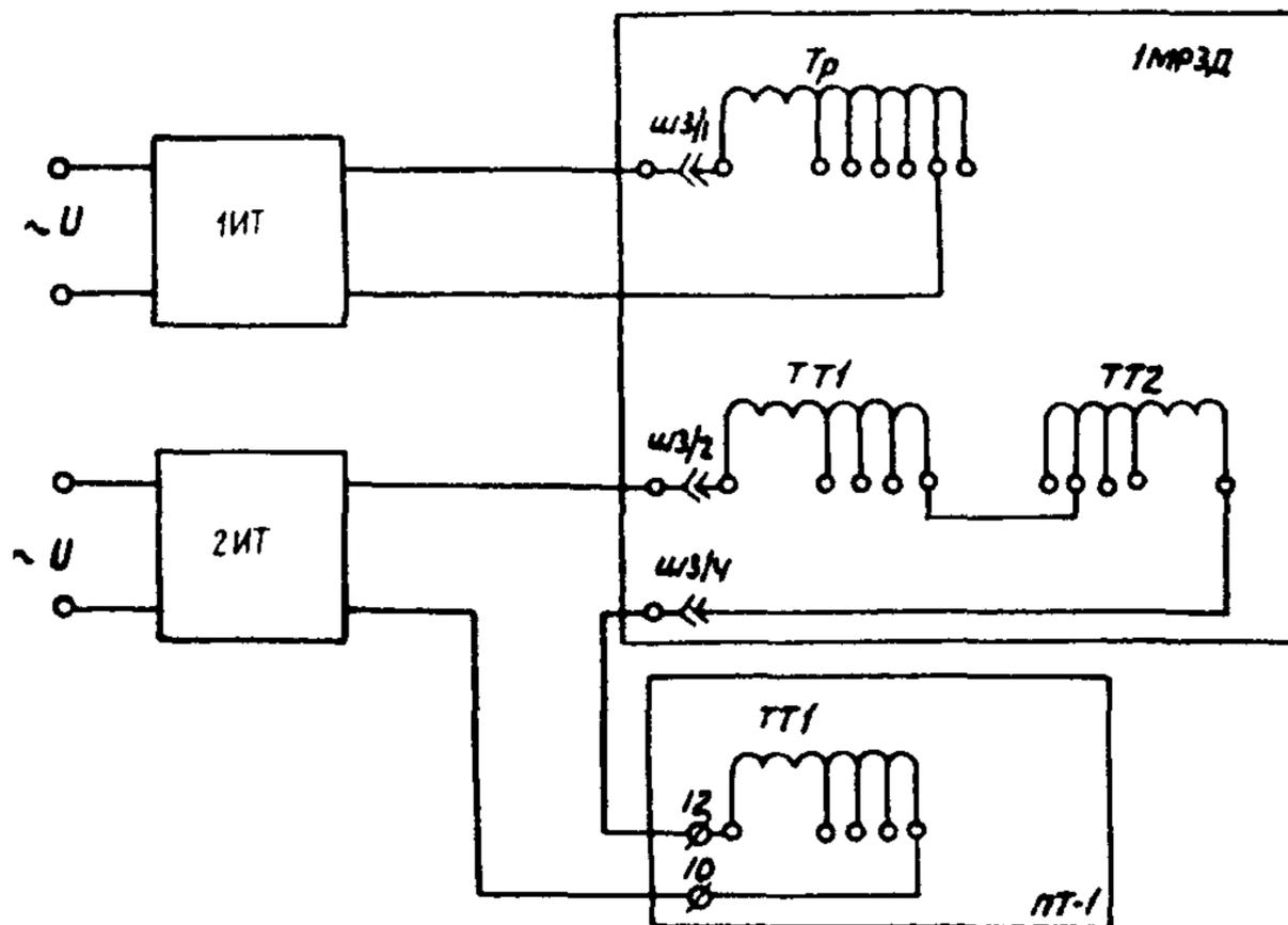
Рис.6.4. Схема проверки тормозных характеристик МРЗД:
