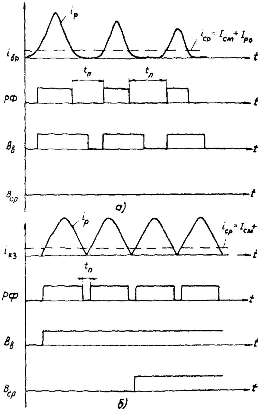
Рис. III.3. Временные диаграммы работы реагирующего органа защиты ДЗТ-21, ДЗТ-23 ( $I_{см} = I_{T1} + I_{T2}, I_{рo}$  - ток срабатывания РО при отсутствии смещения):
