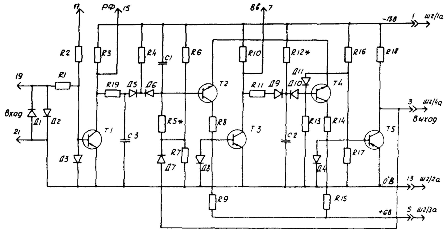
Рис. III.9. Принципиальная схема реагирующего органа;
