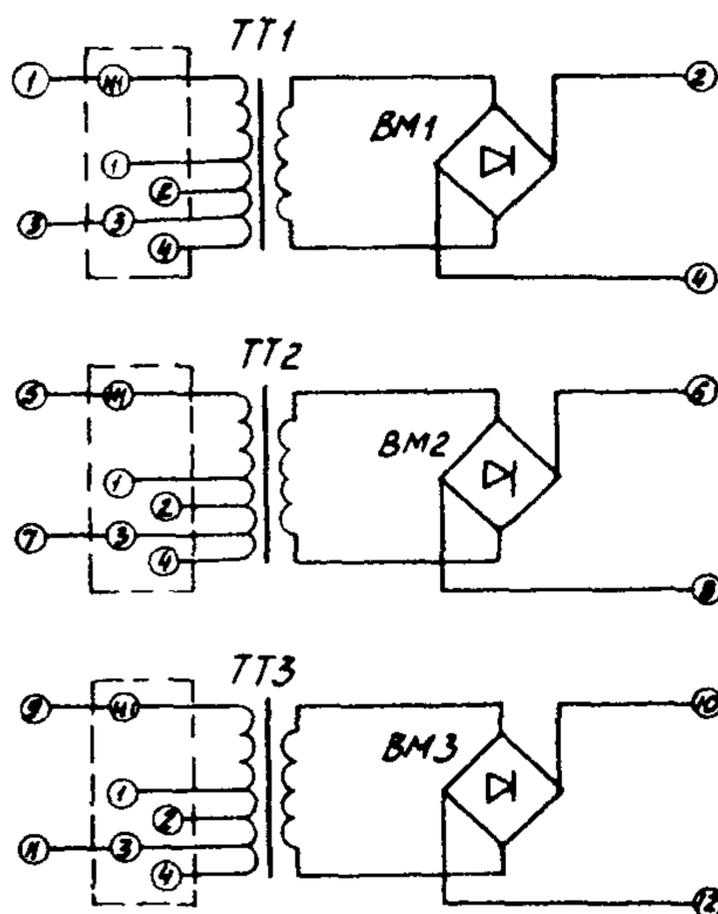
Рис. П2.1. Схема приставки дополнительного торможения ПТ-1
