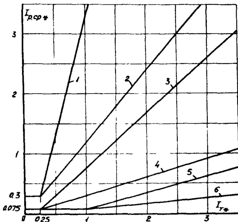
Рис. П5.1. Тормозные характеристики реле ДЭТ-21 (ДЭТ-23) при изменении диапазона регулирования уставок ( $I_{р.ож} = 0,8$ ;  $I_{т.ож} = 1$ ):
