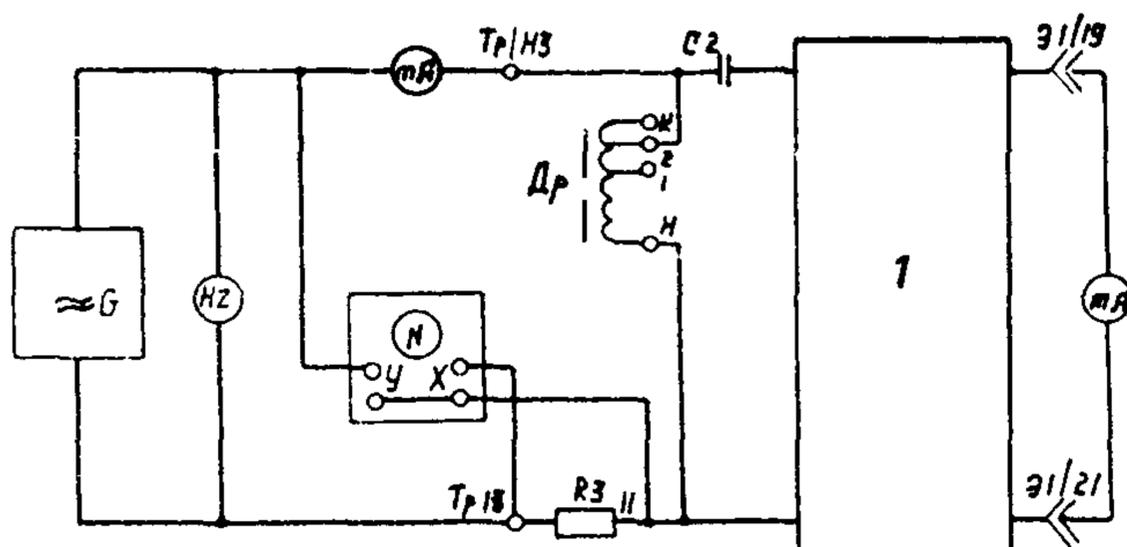
Рис.6.1. Схема настройки фильтра второй гармонической составляющей:
