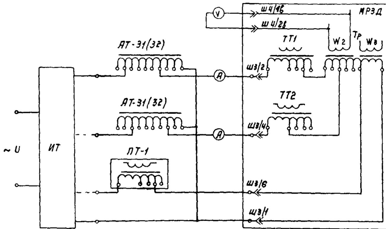
Рис. 6.3. Схема проверки токов срабатывания МРЗД:
