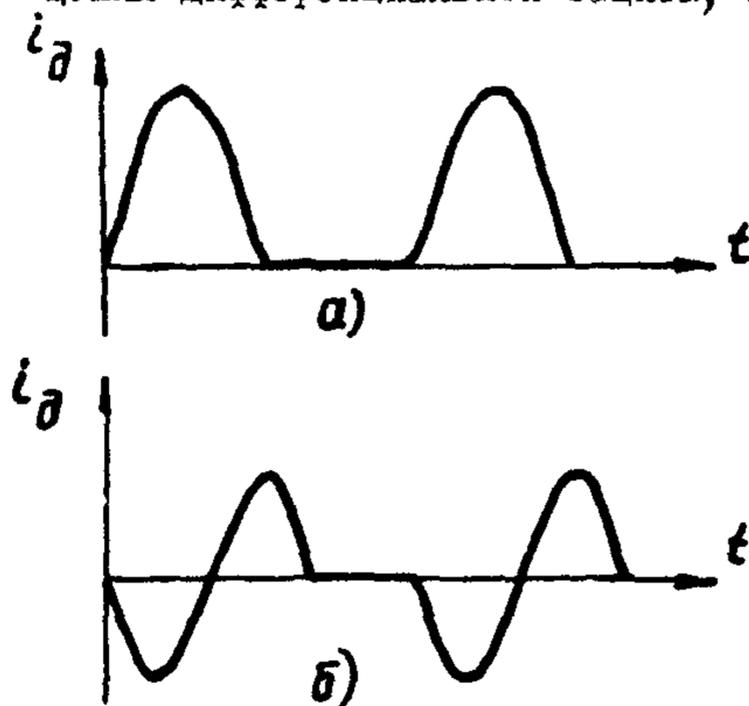
Рис. III.1. Кривые бросков намагничивающего тока силового трансформатора, протекающего в цепях дифференциальной защиты:
