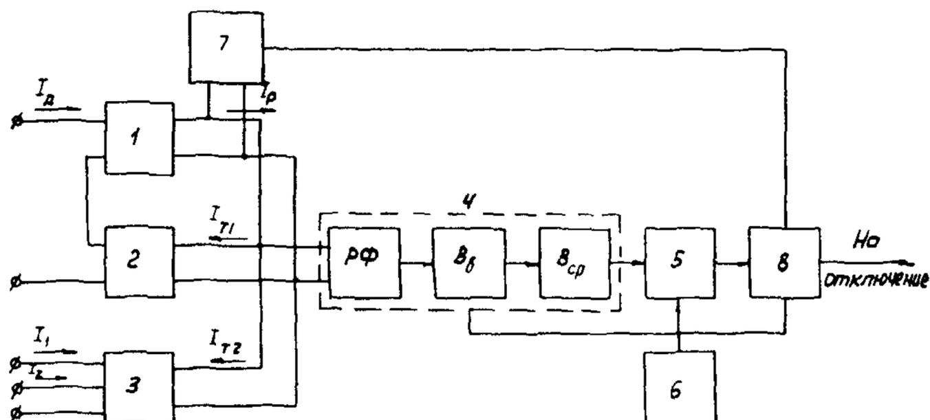
Рис. П1.2. Структурная схема защиты ДЗТ-21, ДЗТ-23
