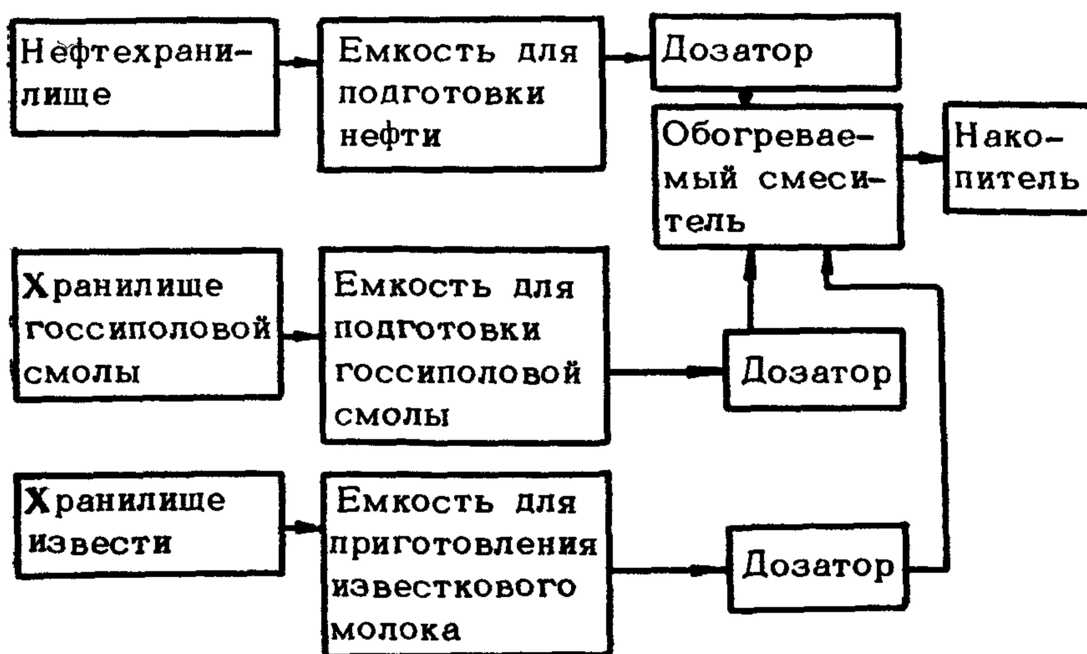
Технологическая схема приготовления комплексного органического вяжущего
