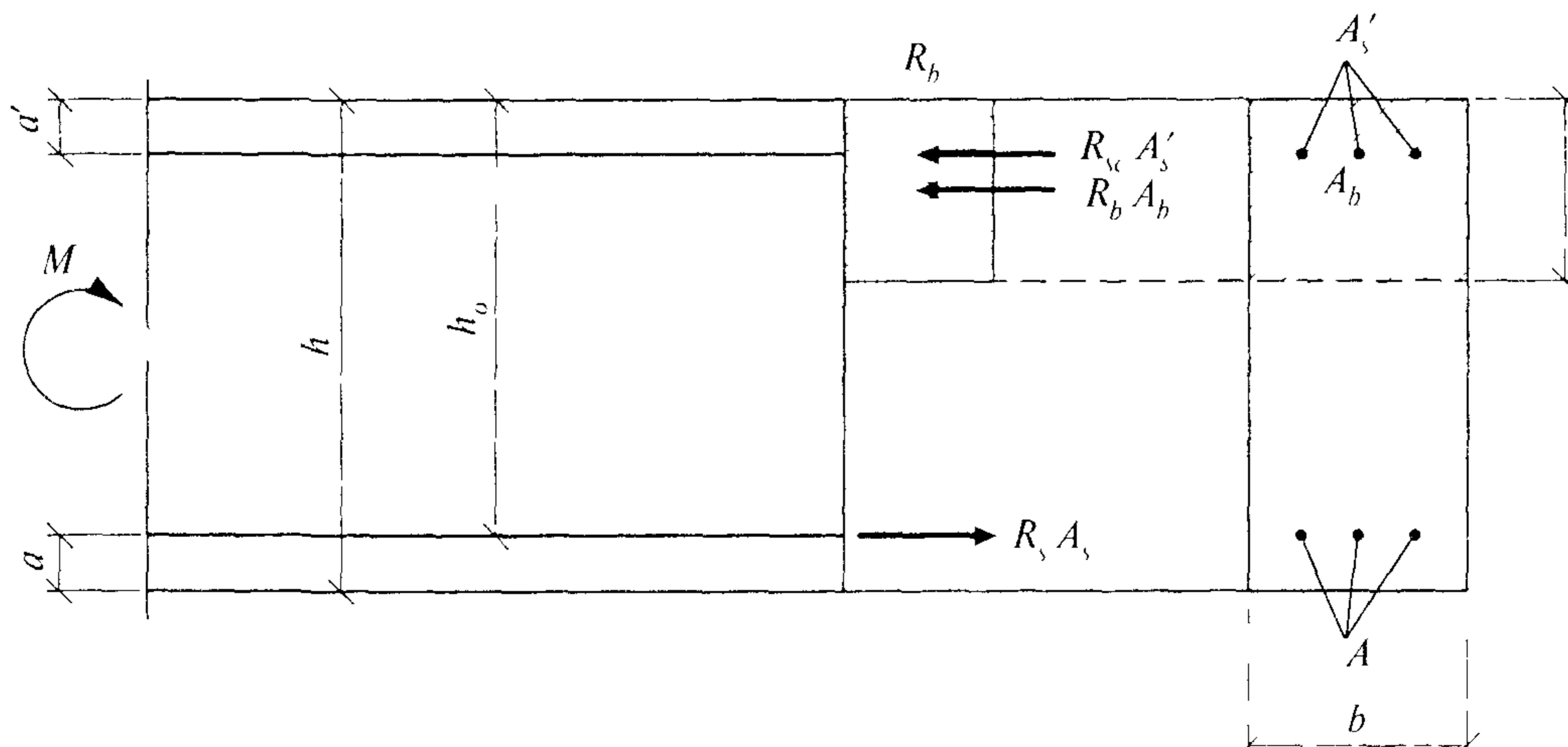
**Рисунок 3** — Схема усилий и эпюра напряжений в сечении, нормальному к продольной оси изгибающего предварительно напряженного элемента при его расчете по прочности
