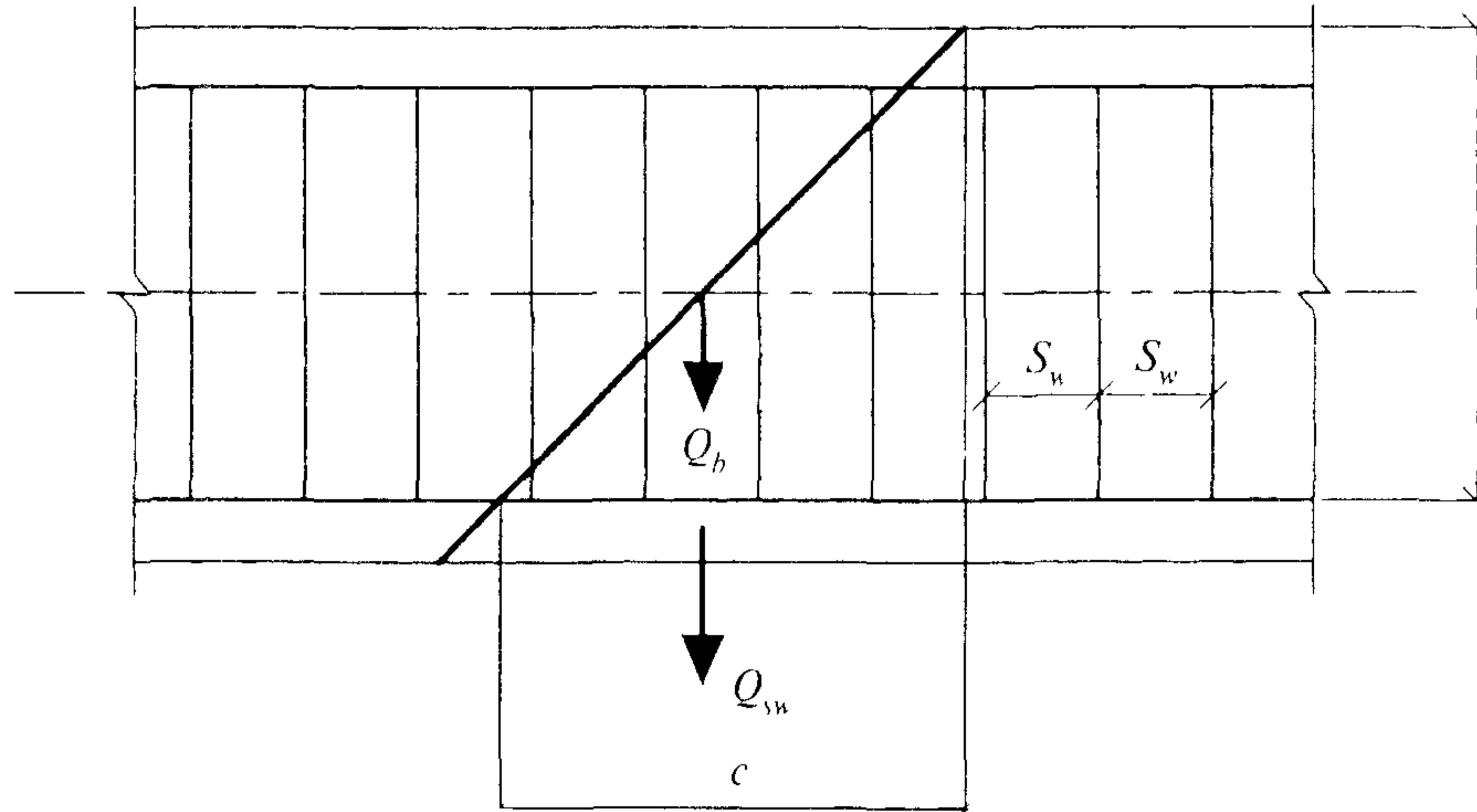
**Рисунок 7** — Схема усилий при расчете изгибающихся предварительно напряженных элементов по наклонному сечению на действие поперечных сил
