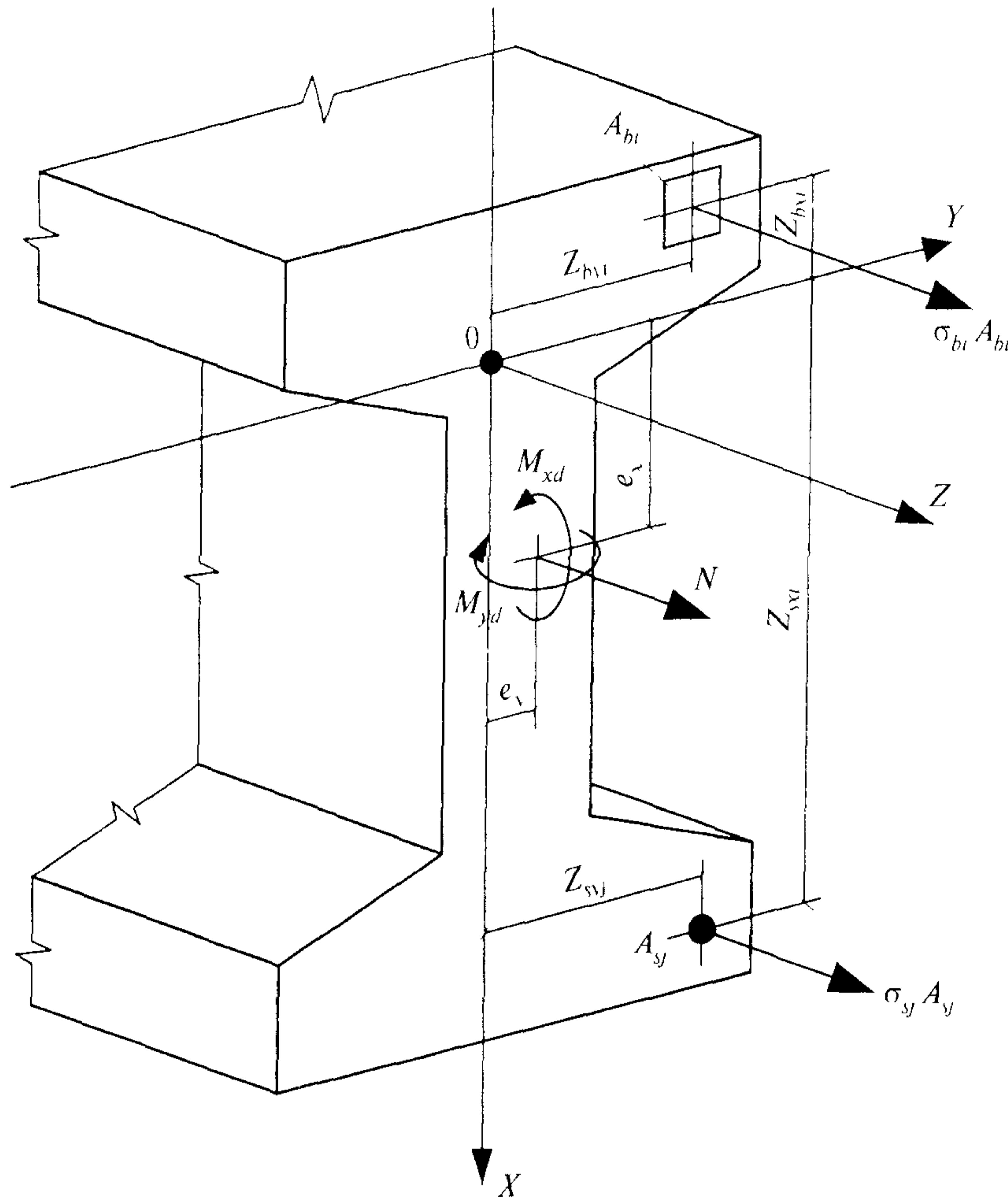
**Рисунок 6 —** Расчетная схема нормального сечения
