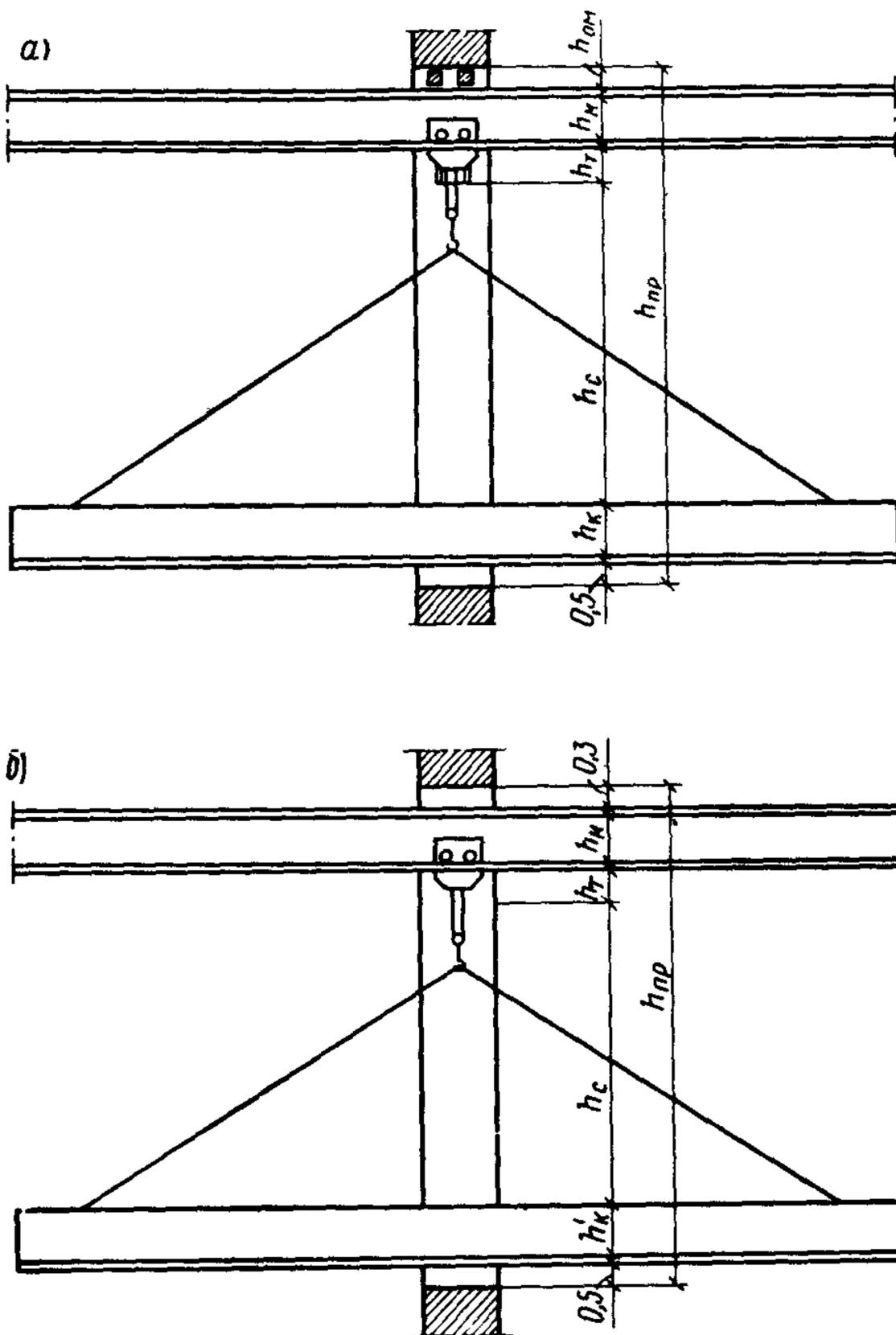
Рис. 19. Перемещение строительных конструкций через оконные проемы
