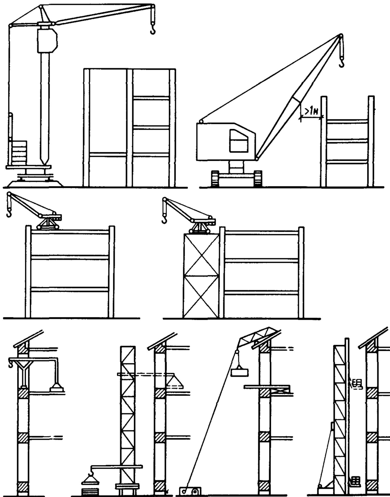
Рис. 20. Схемы установки подъемно-транспортного оборудования, применяемого при реконструкции
