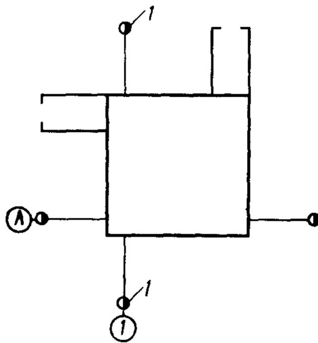
Рис. 14. Схема закрепления основных разбивочных осей цеха размером 30 X 30 м
