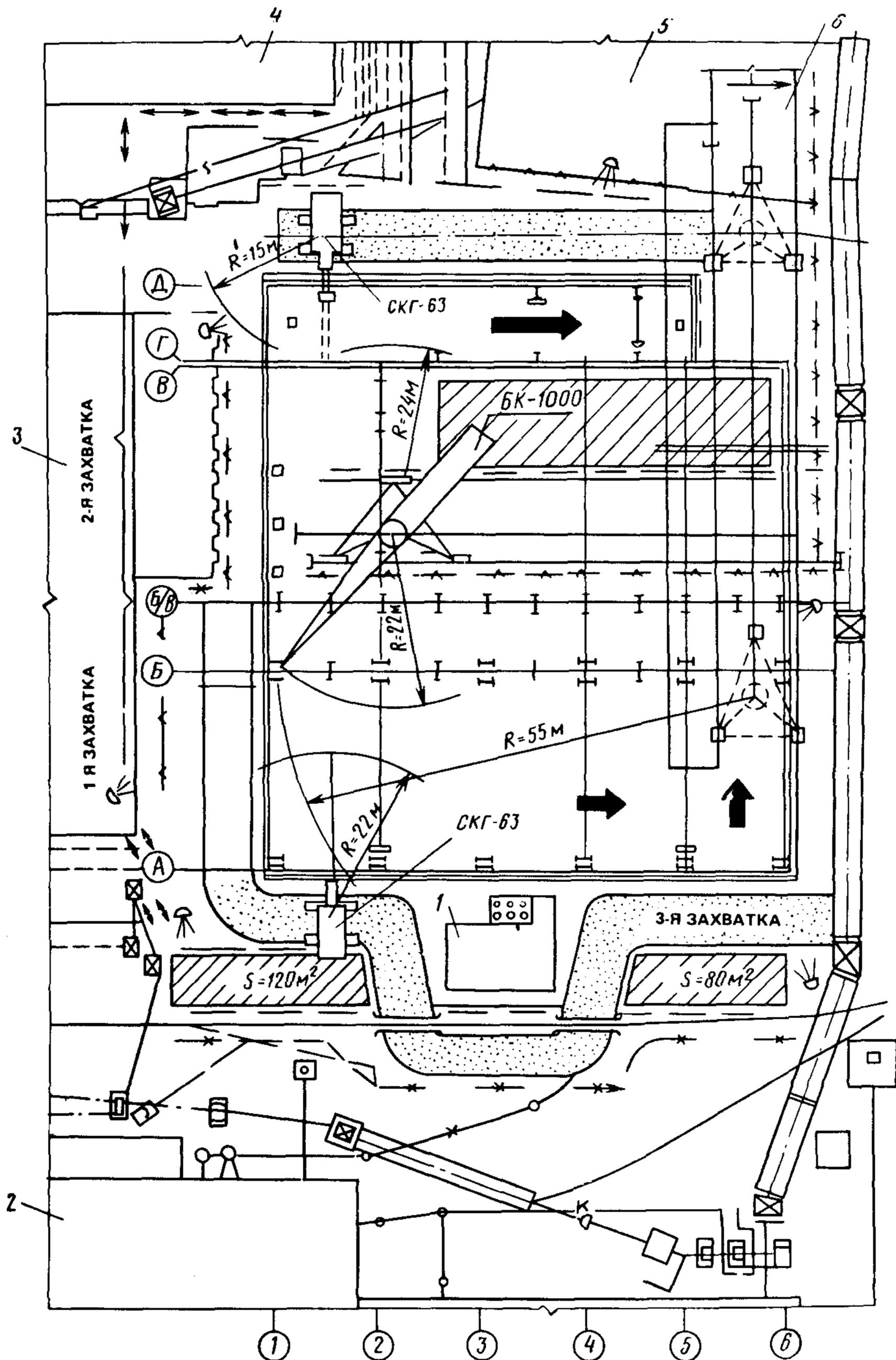
зуются существующие и временные внутризаводские автодороги. Погрузочно-разгрузочные работы на приобъектном складе предполагается производить гусеничным краном МКГ-25.
