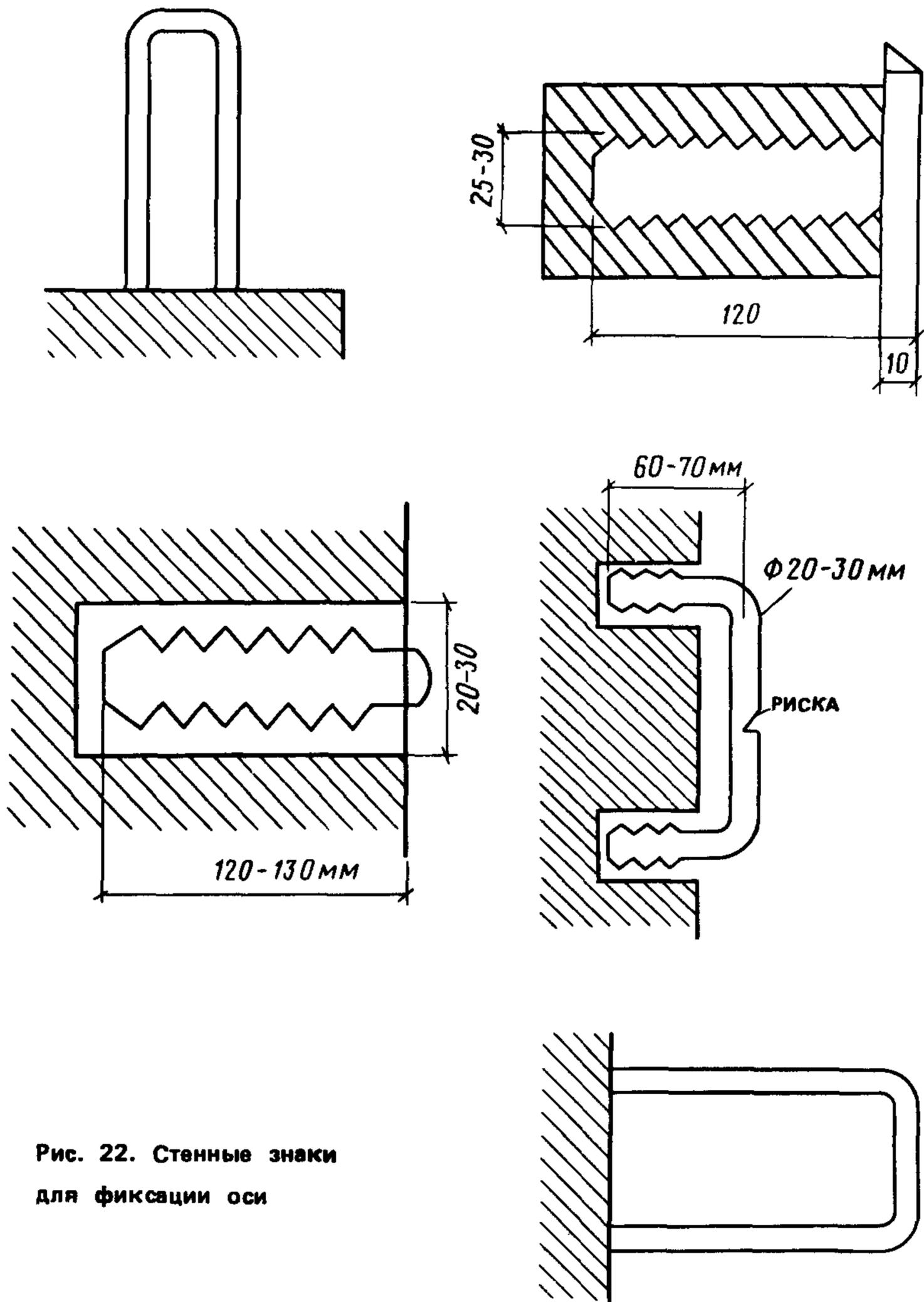
Рис. 22. Стенные знаки для фиксации оси
