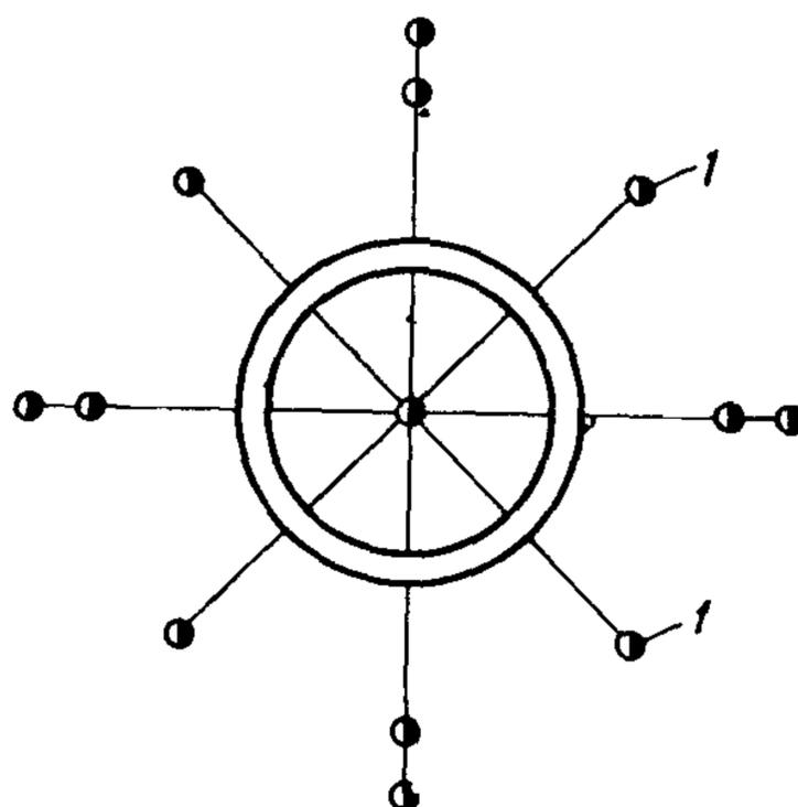
Рис. 15. Схема закрепления главных разбивочных осей сооружений башенного типа
