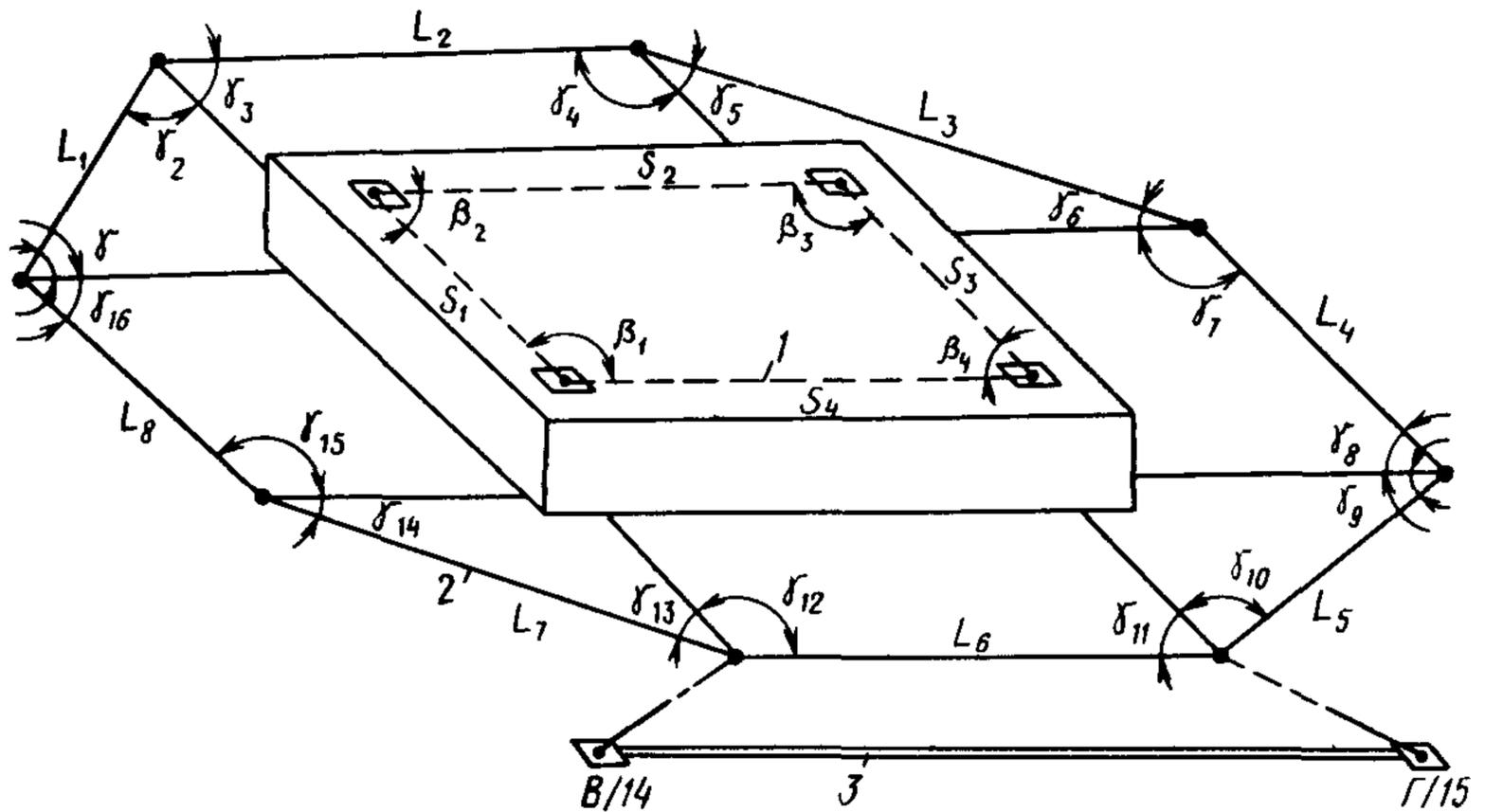
**Рис. 21. Схема построения локальной разбивочной основы**
