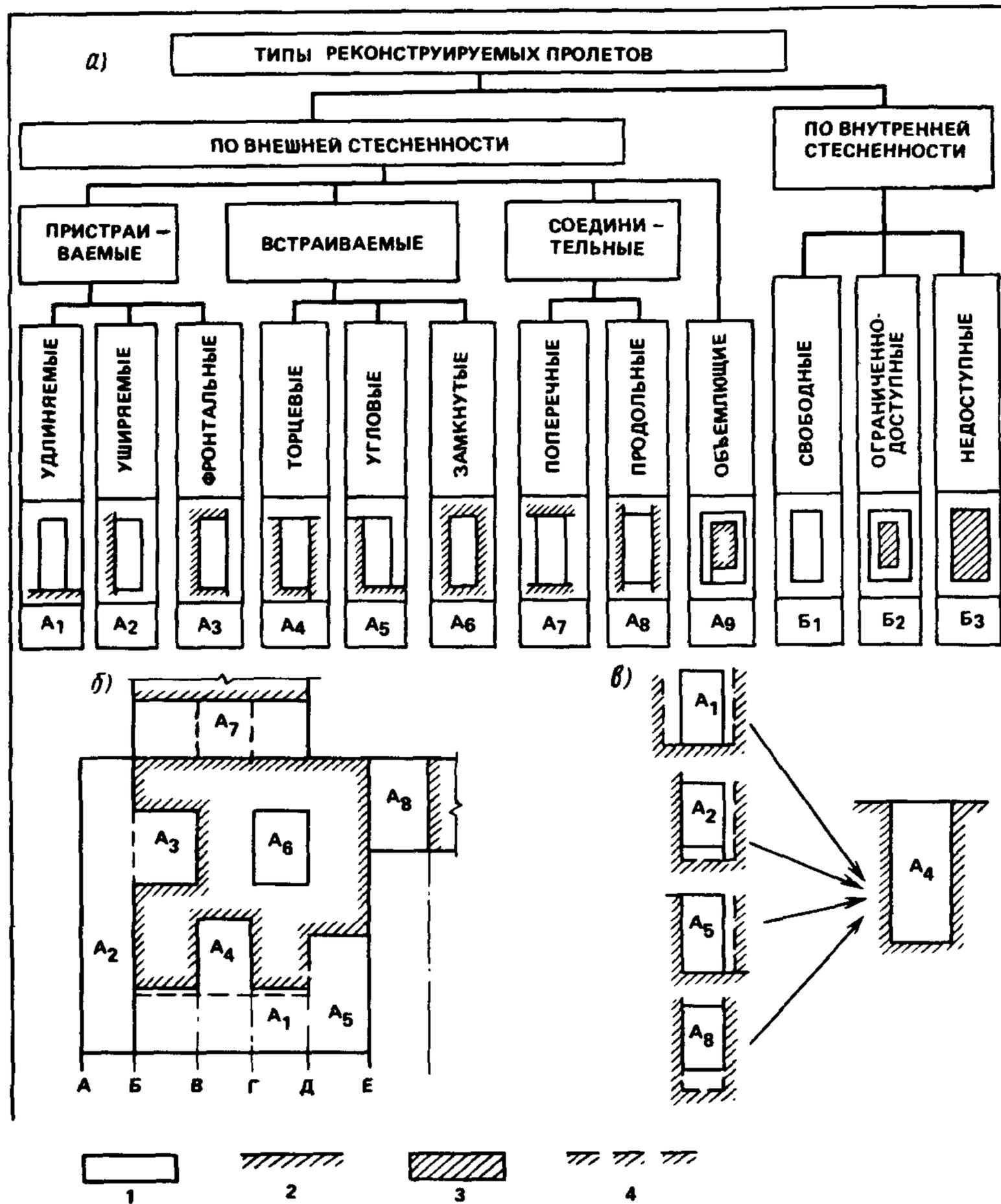
**Рис. 3. Типы пролетов, возводимых при реконструкции одноэтажных промзданий**
