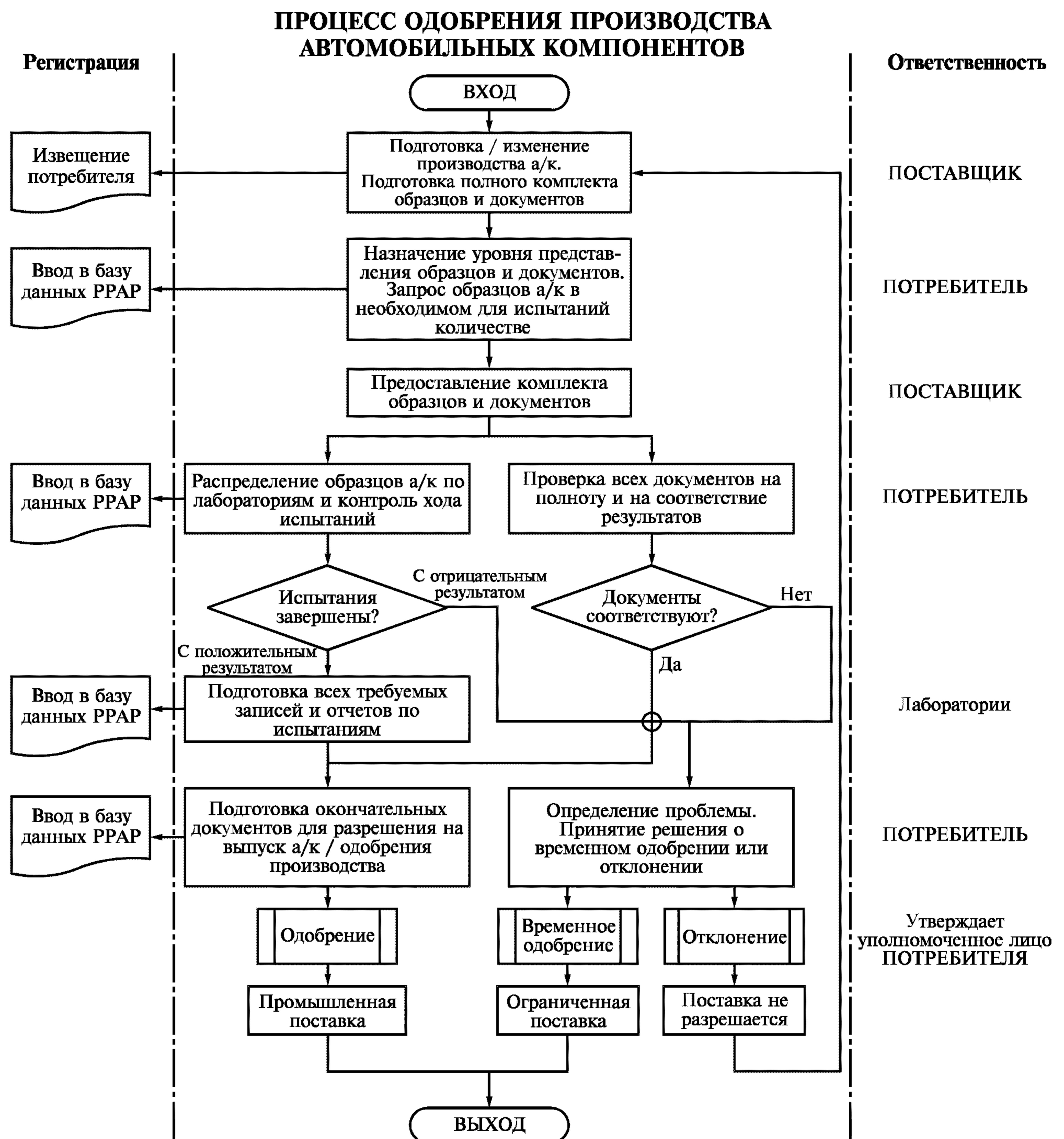
Рисунок 1 — Схема одобрения производства автомобильных компонентов
