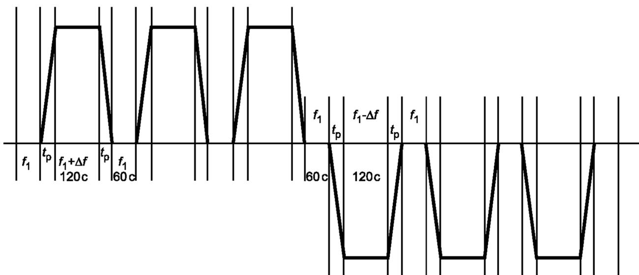
Рисунок 1 — Последовательность изменений частоты
