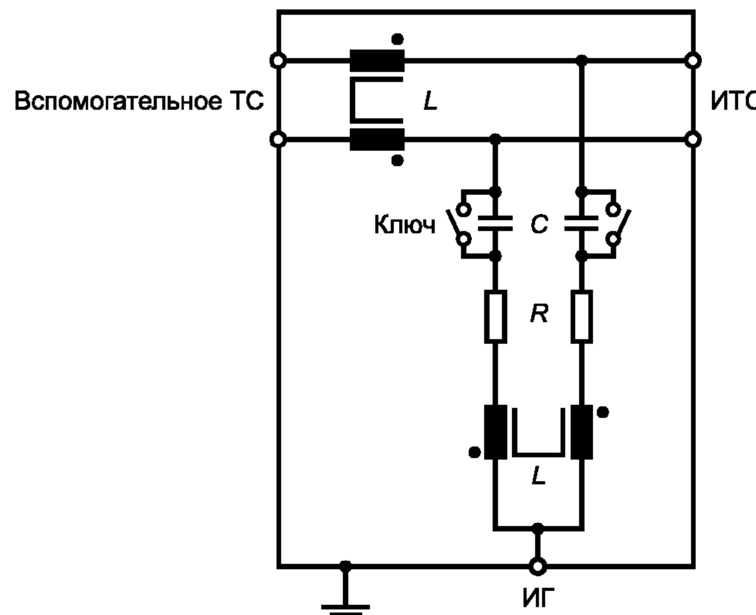
**П р и м е ч а н и е** —  $R = 200 \text{ Ом}$ ;  $C = 4,7 \text{ мкФ}$  (конденсатор должен быть закорочен при подаче помехи постоянного тока);  $L=2,38 \text{ мГн}$  (бифилярная обмотка)
