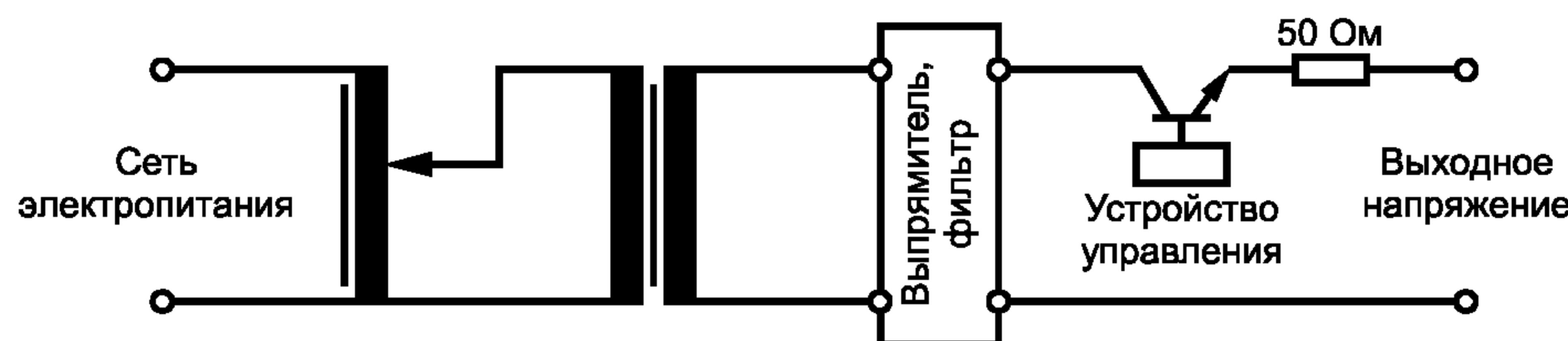
Рисунок 3 — Схема ИГ помех постоянного тока
