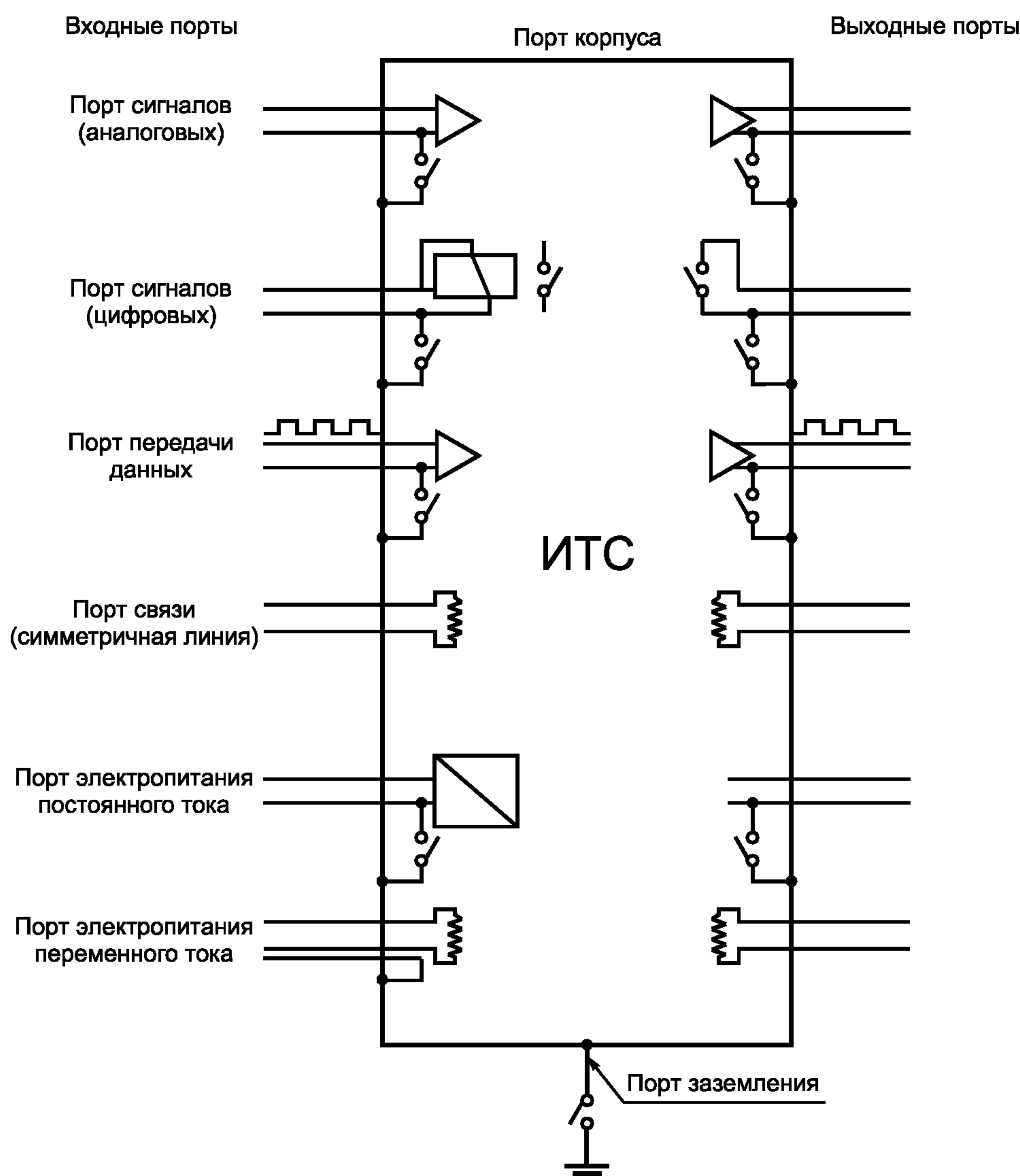
П р и м е ч а н и е — Положения ключей относятся к различной конфигурации портов ТС
