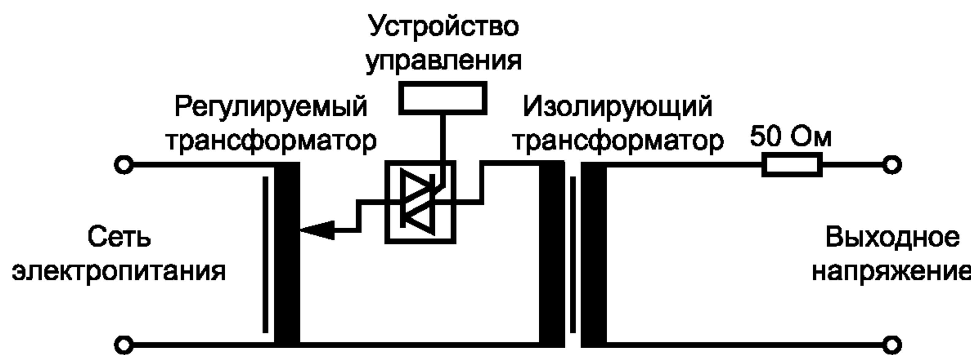
Рисунок 4 — Схема ИГ помех на частоте 50 Гц
