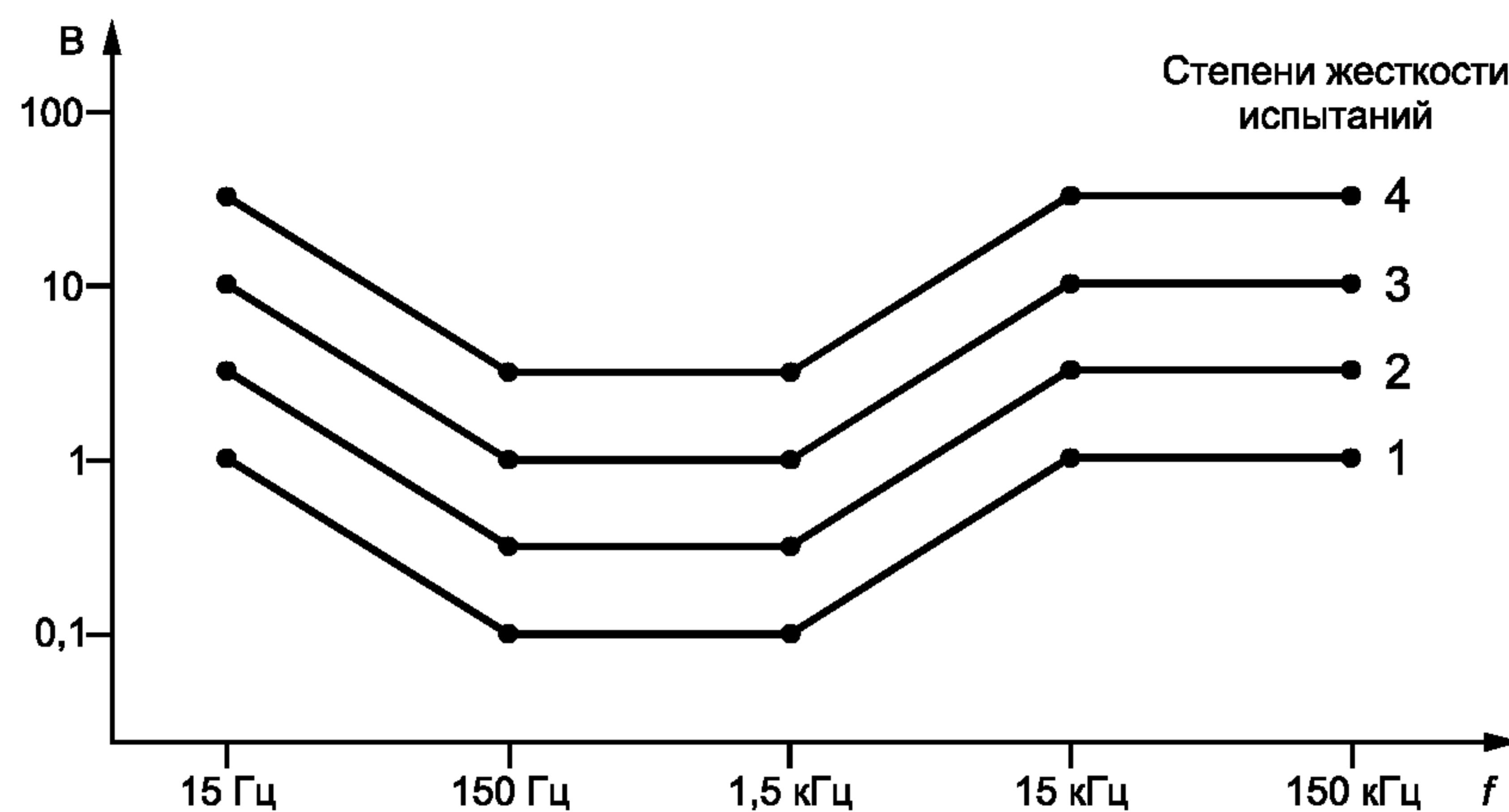
Рисунок 2 — Зависимость испытательного напряжения от частоты
