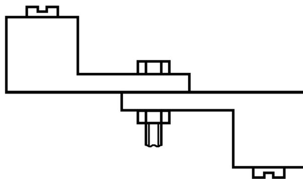
П р и м е ч а н и е — Токопроводящую деталь присоединяют болтами, пайкой или сваркой
