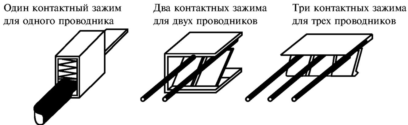
Рисунок F.6 — Примеры безвинтовых контактных зажимов
