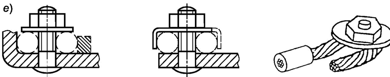
Рисунок F.2 — Косвенный зажим с помощью промежуточной детали неподготовленных проводников
