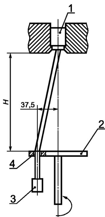
1 — зажимное устройство; 2 — плита; 3 — груз; 4 — втулка; допуск на размер  $H \dots \pm 15$  мм
