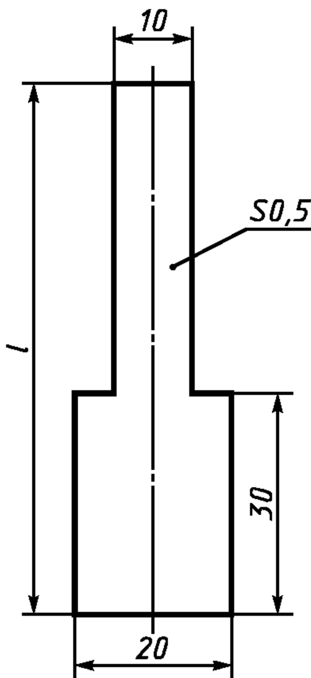
П р и м е ч а н и е — Размер  $l$  выбирают в зависимости от устройства электрохимической ячейки
