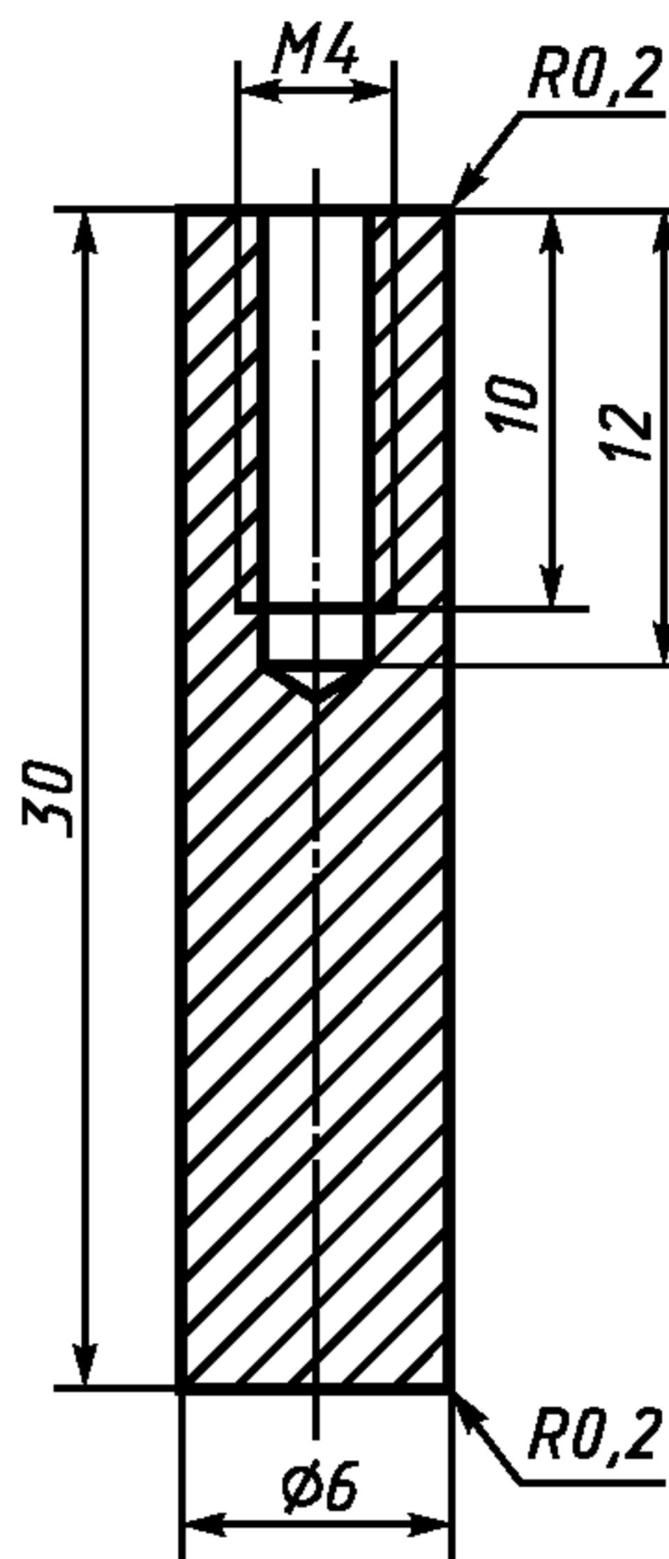
Рисунок А.2 — Цилиндрический образец
