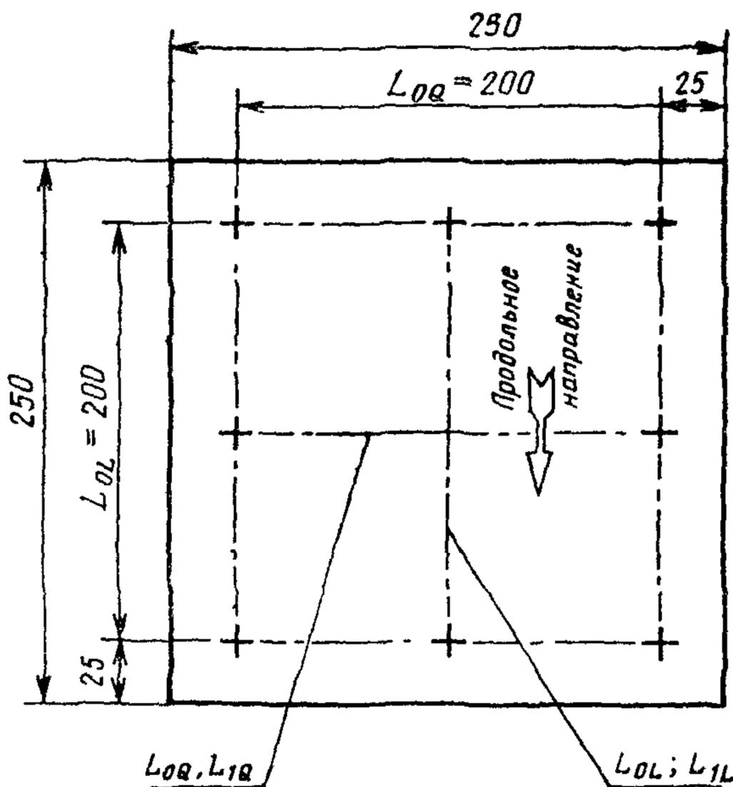
$I_{0Q}$  — расстояние между метками в поперечном направлении до обработки, мм;  $L_{0L}$  — расстояние между метками в продольном направлении до обработки, мм;  $L_{1Q}$  — расстояние между метками в поперечном направлении после обработки, мм;  $L_{1L}$  — расстояние между метками в продольном направлении после обработки, мм.
