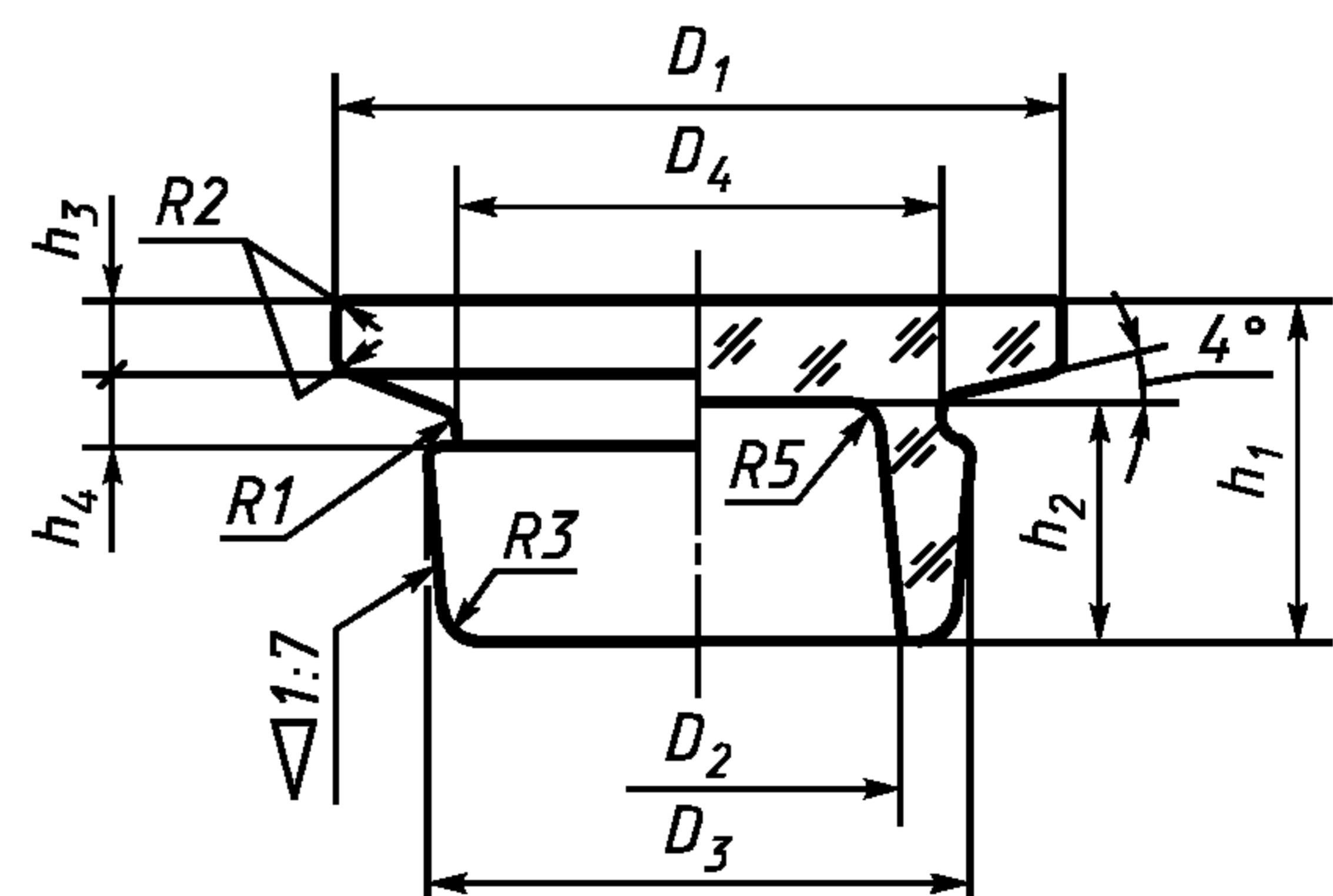
Контролируемый размер пробки, мм, —  $D_3$ .
