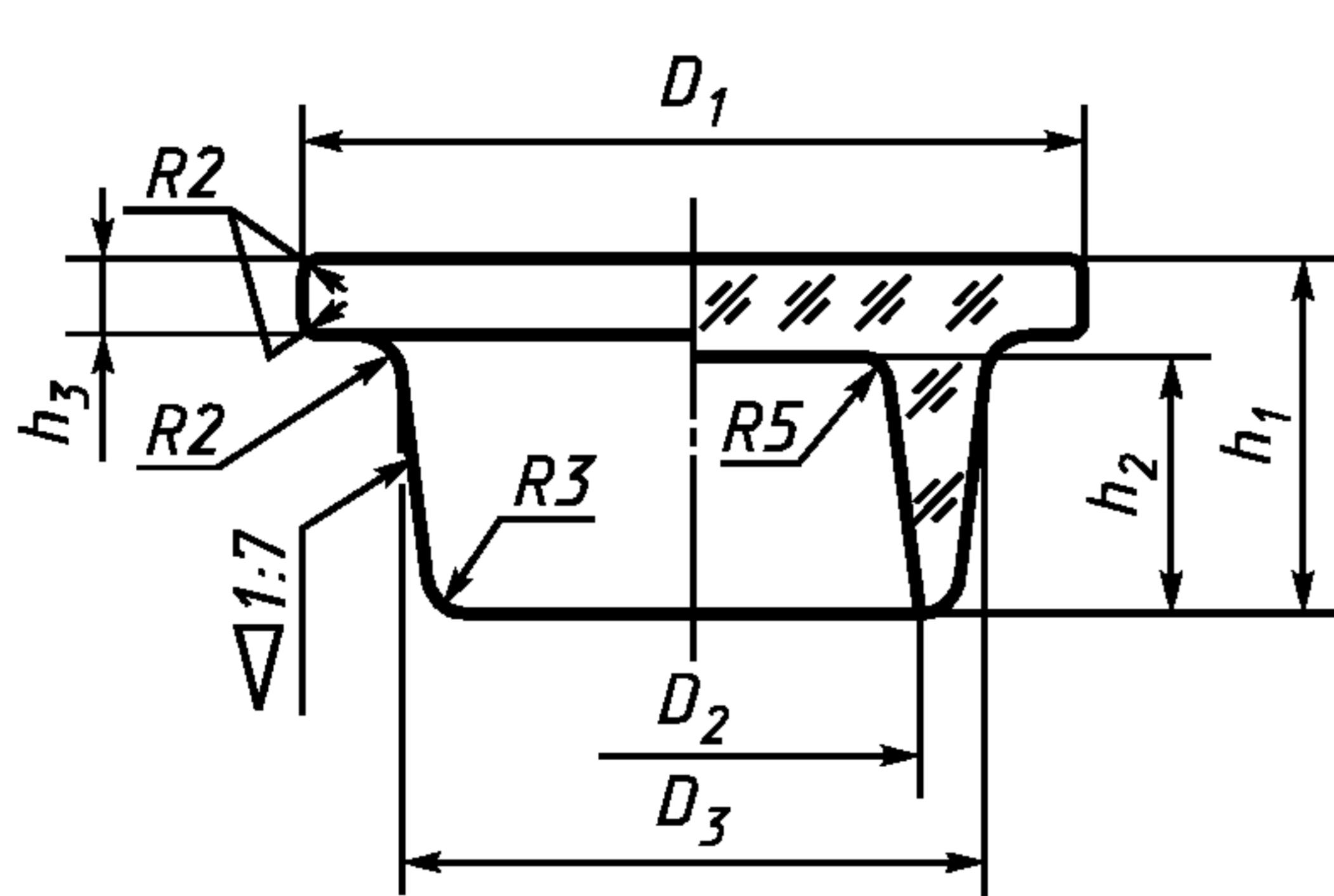
Контролируемый размер пробки, мм, —  $D_3$ .
