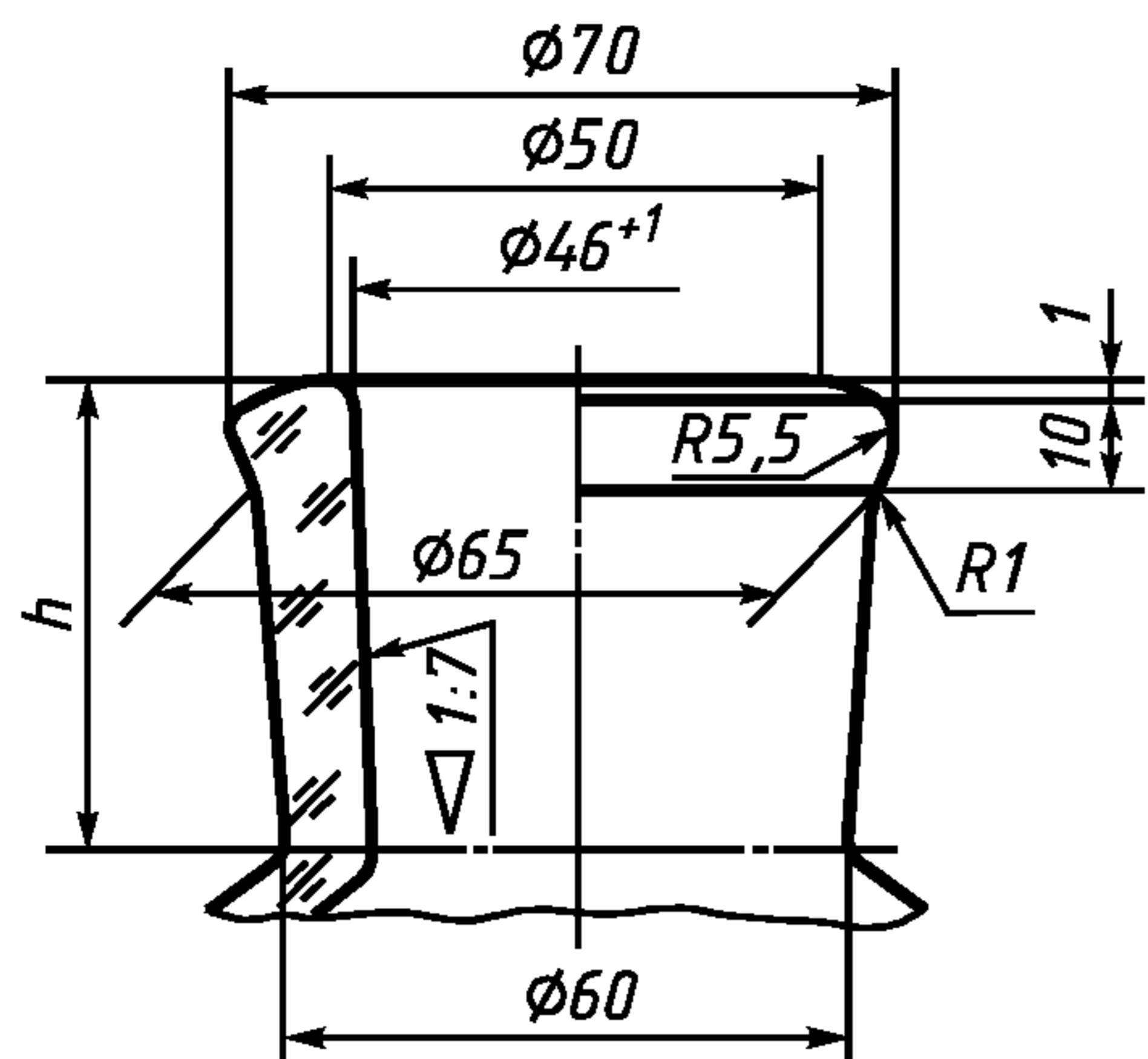
Контролируемый размер венчика горловины, мм, —  $\varnothing 46^{+1}$ .
