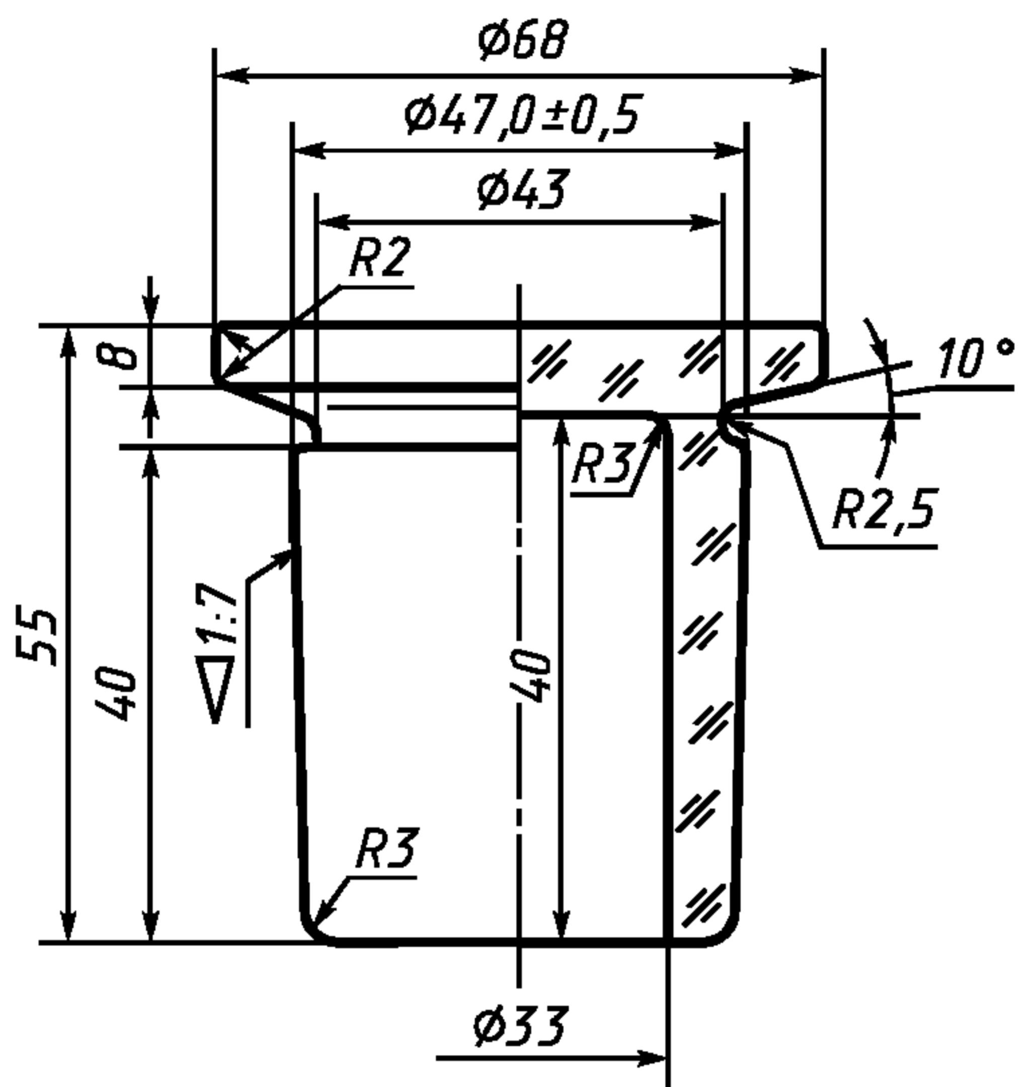
Контролируемый размер пробки, мм, —  $\varnothing 47,0 \pm 0,5$ .
