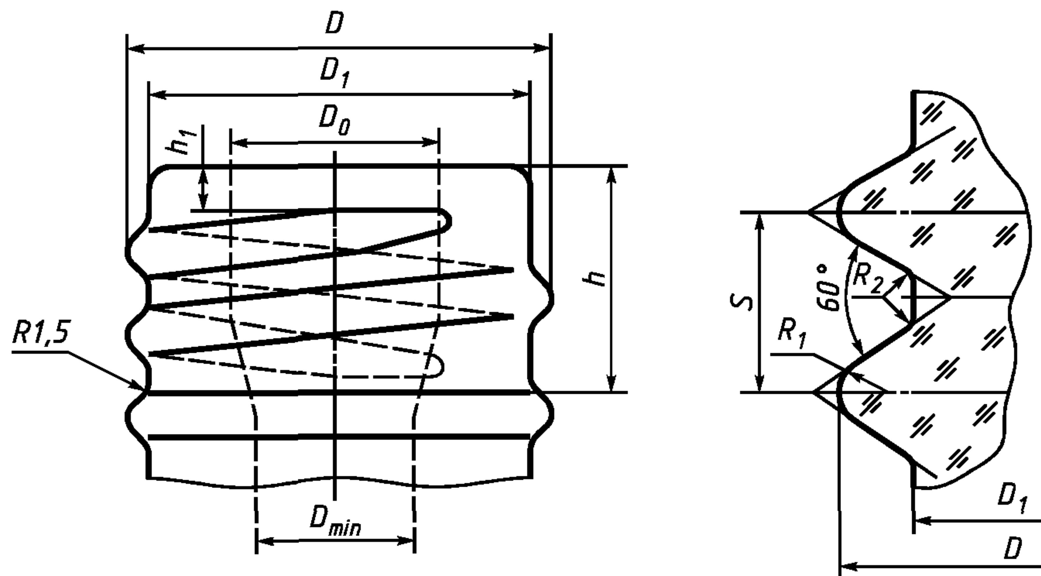
Контролируемые размеры венчика горловины, мм, —  $D$ ,  $D_1$  и  $D_0$ . Размер  $D_0$  обязателен до глубины 3 мм от торца венчика горловины.
