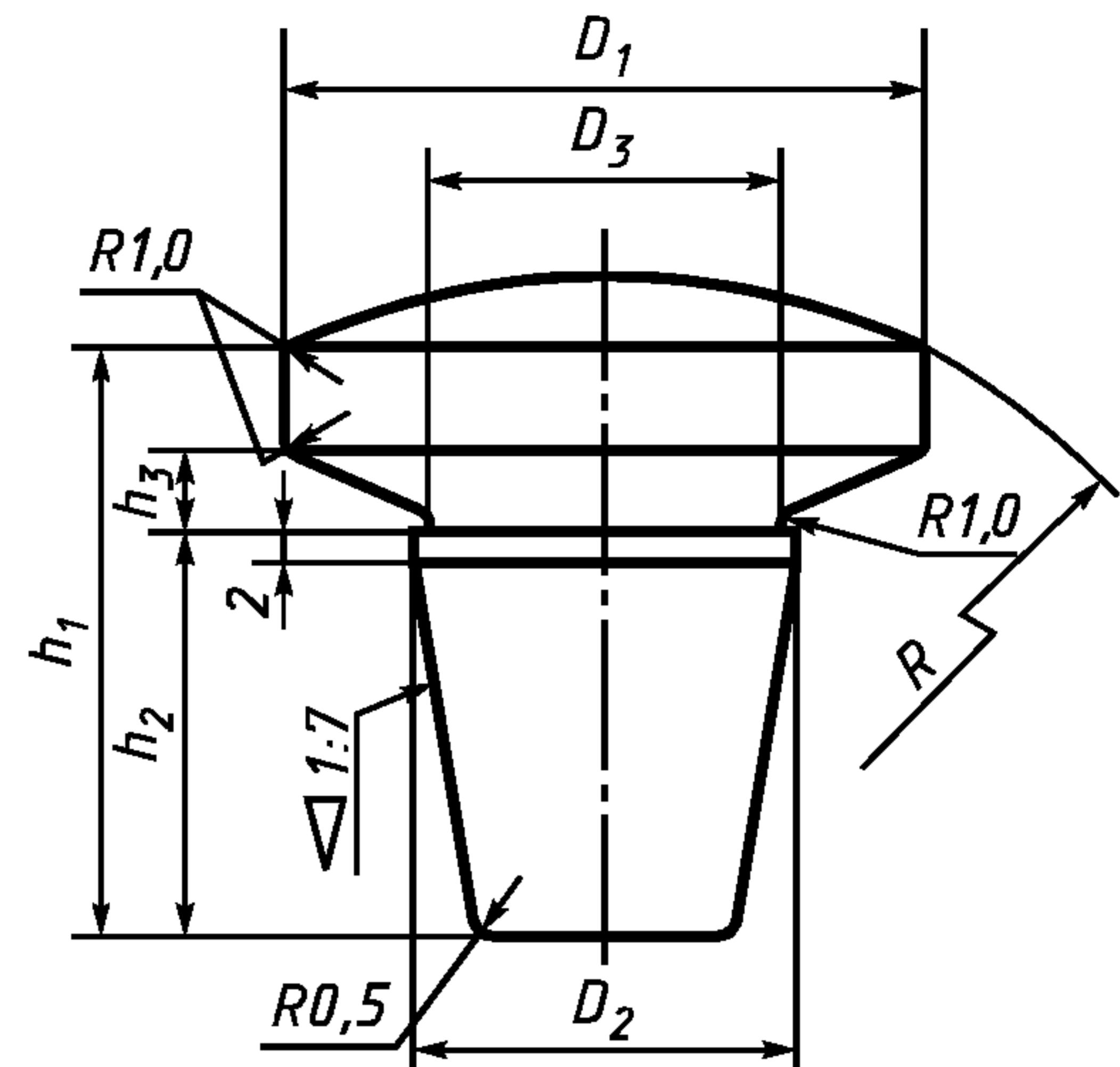
Контролируемый размер пробки, мм, —  $D_2$ .
