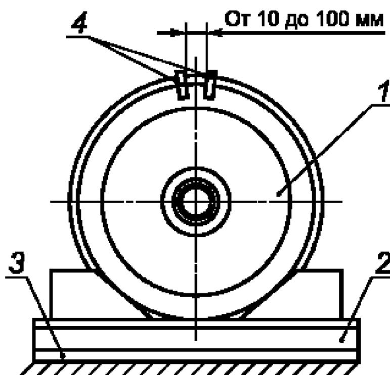
1 — колесная пара; 2 — основание; 3 — электроизоляционный материал;
