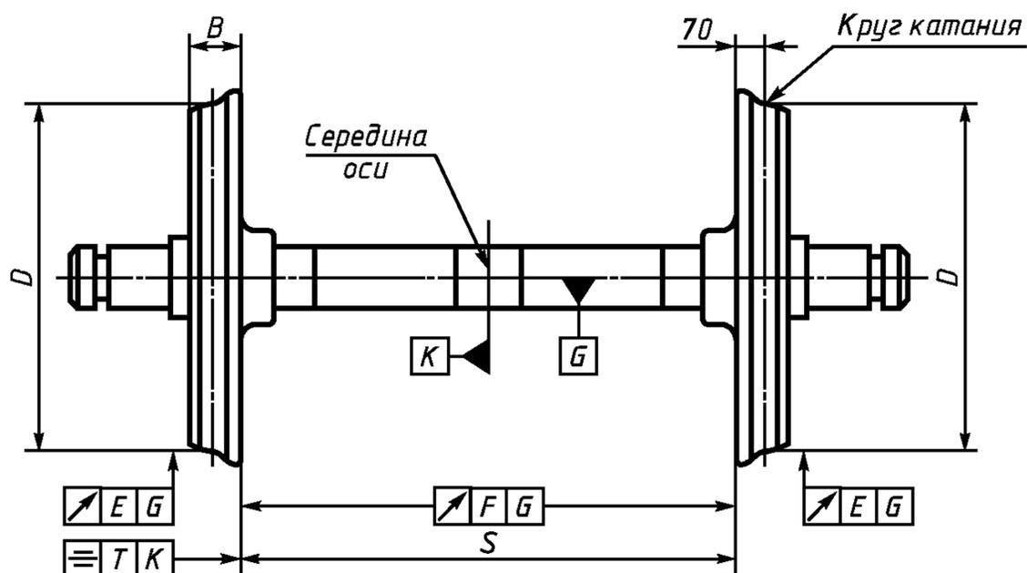
$S$  — расстояние между внутренними торцами (гранями) ободьев колес;  $B$  — ширина обода колеса;  $K$  — плоскость симметрии оси;  $T$  — допуск симметричности размера  $S$ ;  $D$  — диаметр колес по кругу катания;  $E$  — допуск радиального биения круга катания колеса;  $F$  — допуск торцевого биения внутреннего торца обода колеса;  $G$  — ось центров
