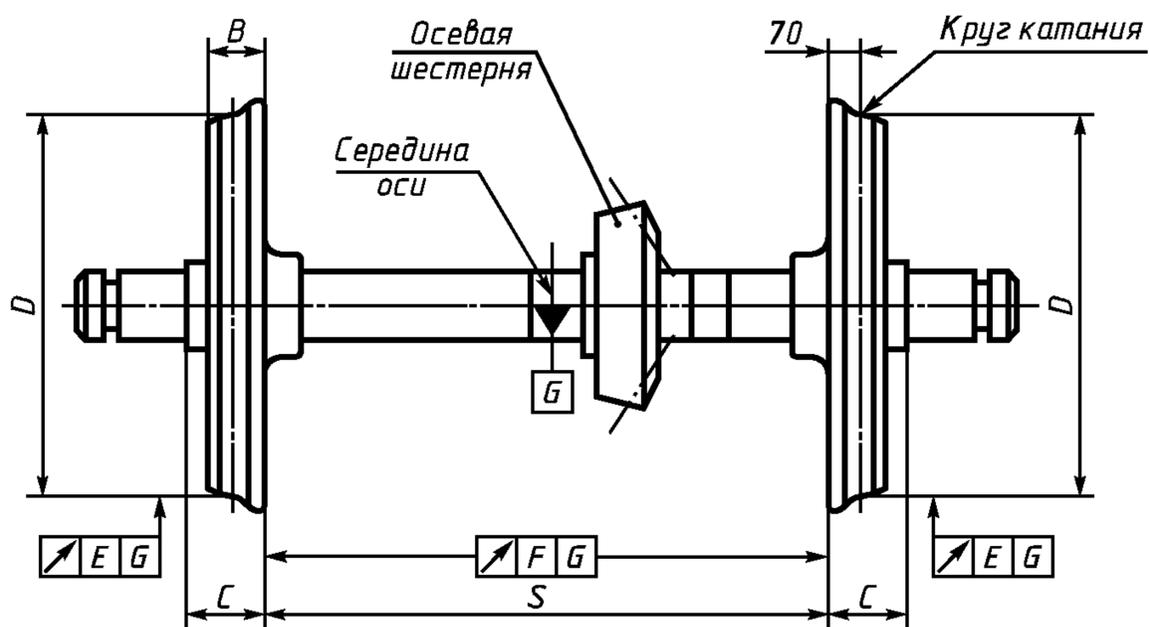
$S$  — расстояние между внутренними торцами (гранями) ободьев колес;  $B$  — ширина обода колеса;  $C$  — расстояние между упорным торцом предподступичной части оси и внутренним торцом обода колеса;  $D$  — диаметр колес по кругу катания;  $E$  — допуск радиального биения круга катания колеса;  $F$  — допуск торцевого биения внутреннего торца обода колеса;  $G$  — ось центров
