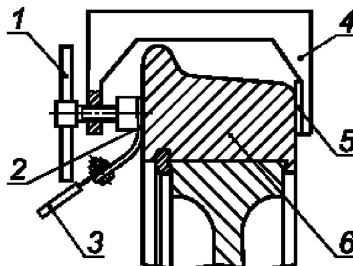
1 — упорный винт; 2 — медная планка; 3 — соединительный провод; 4 — скоба;
