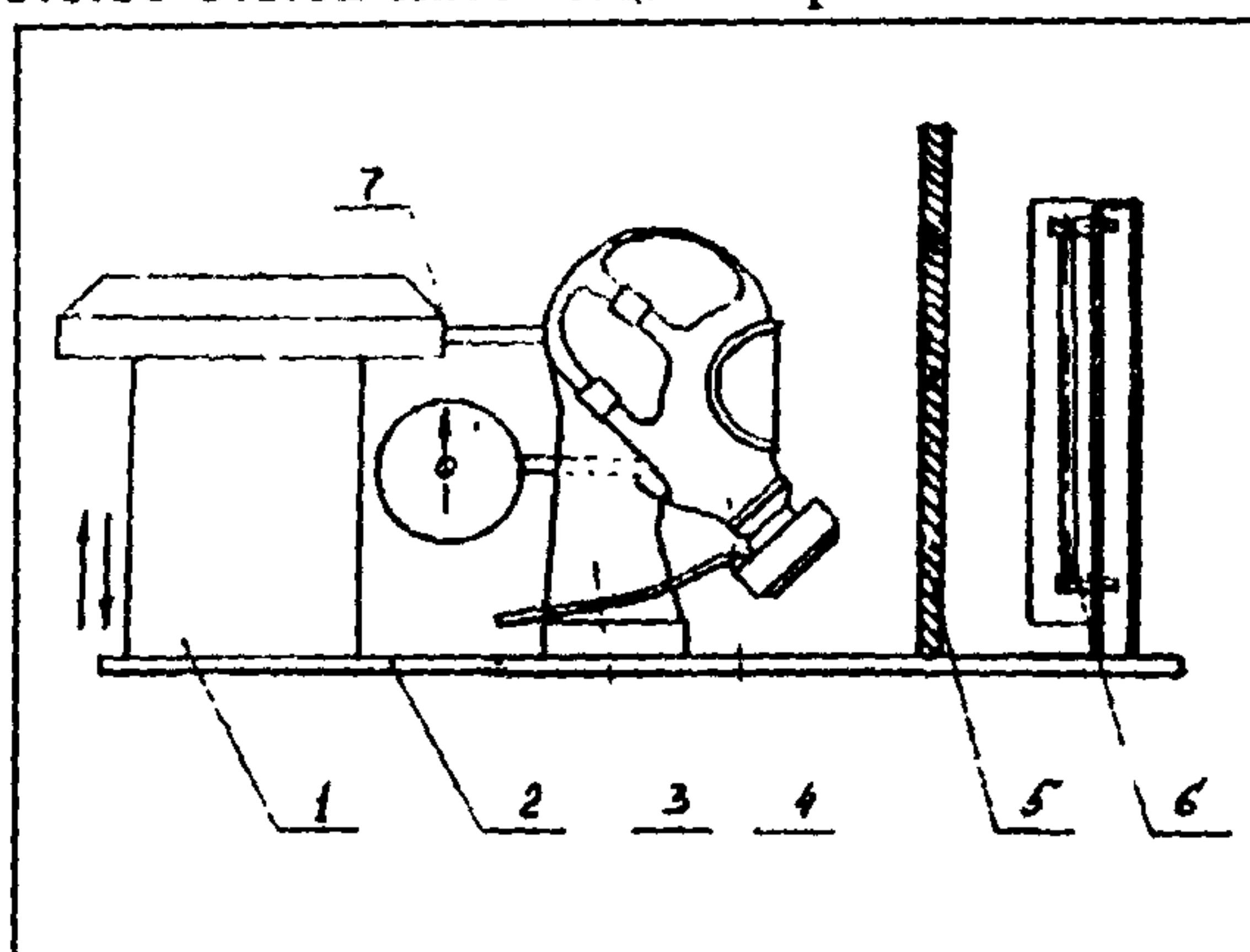
Рисунок 2. Схема установки по определению устойчивости капюшона (лицевой части) самоспасателя к воздействию теплового потока:
