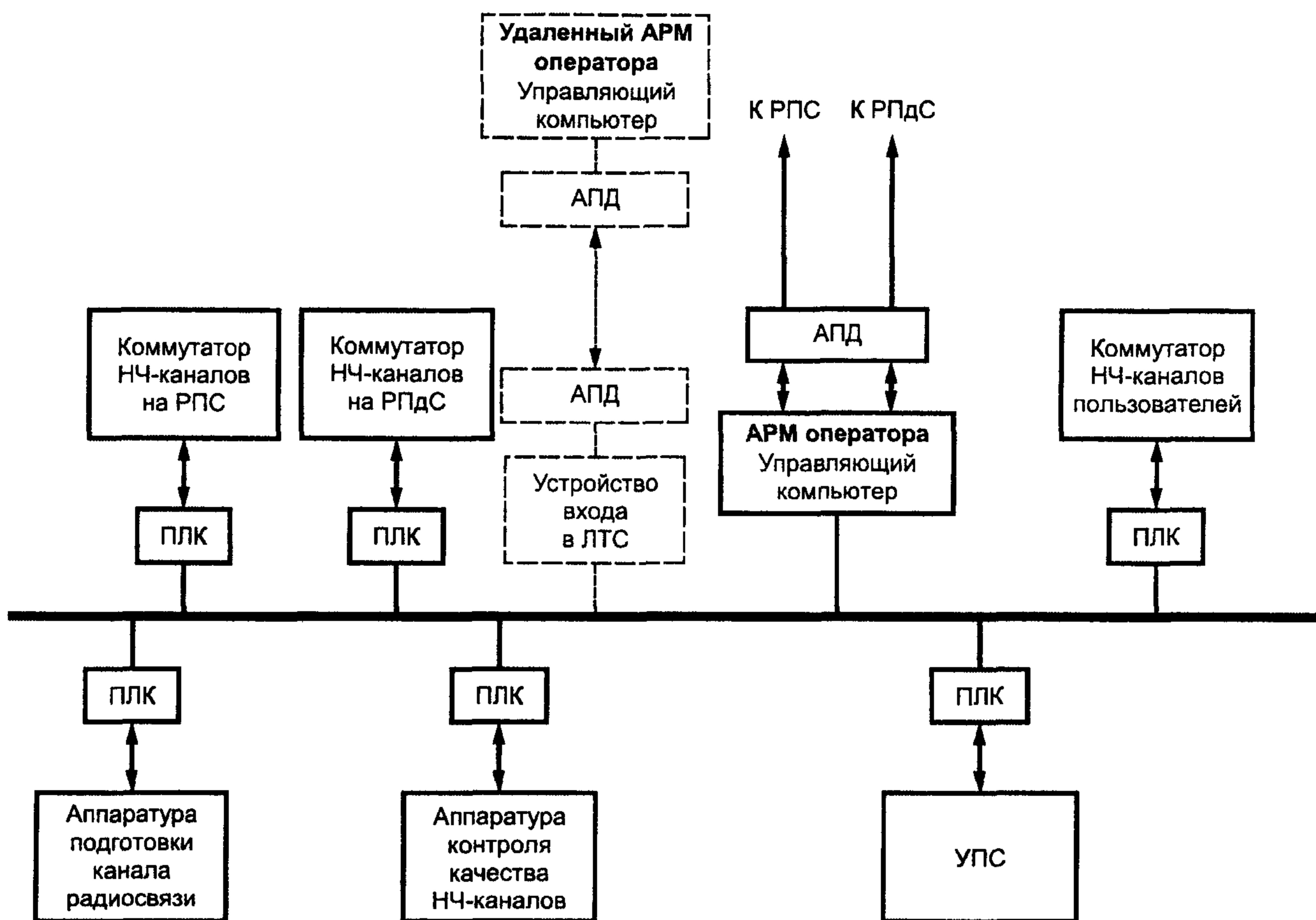
Рисунок 1 — Структурная схема ЛТС на уровне ЦУ
