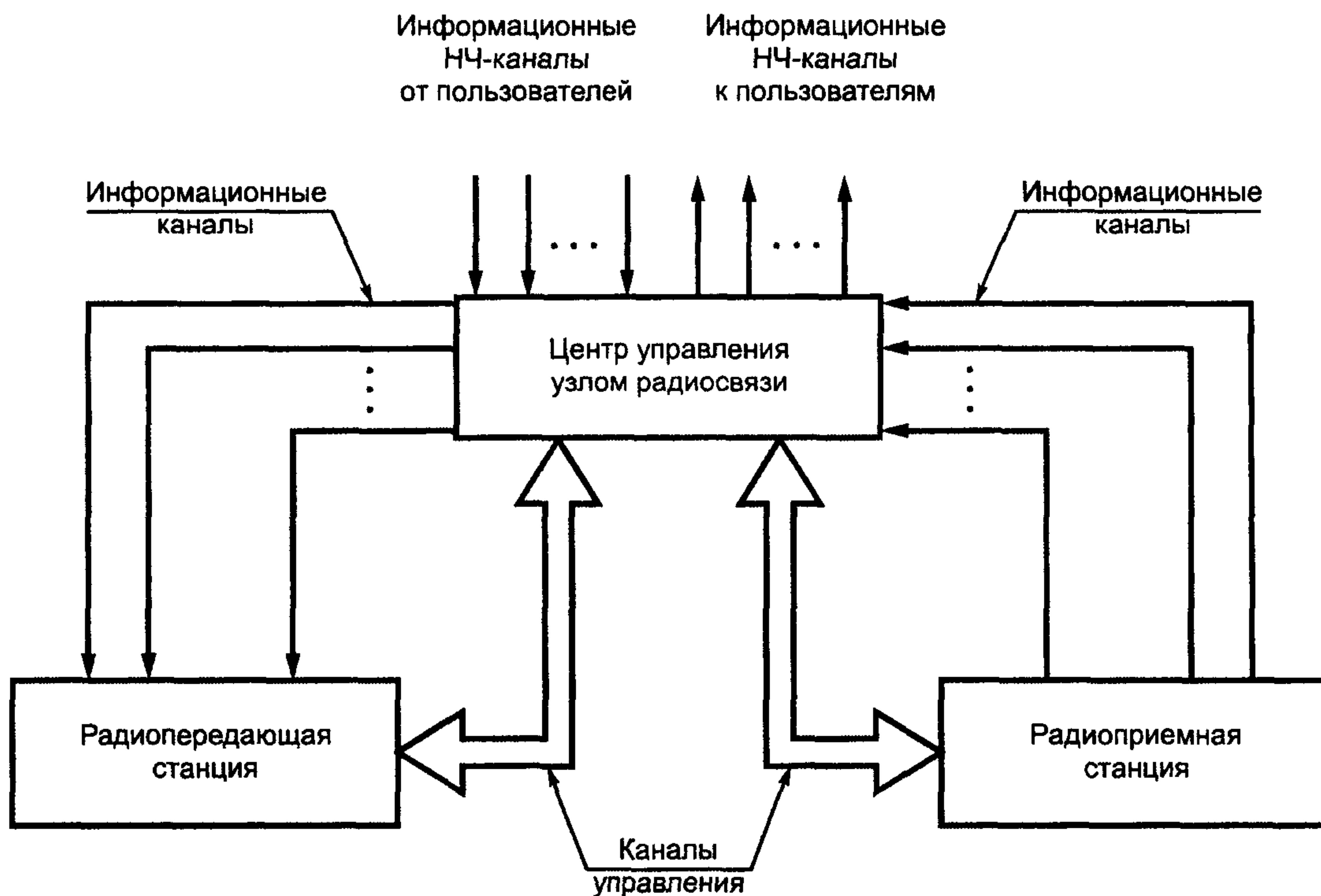
Рисунок А.1 — Упрощенная структурная схема УРС
