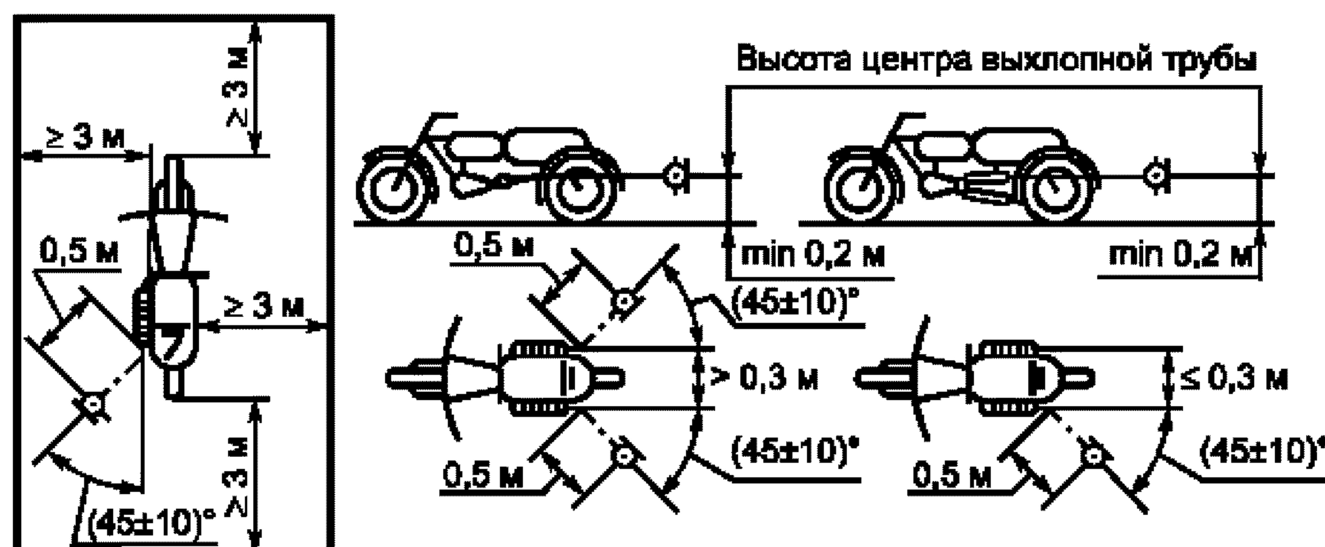
Рисунок 3.3 — Испытание неподвижно стоящего мотоцикла
