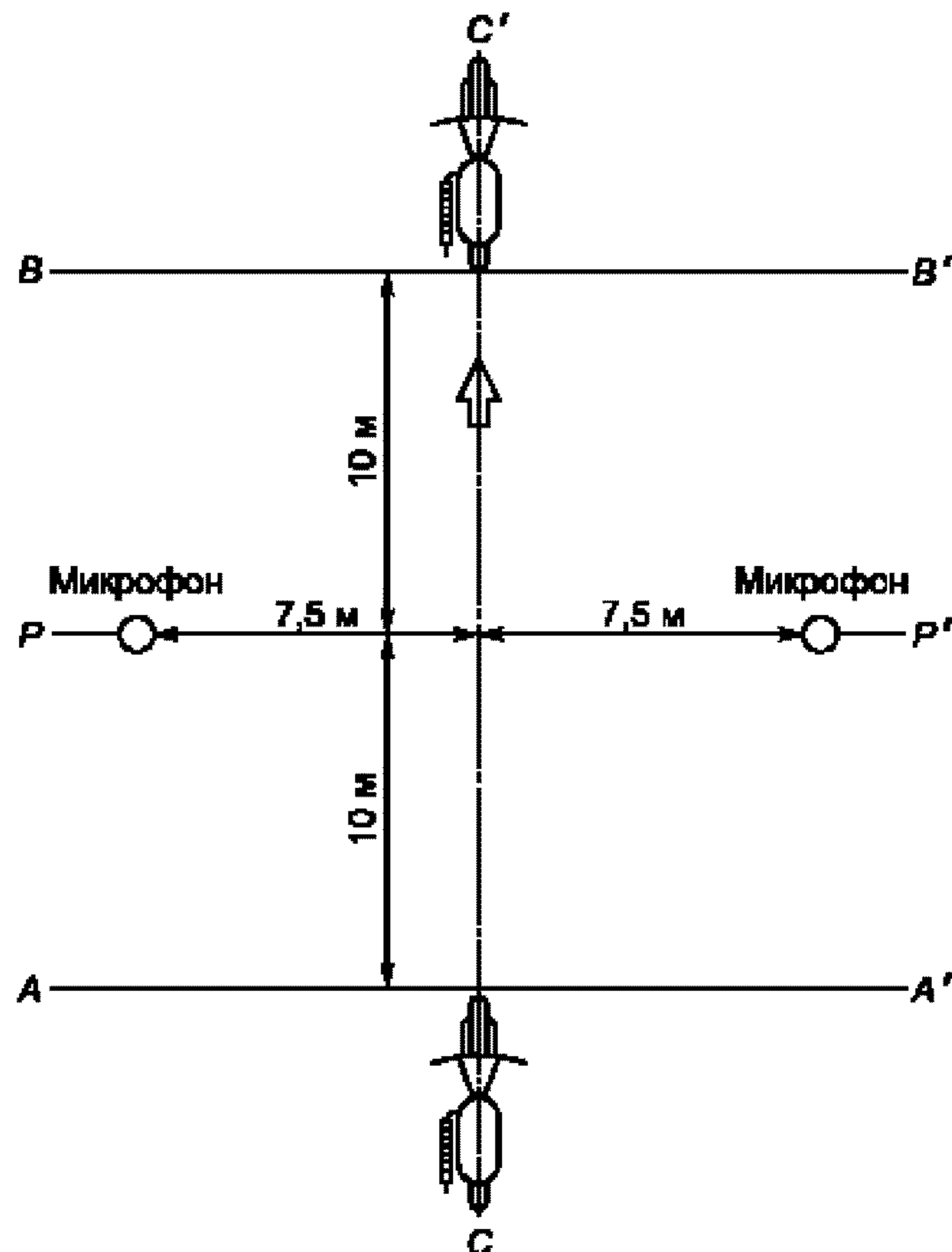
Рисунок 3.2 — Испытание мотоцикла в движении
