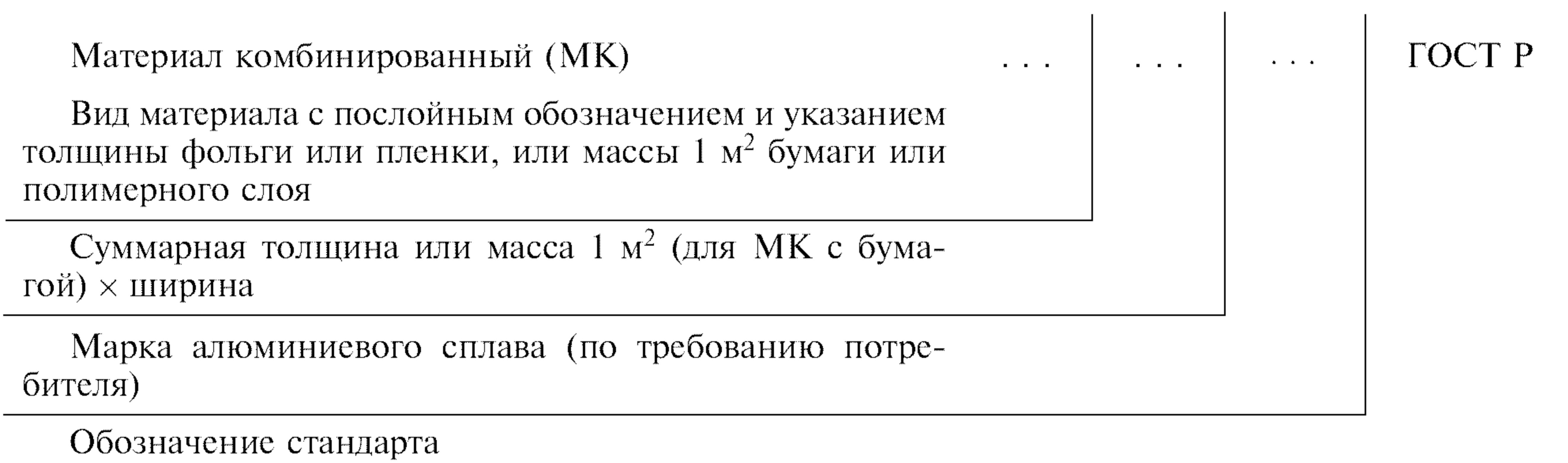
Обозначение вида материала комбинированного начинается с наружного слоя и заканчивается слоем, контактирующим с упаковываемым продуктом.
