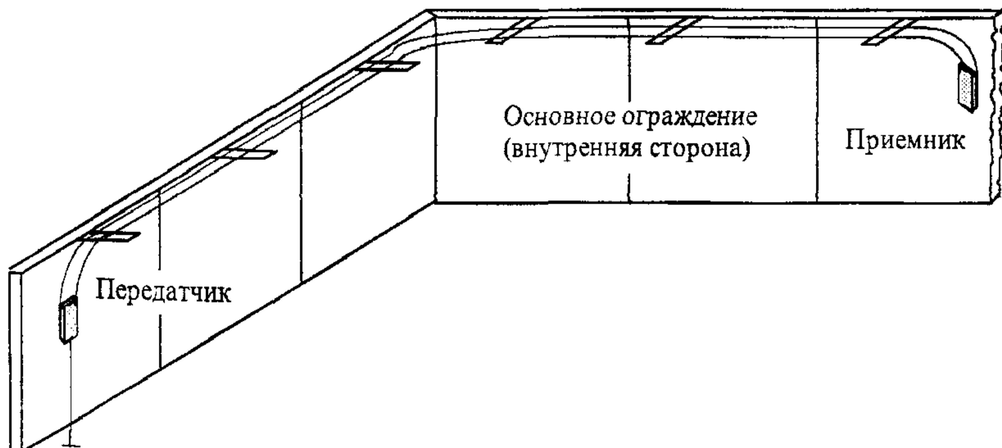
*Рисунок 5 - Вариант блокировки “коzyрька” основного ограждения извещателем “Уран-1М”*
