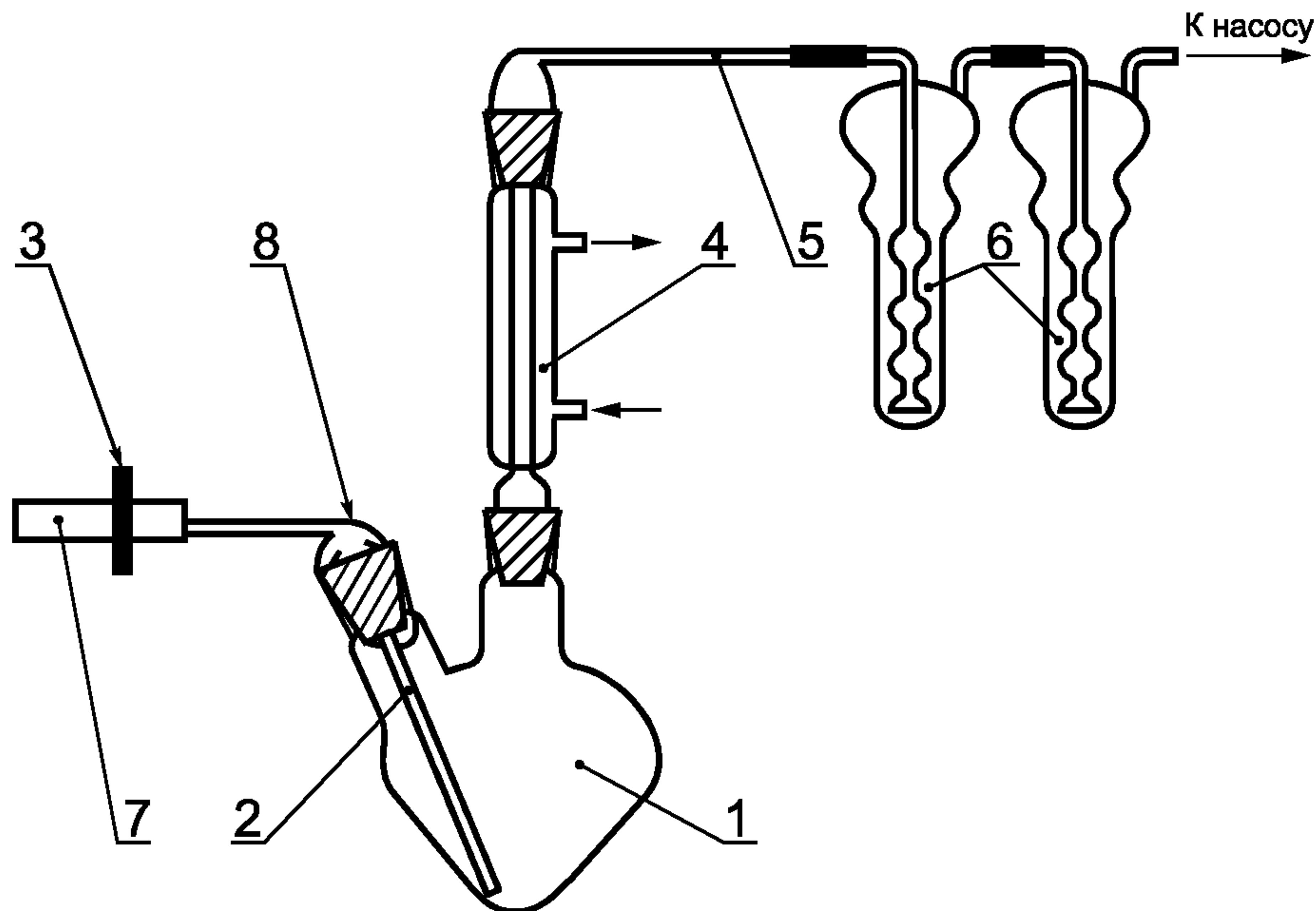
1 — колба для перегонки; 2 — капилляр; 3 — винтовой зажим; 4 — холодильник; 5 — соединительная трубка (длина 100 — 150 мм); 6 — поглотительный сосуд; 7 — трубка резиновая или силиконовая (диаметр равен диаметру стеклянной трубы керна); 8 — керн КИО
